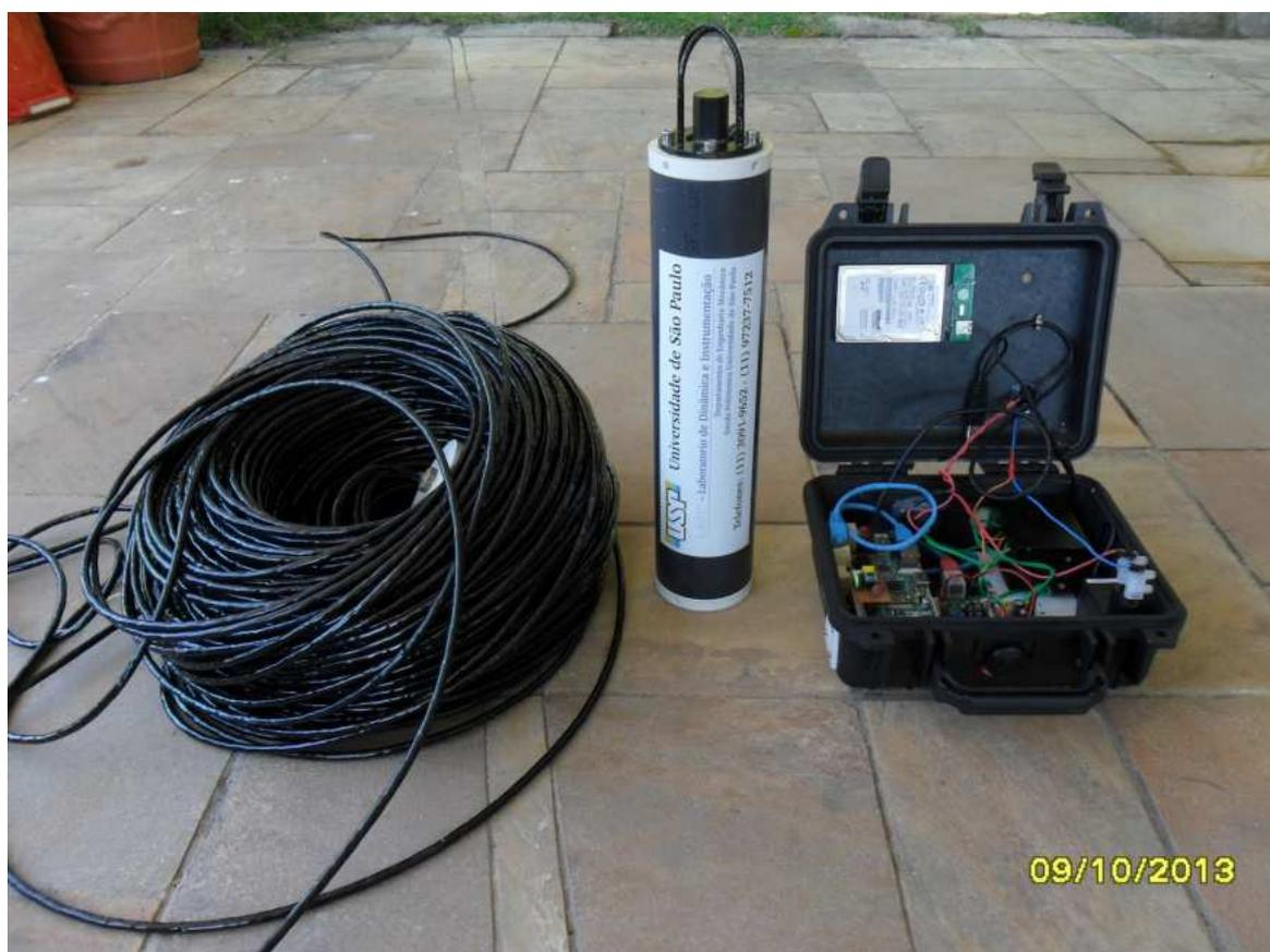
**Figura III.2.2** - OceanBase, equipamento cabeado para monitoramento permanente e em tempo real.
