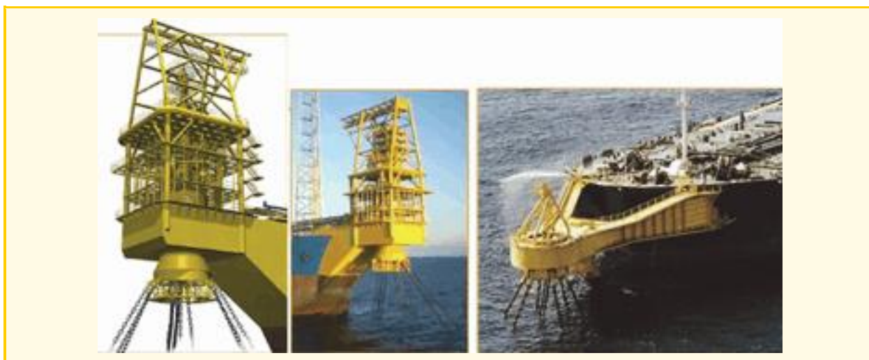
Figura 5 – Exemplo de sistema de ancoragem
