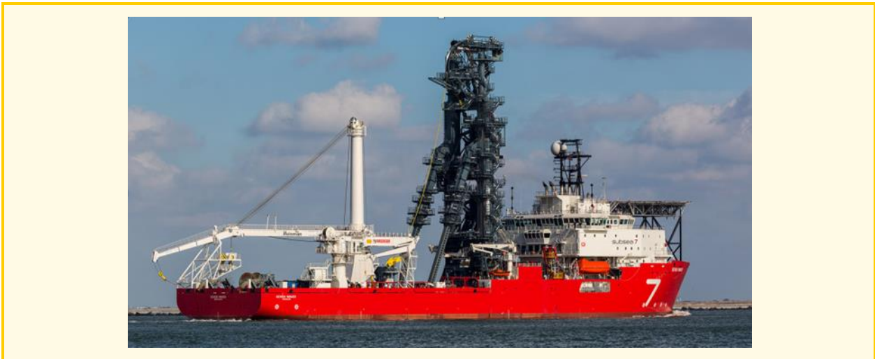
Figura 3 – Exemplo de embarcação de apoio às atividades de instalação: barco de lançamento de linhas
