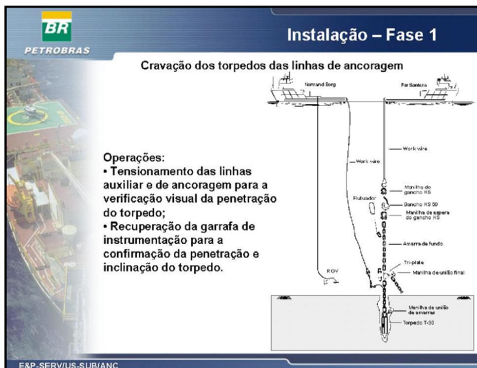
**Figura II.2.4.2- 4 - Fase 1 - Cravação dos torpedos das linhas de ancoragem.**
