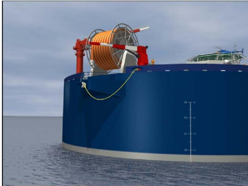
**Figura 8.4- 2 - Carretel e Mangote para transferência de óleo.**
