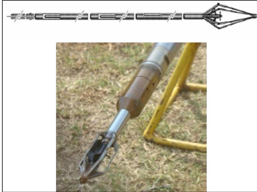
**Figura II.2.4.8.2.2-4** - Exemplos de ferramentas de perfilagem.
