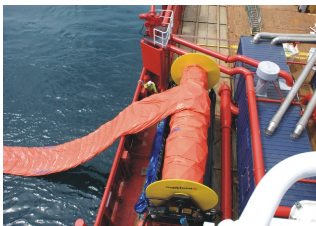
Figura 41 – Lançamento de barreira a partir de seu carretel. Fonte: PETROBRAS
