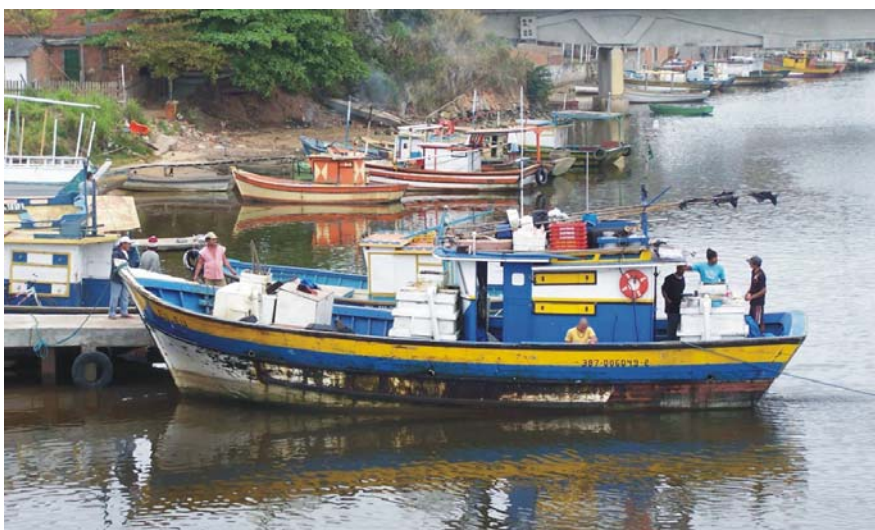
Figura 32 – Embarcação com tinas para isca viva e petrechos para pesca com espinhel em Cabo Frio.
