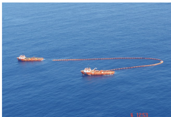
Figura 40 – Formação para contenção de óleo no mar. Fonte: PETROBRAS
