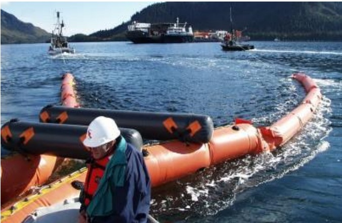
Fig. 38: Girando o sistema em alta velocidade de reboque (Imagem do NOFI Current Buster 4)
