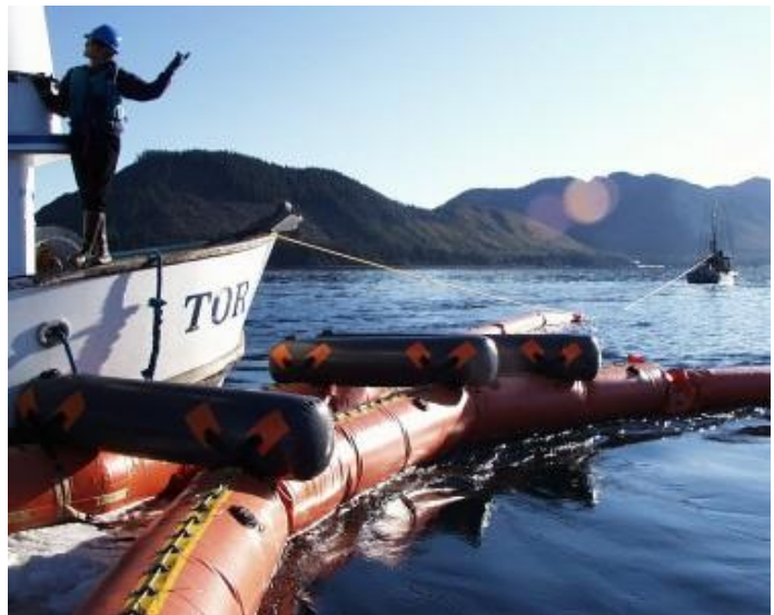
Fig. 36: A foto de atracação da proa da embarcação de bombeamento ao ponto de conexão entre a carreta e o cabo de reboque. (Imagem do NOFI Current Buster 4)
