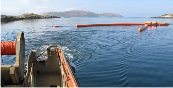
Fig. A11: Com a ajuda de um gancho, o recolhimento de um dos braços de reboque é ajustado para que o NOFI Current Buster mantenha uma boa forma durante a trilha.
