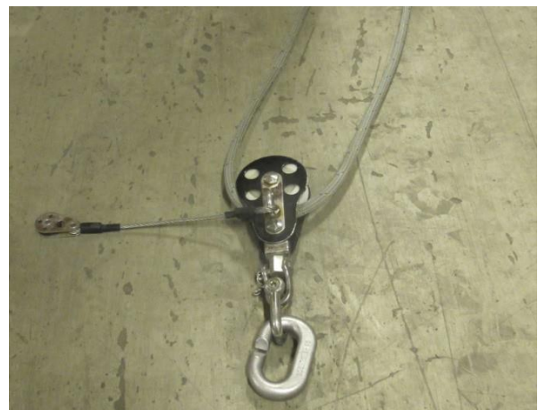
Fig. A06: Visão detalhada do tirante do boomvane com o bloco e gancho G
