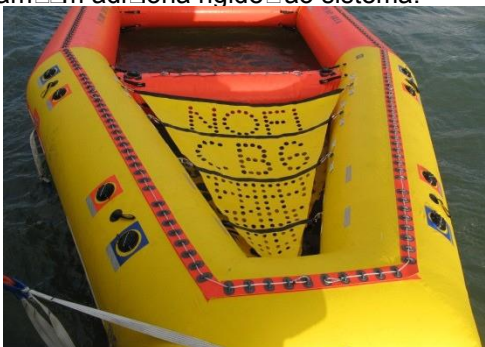
Fig. 17: Sistema de proteção contra a entrada de água e amortecedor de ondas na boca.
