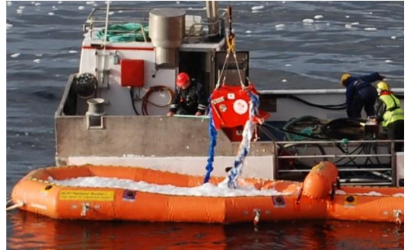
Fig. 34: O coletor de óleo skimmer tira o óleo da terna montando no separador (Imagem do NOFI Current Buster 2)
