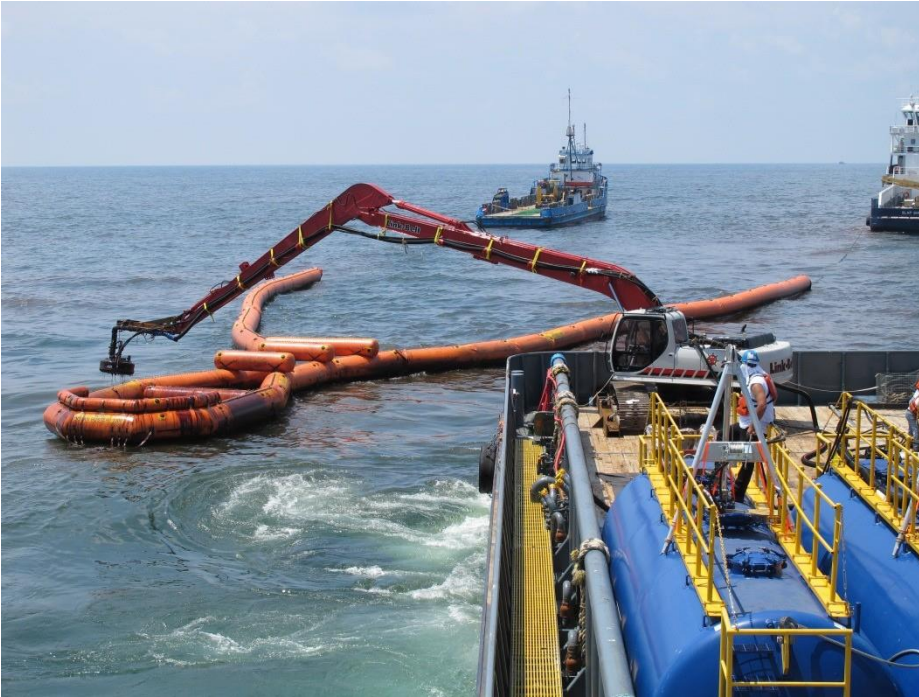
Fig.37: Separadora com o sistema de carregando em operação Current Buster 8 durante o derramamento de Maõndo em 2011.
