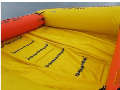
Fig. 8: Válvulas de drenagem
