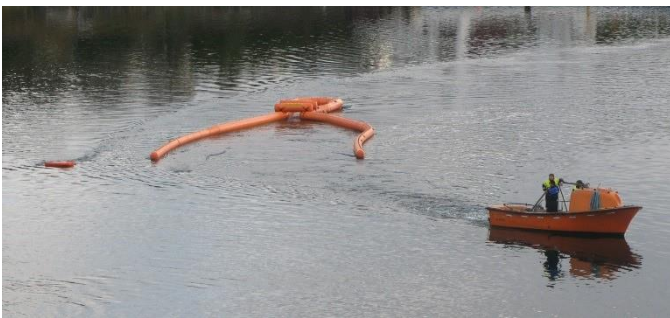
Fig. A10: Girar a bombordo. Guia de corrente de contenção de bombordo deve dobrar um pouco enquanto o giro está em andamento.
