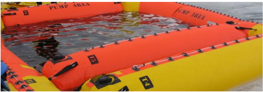
Fig. 25: Área de bombeamento de 3 x 3 m no separador
