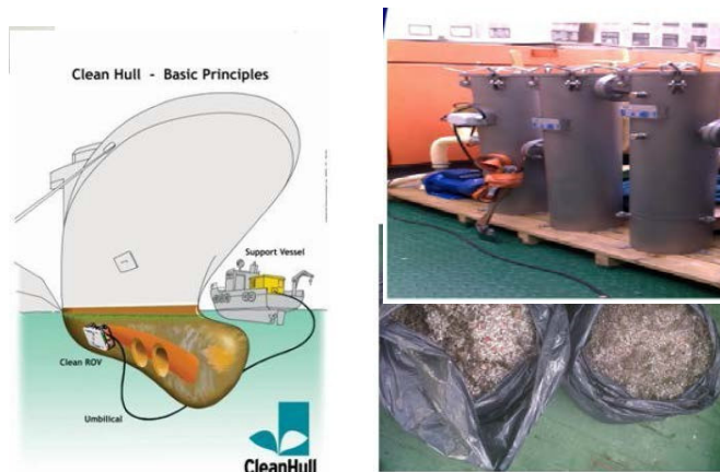
Figura 6: Esquema da infraestrutura da remoção com coleta de resíduos (Fonte: Retirado do website de Cleanhull, 2019).
