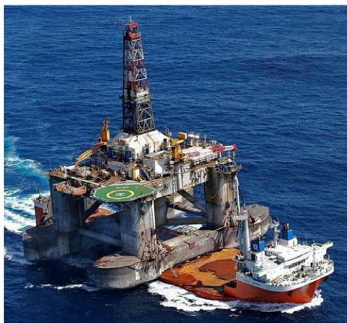
Figura 8: Navio-lift transportando uma plataforma para área costeira (Fonte: MAF Biosecurity New Zeland, 2009).
