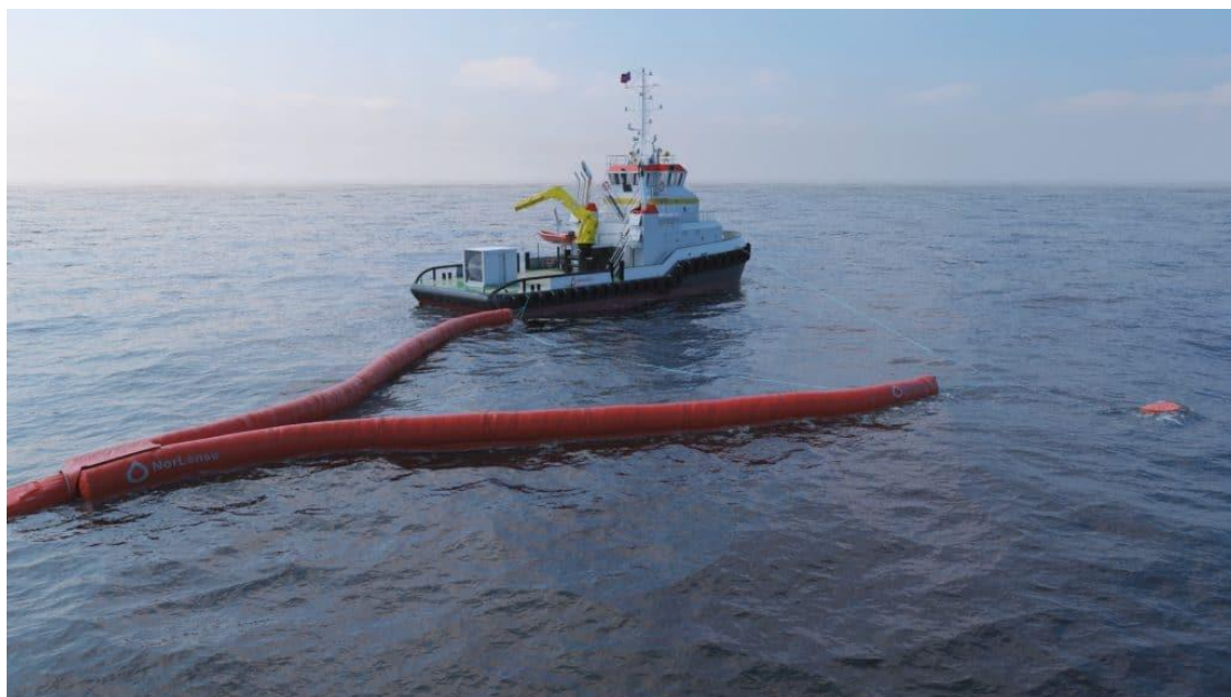
Figura 12: Oil Trawl , mostrando a barreira aberta pela paravana e o pequeno container que abriga o sistema (Fonte: DD3D STUDIO, 2018).
