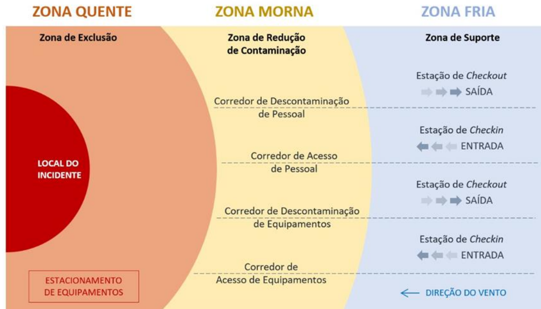
Figura 7: Representação esquemática dos locais de descontaminação (situados na “Zona Morna”) no zoneamento das áreas de resposta à emergência (Fonte: Adaptado de NUKA, 2014).
