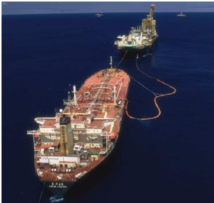
Figura II.2.4.2.2.1-11 – Exemplo de operação de transferência de óleo
