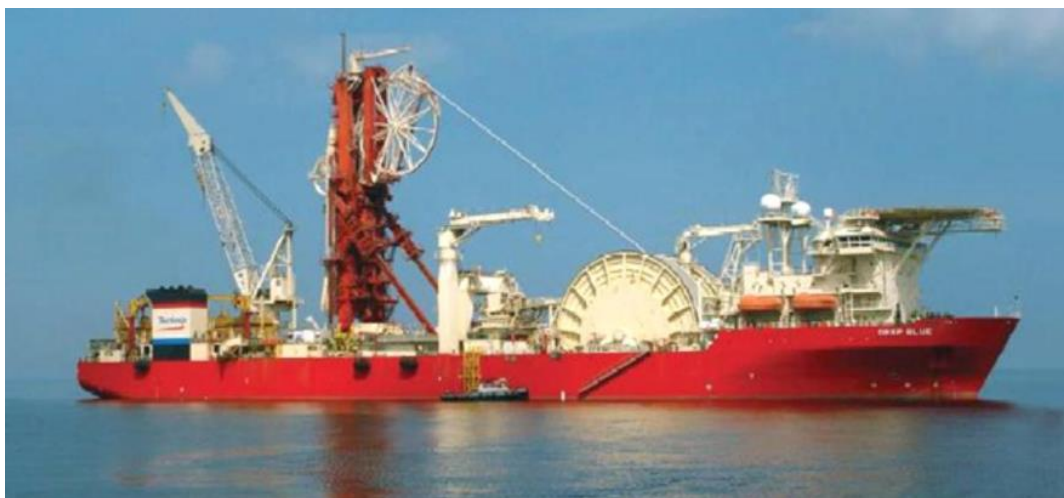
Figura II.2.4.6.3-5 – Exemplo de embarcação Método Reel-Lay
