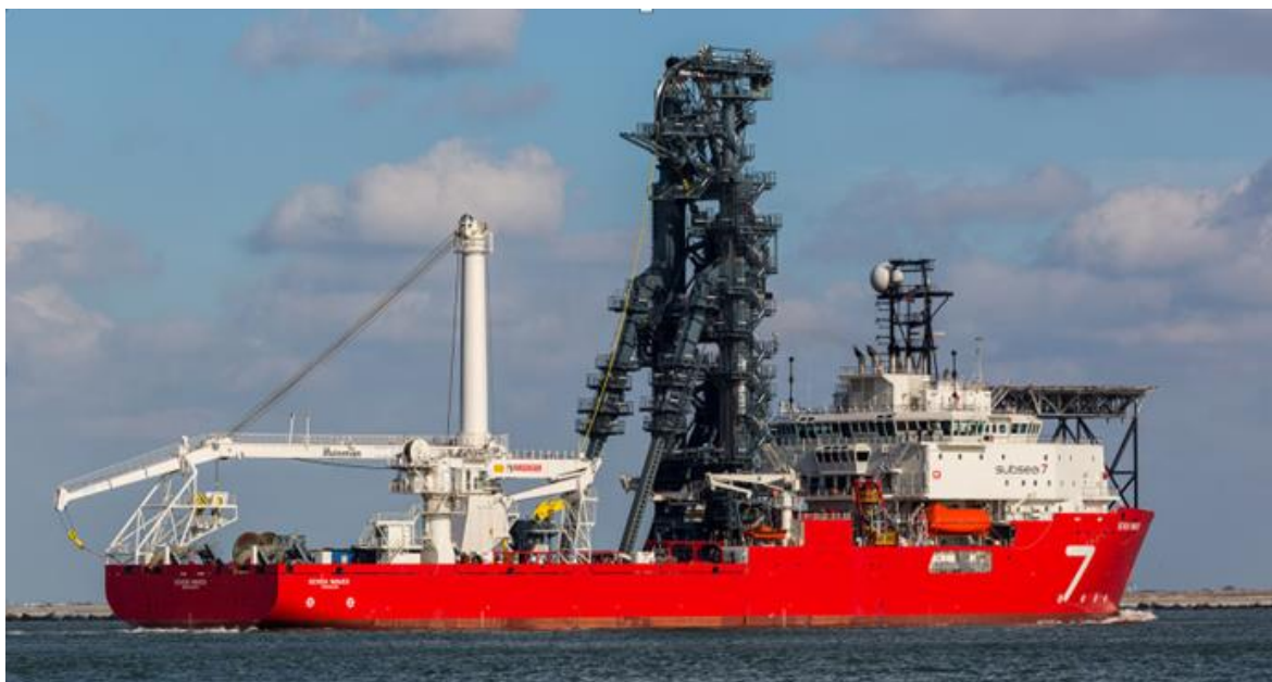
Figura II.2.4.6.3-1 – Exemplo de Navio Lançador de Linha - PLSV (Pipe Laying Support Vessel).
