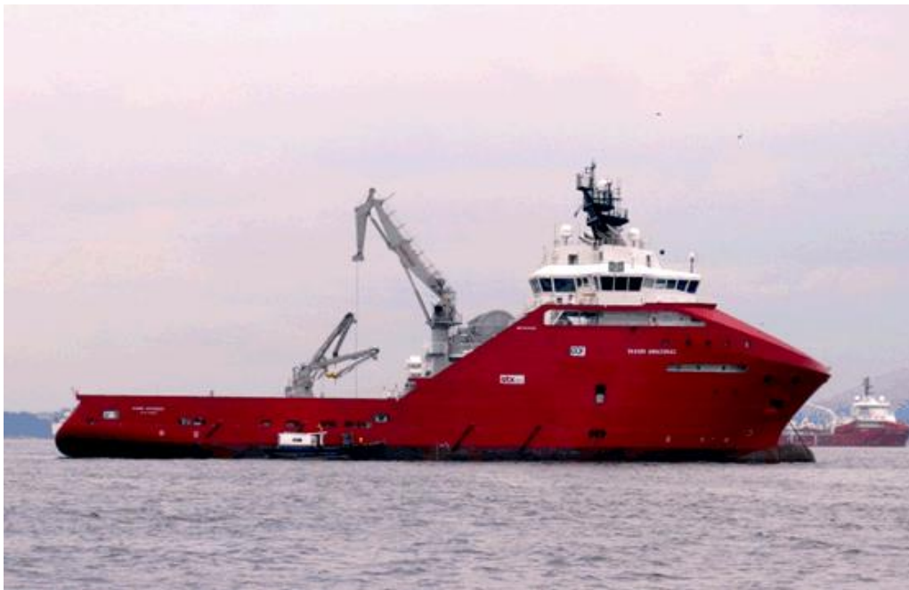
Figura II.2.4.6.1-3 – Exemplo de navio AHTS (Anchor Handling Tug Supply) que poderá ser utilizado na instalação da ancoragem dos FPSOs.
