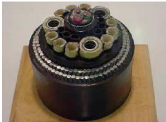
Figura II.2.4.4.2-2 – Vista da seção transversal de um Umbilical Eletro-Hidráulico.
