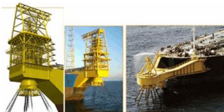
Figura II.2.4.3.1.1-1 – Exemplo de ancoragem Turret Mooring .
