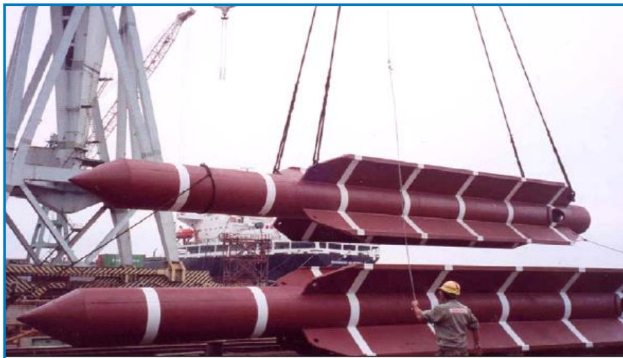
Figura II.2.4.6.1-2 – Estaca do tipo torpedo utilizada em ancoragem.
