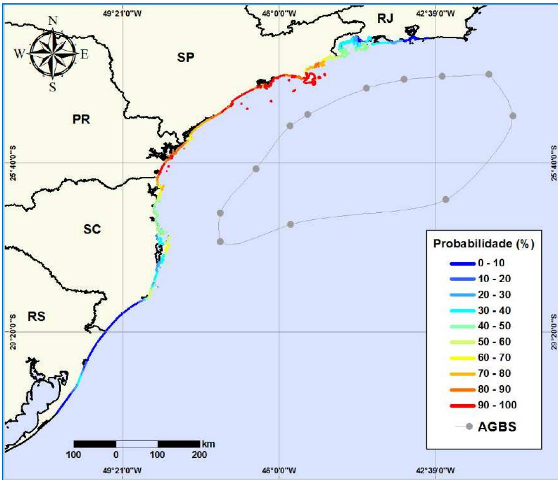
**Figura III-5** - Probabilidade de toque de óleo na linha de costa para a AGBS, a partir de simulações de derrame de óleo de pior caso durante os meses de inverno (junho a agosto). (ASA,2010)
