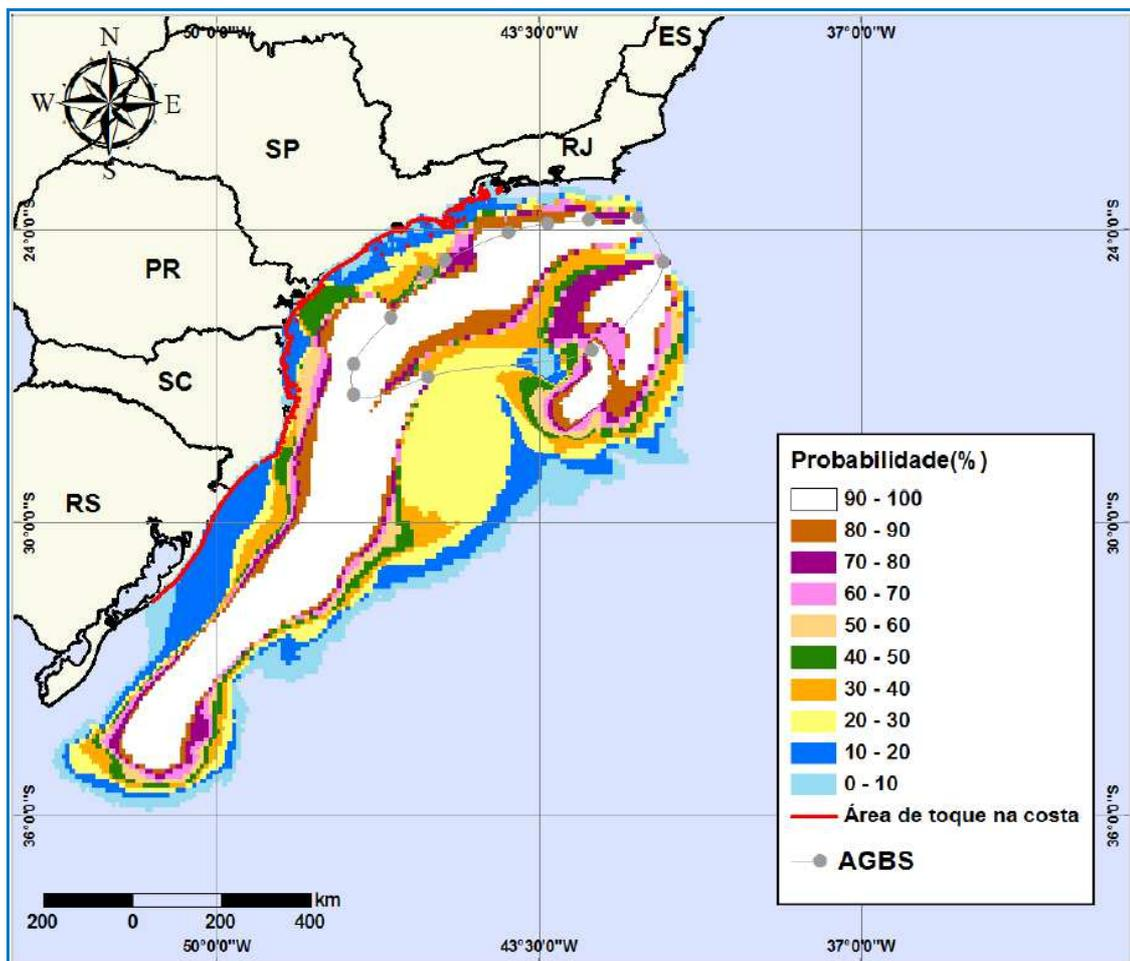
**Figura III-2** - Área total com probabilidade de presença de óleo na água e toque na linha de costa para a AGBS, a partir de simulações de derrame de óleo de pior caso durante os meses de verão (janeiro a março). (ASA,2010)
