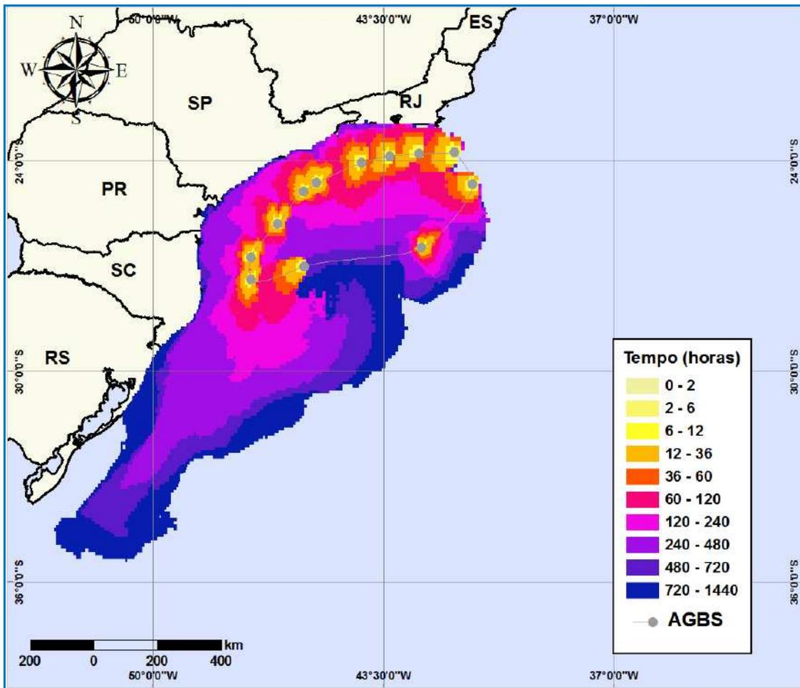
**Figura III-7** - Tempo de deslocamento de óleo na água para a AGBS, a partir de simulações de derrame de óleo de pior caso durante os meses de inverno (junho a agosto). (ASA,2010)
