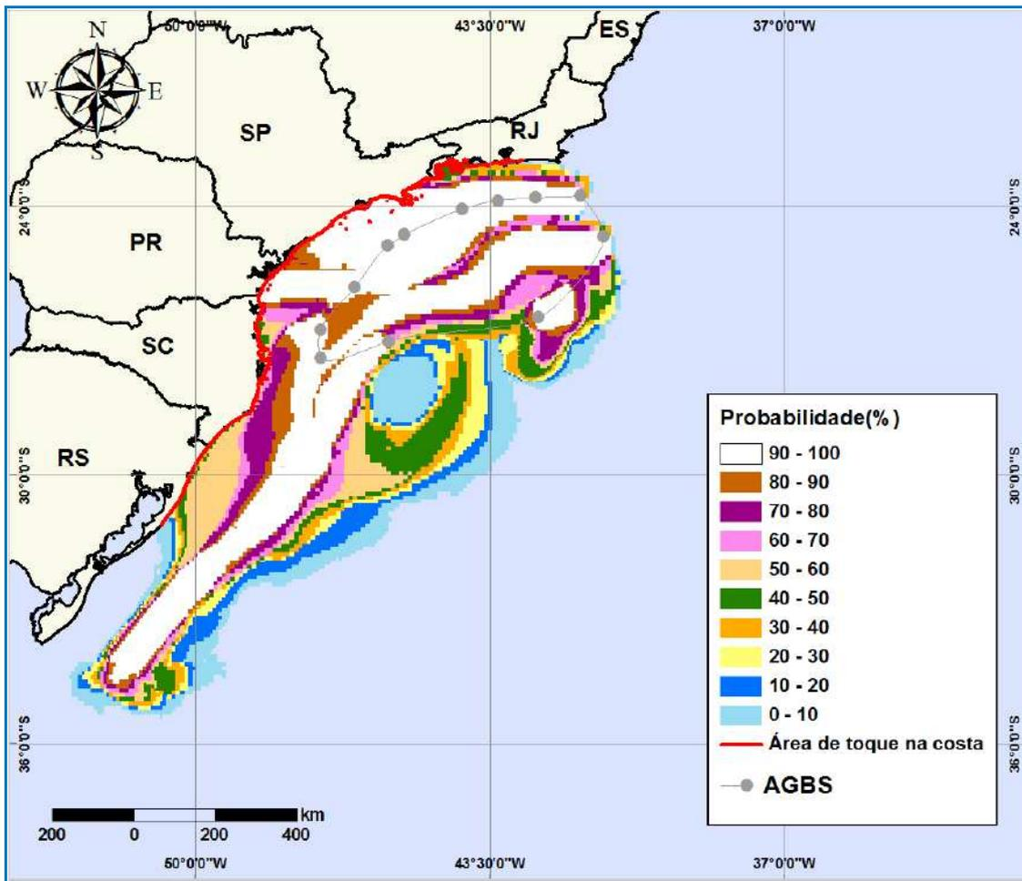
**Figura III-3** - Área total com probabilidade de presença de óleo na água e toque na linha de costa para a AGBS, a partir de simulações de derrame de óleo de pior caso durante os meses de inverno (junho a agosto). (ASA,2010)
