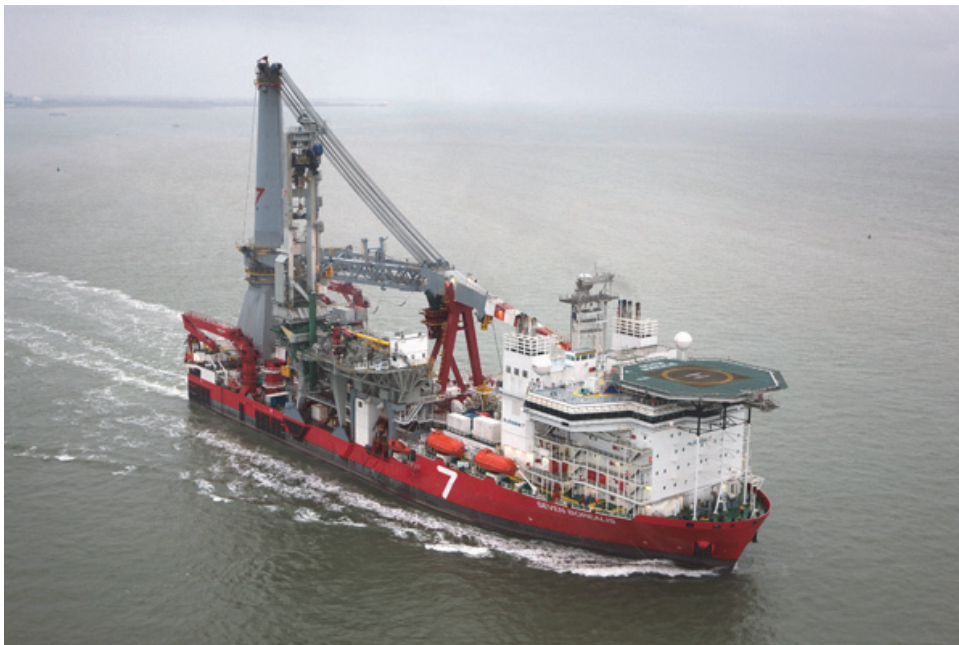
Figura II.2.4.9.3-1 - Exemplo de Navio Lançador de Linha - PLSV (Pipe Laying Vessel)
