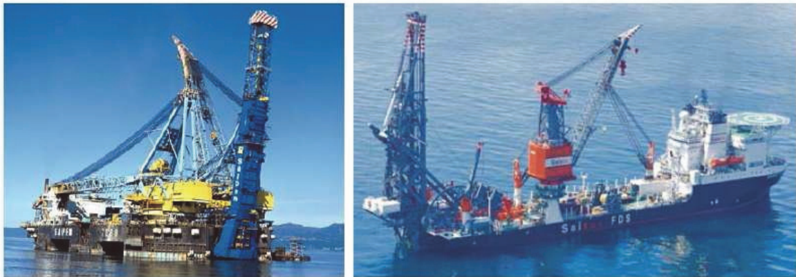
Figura II.2.4.9.4.2-11 - Embarcações típicas de lançamento em J-Lay, tipo Semi-Sub e Navio.
