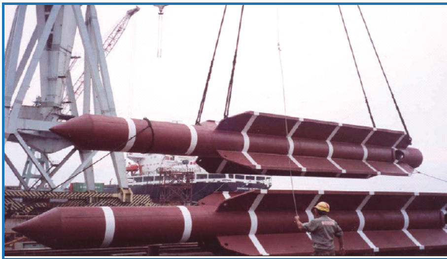
Figura II.2.4.9.1.1-1 - Estaca do tipo torpedo utilizada em ancoragem.
