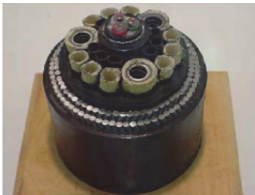
Figura II.2.4.6.2-1 - Vista da seção transversal de um Umbilical Eletro-Hidráulico.
