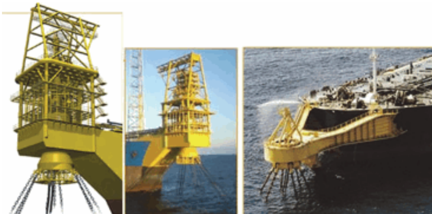
Figura II.2.4.3.1.1.1-1 - Exemplo de ancoragem Turret Mooring
