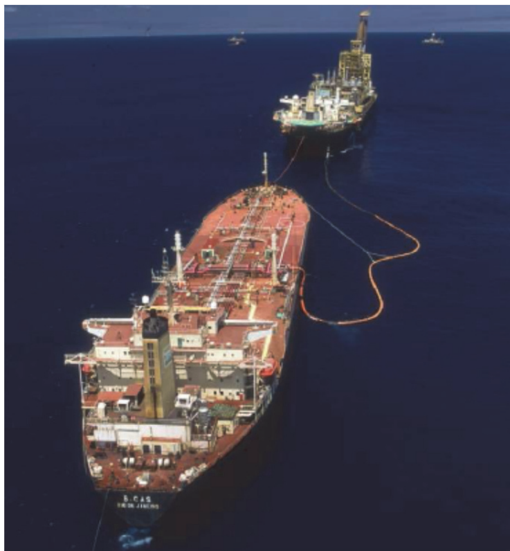
Figura II.2.4.2.2.2-1 - Exemplo de operação de transferência de óleo
