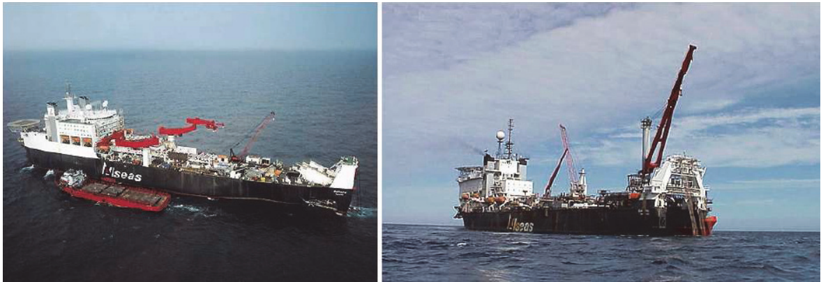
Figura II.2.4.9.4.1-9 - Embarcação típica de lançamento S-Lay, tipo navio
