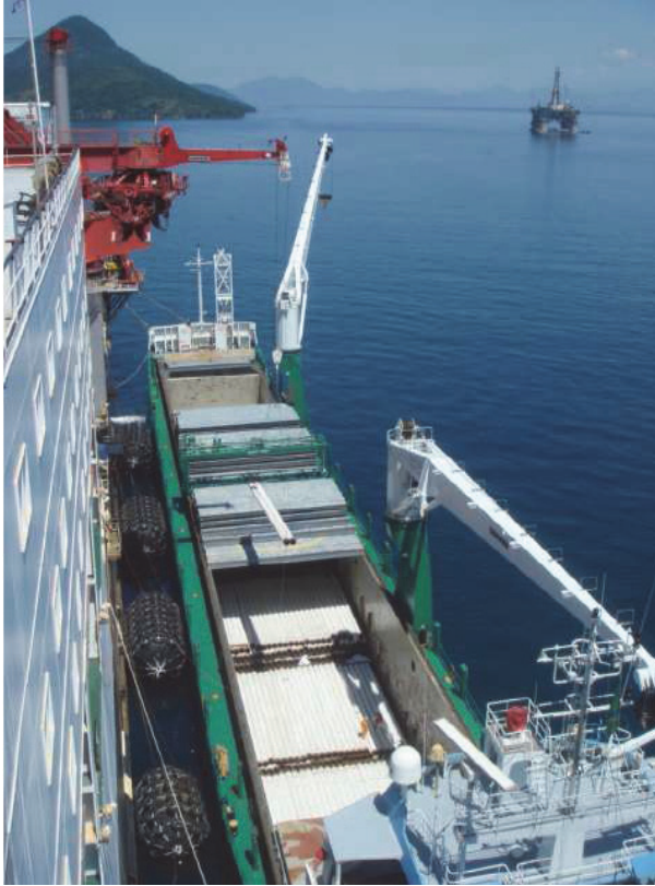
Figura II.2.4.9.4.1-3 - Recebimento dos tubos na embarcação lançadora.
