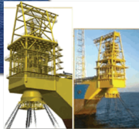
Figura 12 – Ancoragem do FPSO BW São Vicente. Fonte: PETROBRAS
