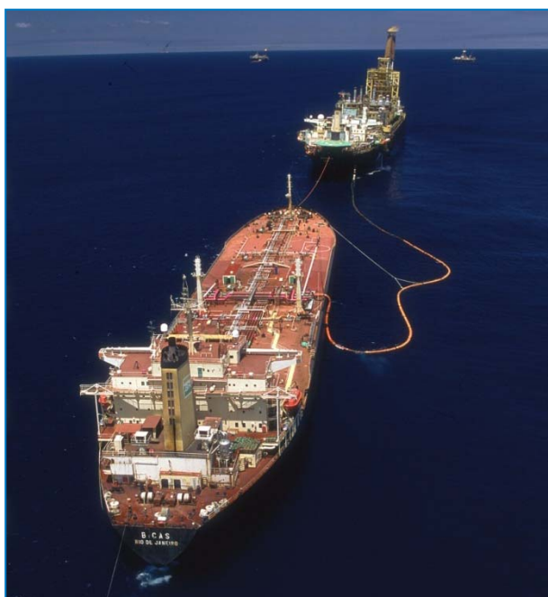
Figura II.2.4-4 - Exemplo de operação de transferência de óleo in tandem .
