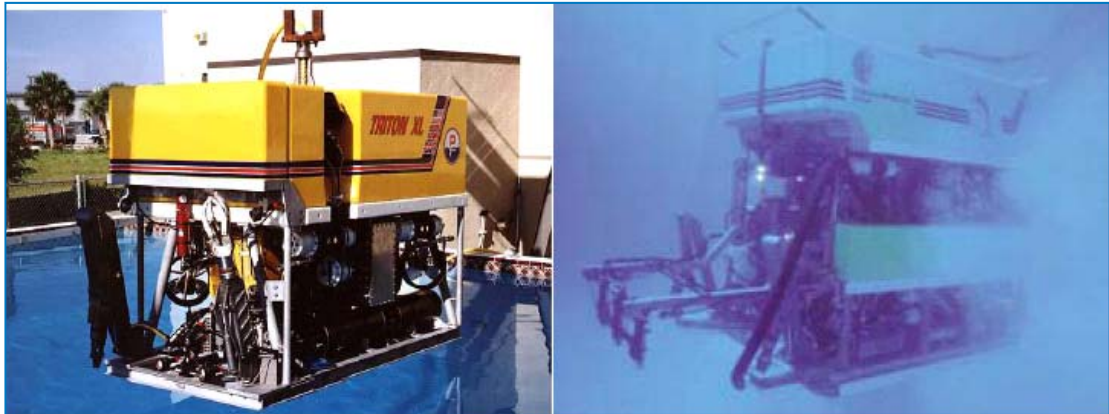
Figura II.2.4-31 - Foto ilustrativa de ROV antes de lançamento (à esquerda) e em operação (à direita).
