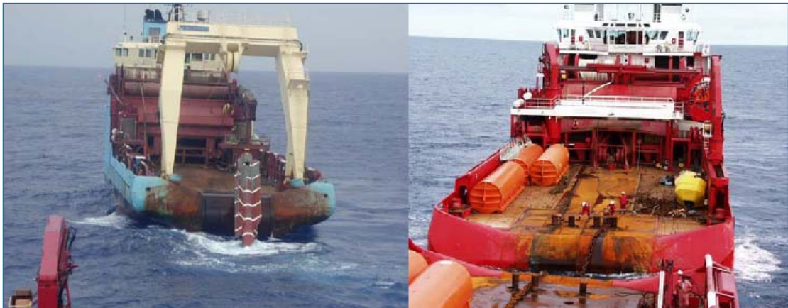
Figura II.2.4-12 - Foto das embarcações de suporte Maersk Boulder (esq) e Far Senior (dir), que poderão ser utilizadas na instalação da ancoragem do FPSO BW Cidade de São Vicente.
