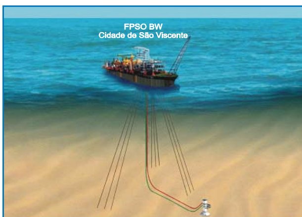
Figura 12 - FPSO BW Cidade de São Vicente, Ancoragem, Linhas de Produção e Árvore de Natal.
