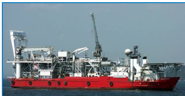
Figura 21 - Exemplos de embarcações de apoio que serão utilizadas para o lançamento de dutos.
