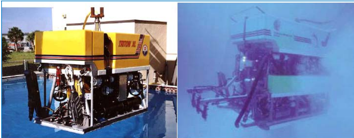
Figura II.2.4-25 - Foto ilustrativa de veículo de operação remota (ROV) antes de lançamento (à esquerda) e em operação (à direita).
