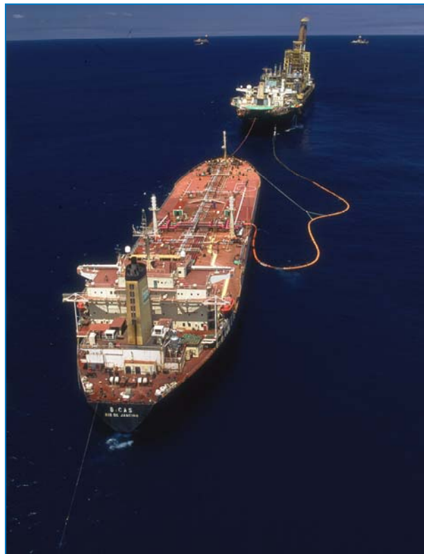
Figura II.2.4-3 - Exemplo de operação de transferência de óleo in tandem .
