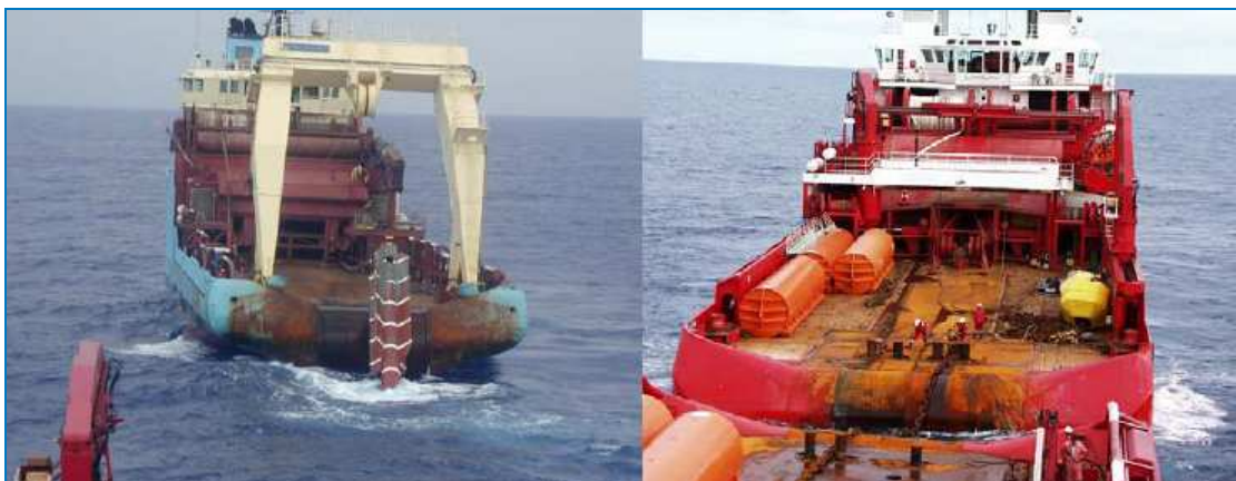
Figura II.2.4-9 - Foto das embarcações de suporte Maersk Boulder (esq) e Far Senior (dir), que poderão ser utilizadas na instalação da ancoragem do FPSO BW Cidade de São Vicente .
