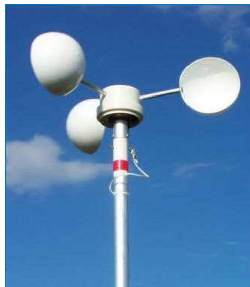
Figura 51 - Exemplo de equipamento utilizado para monitoramento de ventos (direção e velocidade).
