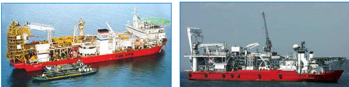
Figura 12 - Exemplos de embarcações de apoio que serão utilizadas para o lançamento de dutos.
