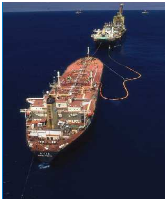
Figura 8 - Exemplo de operação de transferência de petróleo de um navio-plataforma para o navio-aliviador.
