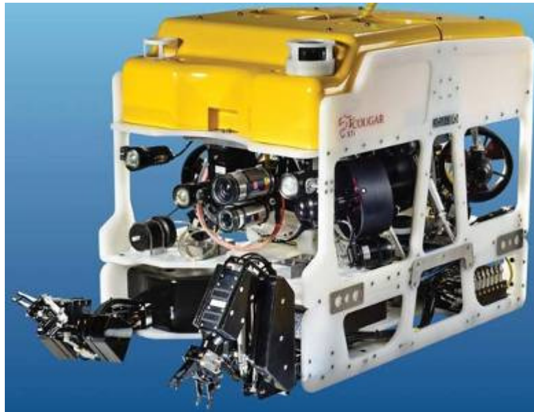
Figura II.2.8.1-4 - Foto ilustrativa do ROV (Remote Operated Vehicle). Fonte: PETROBRAS.
