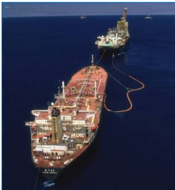
Figura II.2.6.2.5.8-1- Exemplo de operação de transferência de óleo “ in tandem ”.
