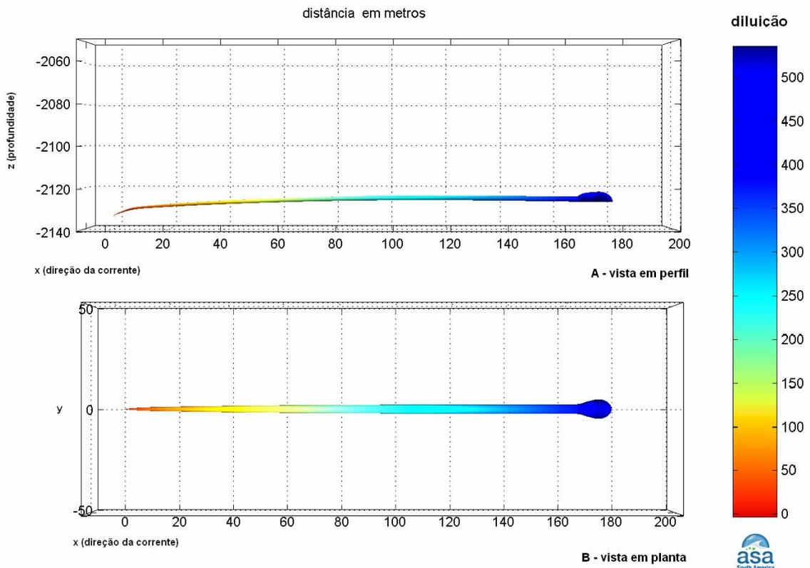
**Figura III-8** - Vista em perfil (A) e em planta (B) do campo próximo da pluma de Fluorene R2 a partir do desalagamento do Gasoduto Tupi-NE-Tupi, no período de inverno.
