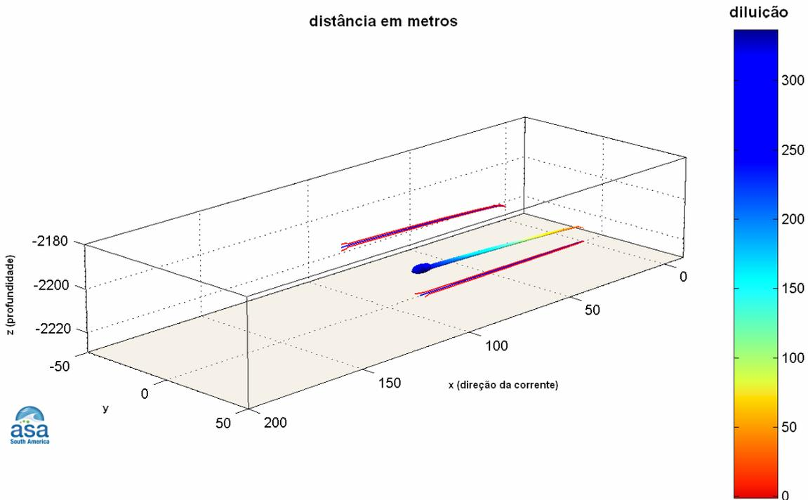
**Figura III-9** - Visualização tridimensional do campo próximo da pluma de Fluorene R2 a partir do desalagamento do Gasoduto Lula-NE-Cernambi, no período de verão.
