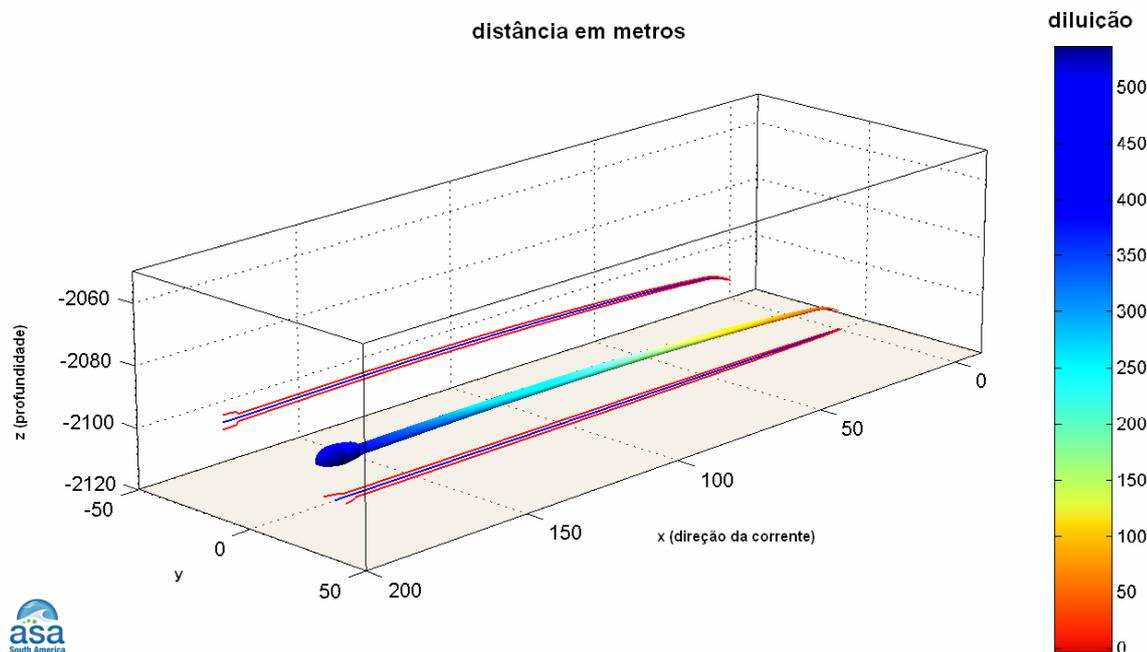
**Figura III-10** - Visualização tridimensional do campo próximo da pluma de Fluorene R2 a partir do desalagamento do Gasoduto Guará-Tupi, no período de inverno.
