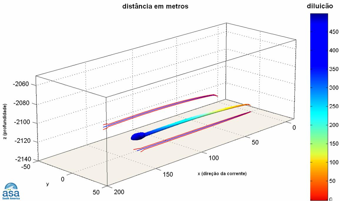
**Figura III-9** - Visualização tridimensional do campo próximo da pluma de Fluorene R2 a partir do desalagamento do Gasoduto Tupi-NE-Tupi, no período de verão.
