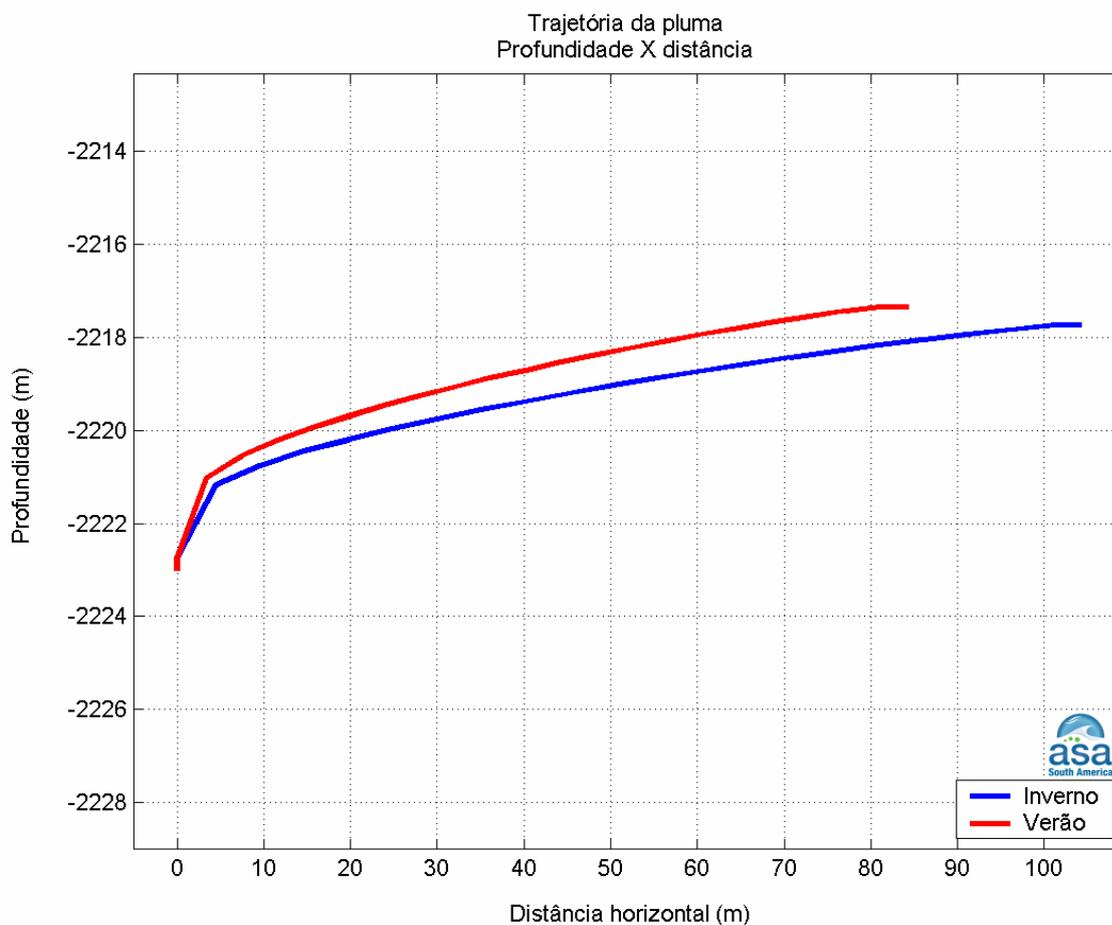
**Figura III-5** - Profundidades em relação a distância do ponto de lançamento de Fluorene R2 a partir do Gasoduto Lula-NE-Cernambi, nos períodos de verão e inverno.
