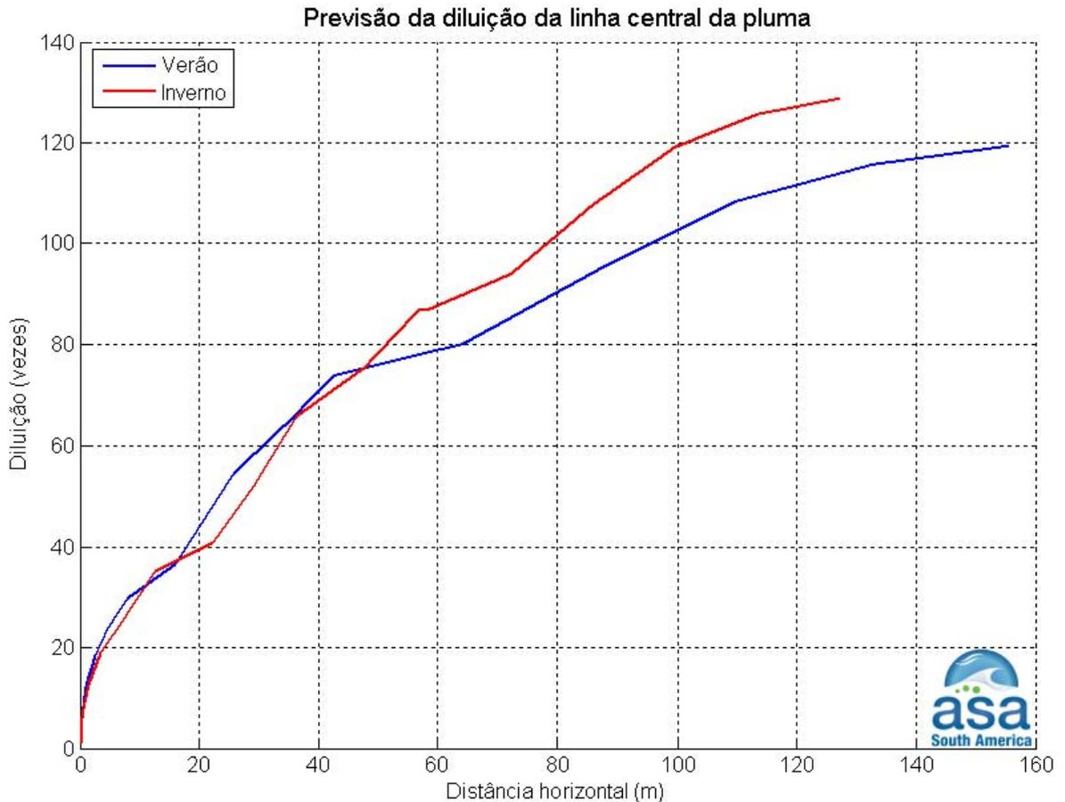
**Figura V-3** - Diluo em relao  distncia do ponto de lanamento da pluma de efluente da URS do Piloto de Guar nos perodos de vero e inverno.
