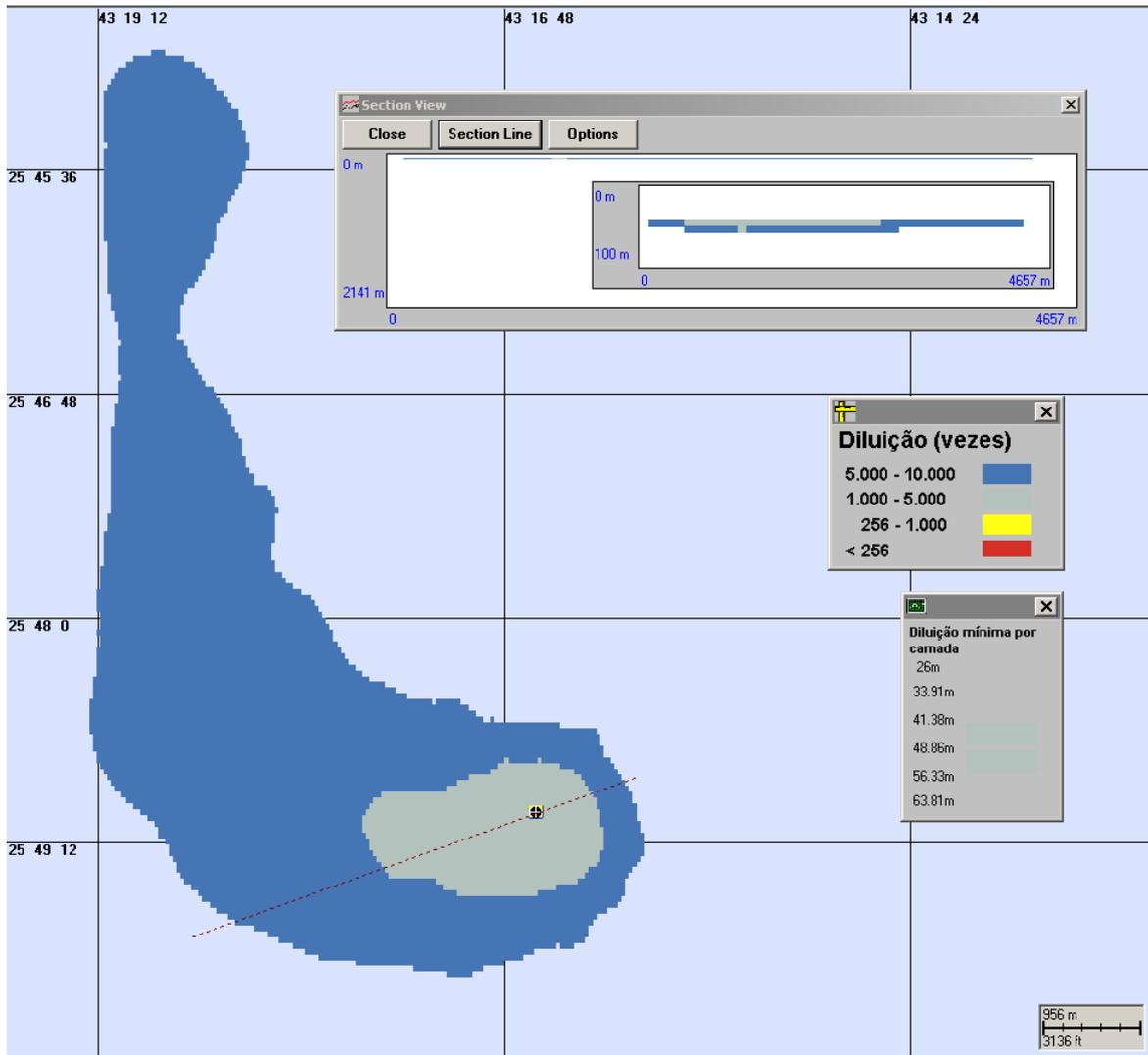
**Figura V-27** - Diluições calculadas para a pluma de efluente da URS do Piloto de Guará sem a adição de biocida, simulada no período de verão (maior distância a partir do ponto de descarte), após 24 horas.
