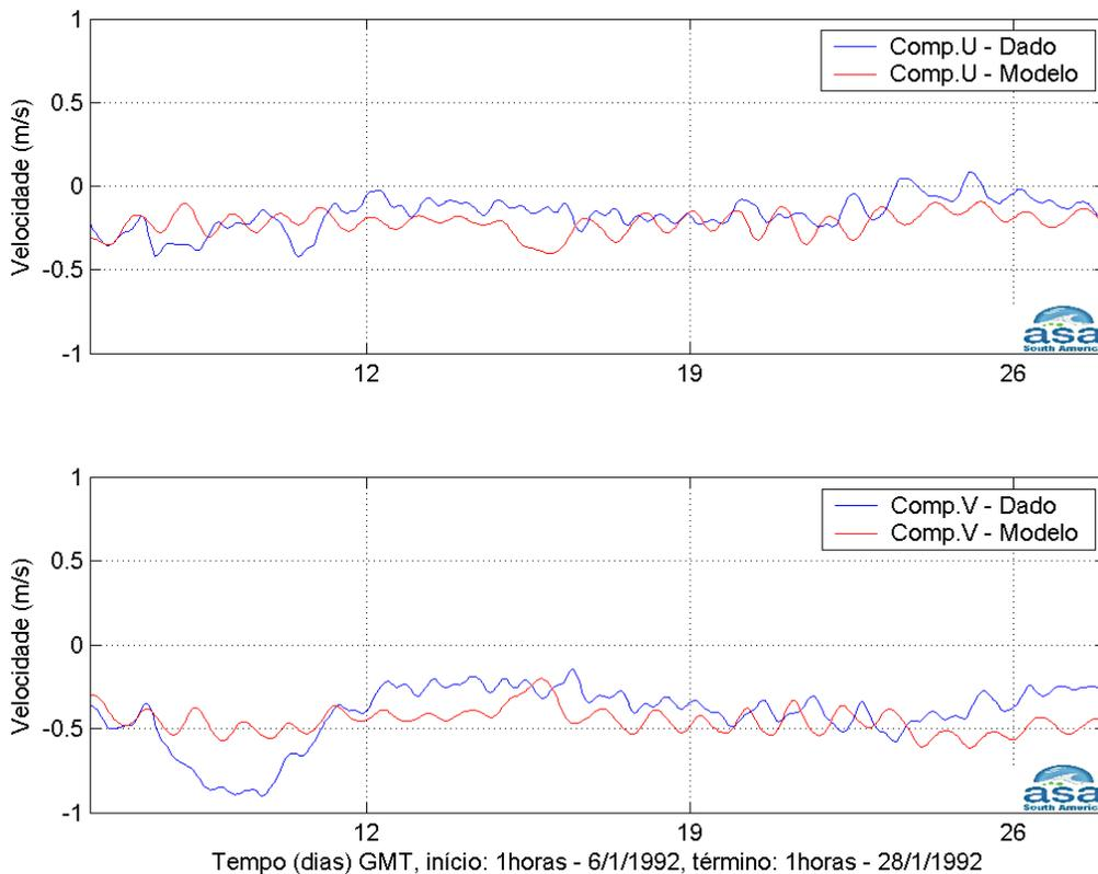
**Figura IV.2-5 -** Série temporal medida das componentes *u* e *v* da velocidade medida (azul) e a calculada pelo modelo (vermelho) entre os dias 6 e 28 de janeiro de 1992 para o Ponto BM333.
