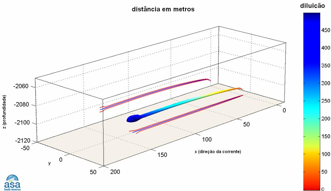
**Figura III-9** - Visualização tridimensional do campo próximo da pluma de Fluorene R2 a partir do desalagamento do Gasoduto Guará-Tupi, no período de verão.
