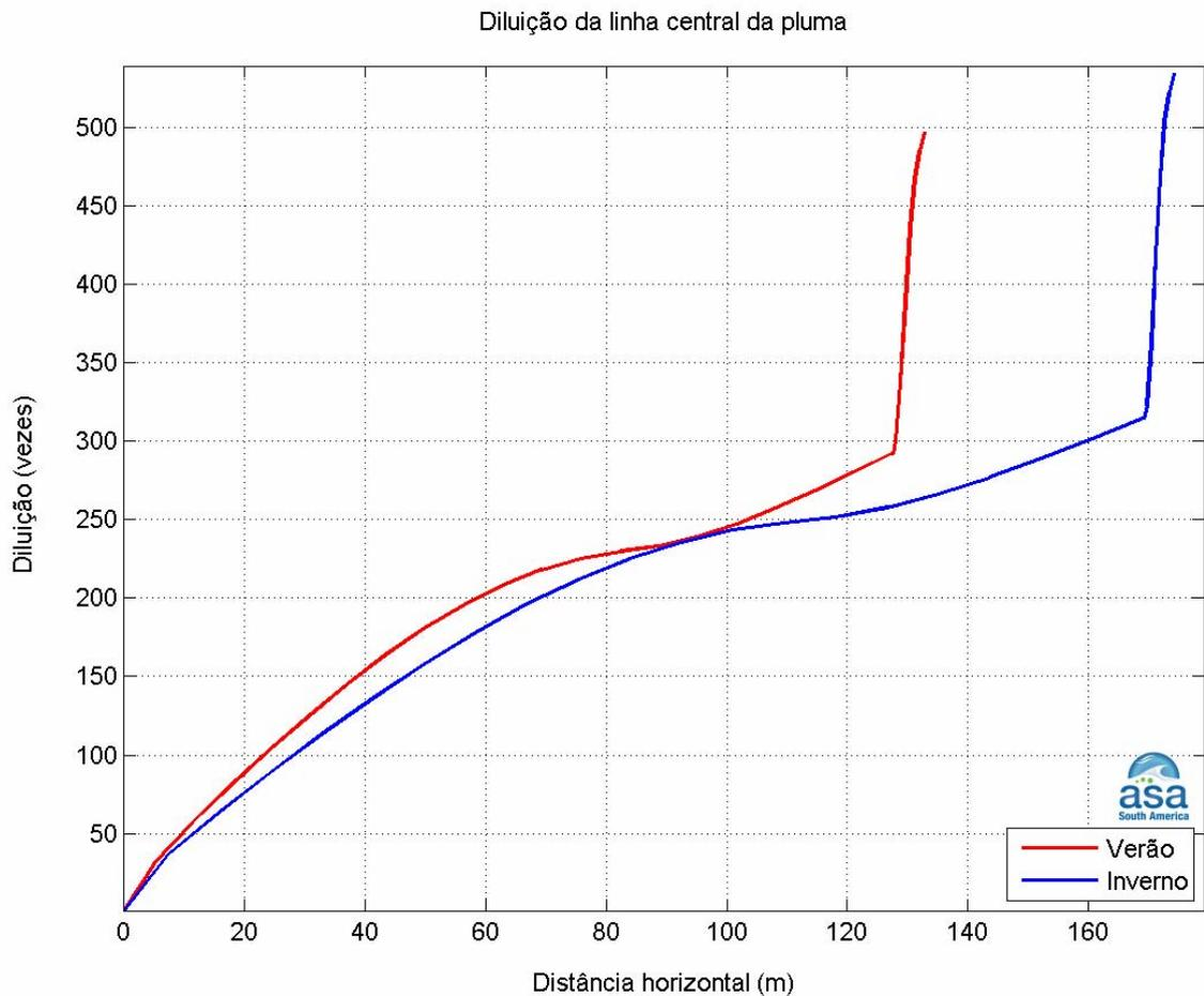
**Figura III-4** - Diluição em relação a distância do ponto de lançamento de Fluorene R2 a partir do desalagamento do Gasoduto Tupi-NE-Tupi, nos períodos de verão e inverno.
