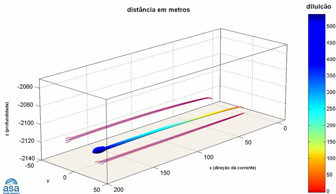
**Figura III-10** - Visualização tridimensional do campo próximo da pluma de Fluorene R2 a partir do desalagamento do Gasoduto Tupi-NE-Tupi, no período de inverno.
