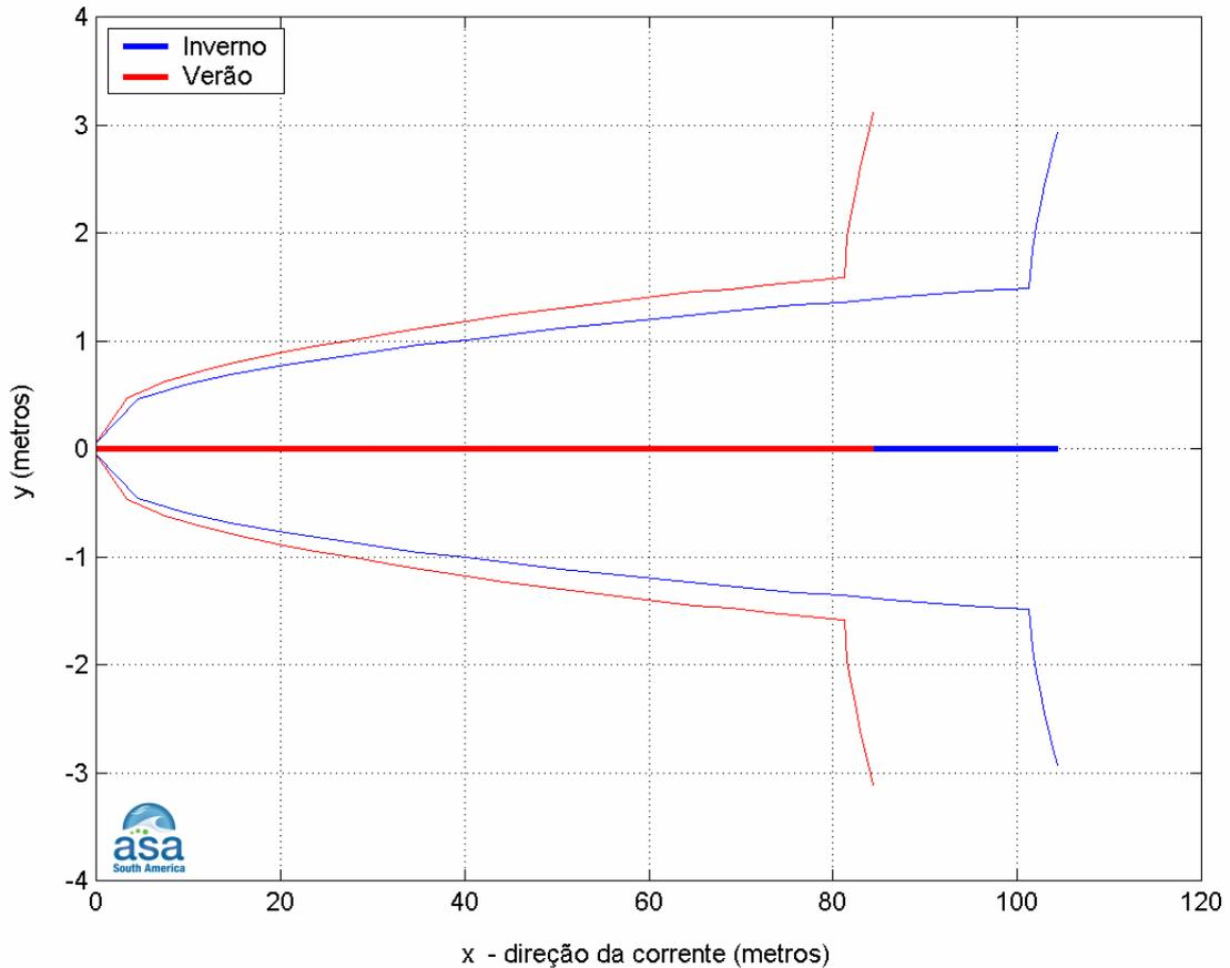
**Figura III-6** - Trajetória horizontal (visão superficial) da pluma de Fluorene R2 a partir do desalagamento do Gasoduto Lula-NE-Cernambi, nos períodos de verão e inverno.
