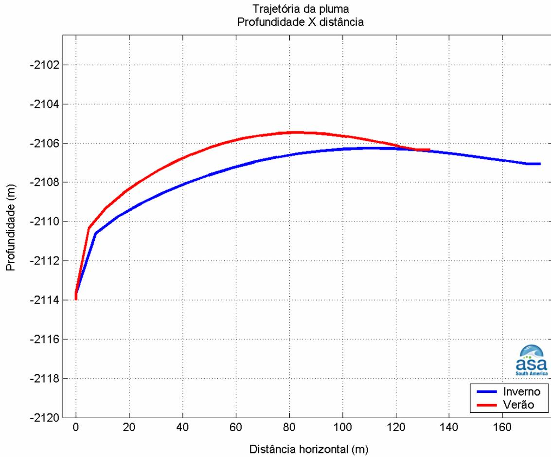
**Figura III-5** - Profundidades em relação a distância do ponto de lançamento de Fluorene R2 a partir do Gasoduto Guará-Tupi, nos períodos de verão e inverno.
