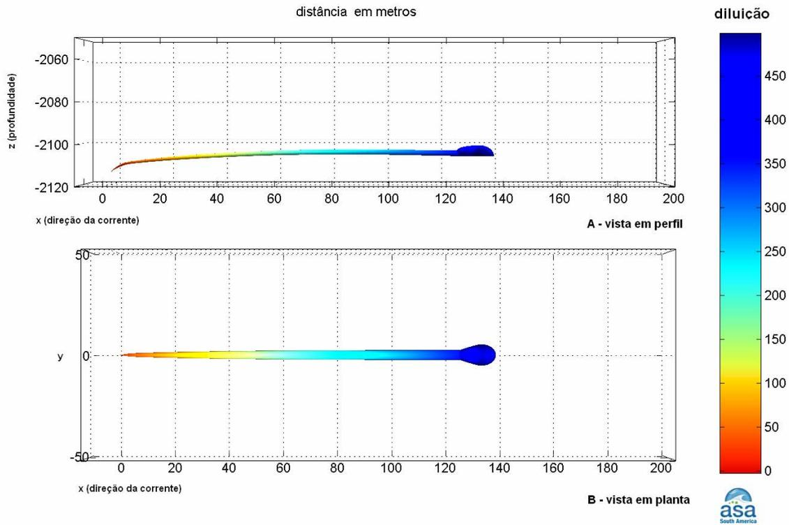
**Figura III-7** - Vista em perfil (A) e em planta (B) do campo próximo da pluma de Fluorene R2 a partir do desalagamento do Gasoduto Guará-Tupi, no período de verão.
