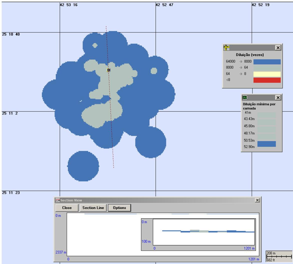
**Figura V-42** - Diluições calculadas para a pluma de efluente da URS do DP de Iracema com a adição de biocida, simulada no período de inverno (menor diluição nas proximidades do ponto de descarte), após 1 hora.
