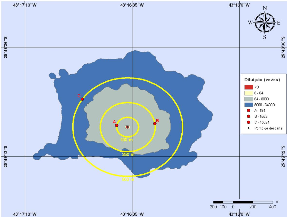
**Figura V-14** - Diluo es calculadas para a pluma de efluente da URS do Piloto de Guar com a adio do biocida, simulada no perodo de inverno, aps 1 hora.
