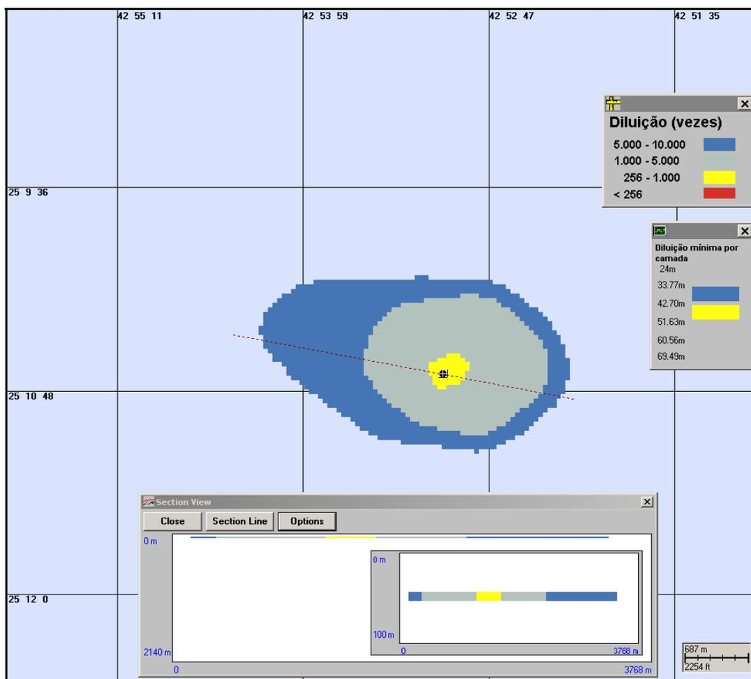
**Figura V-36** - Diluies calculadas para a pluma de gua produzida descartada a partir do DP de Iracema, simulada no perodo de inverno (maior distncia a partir do ponto de descarte), aps 24 horas.
