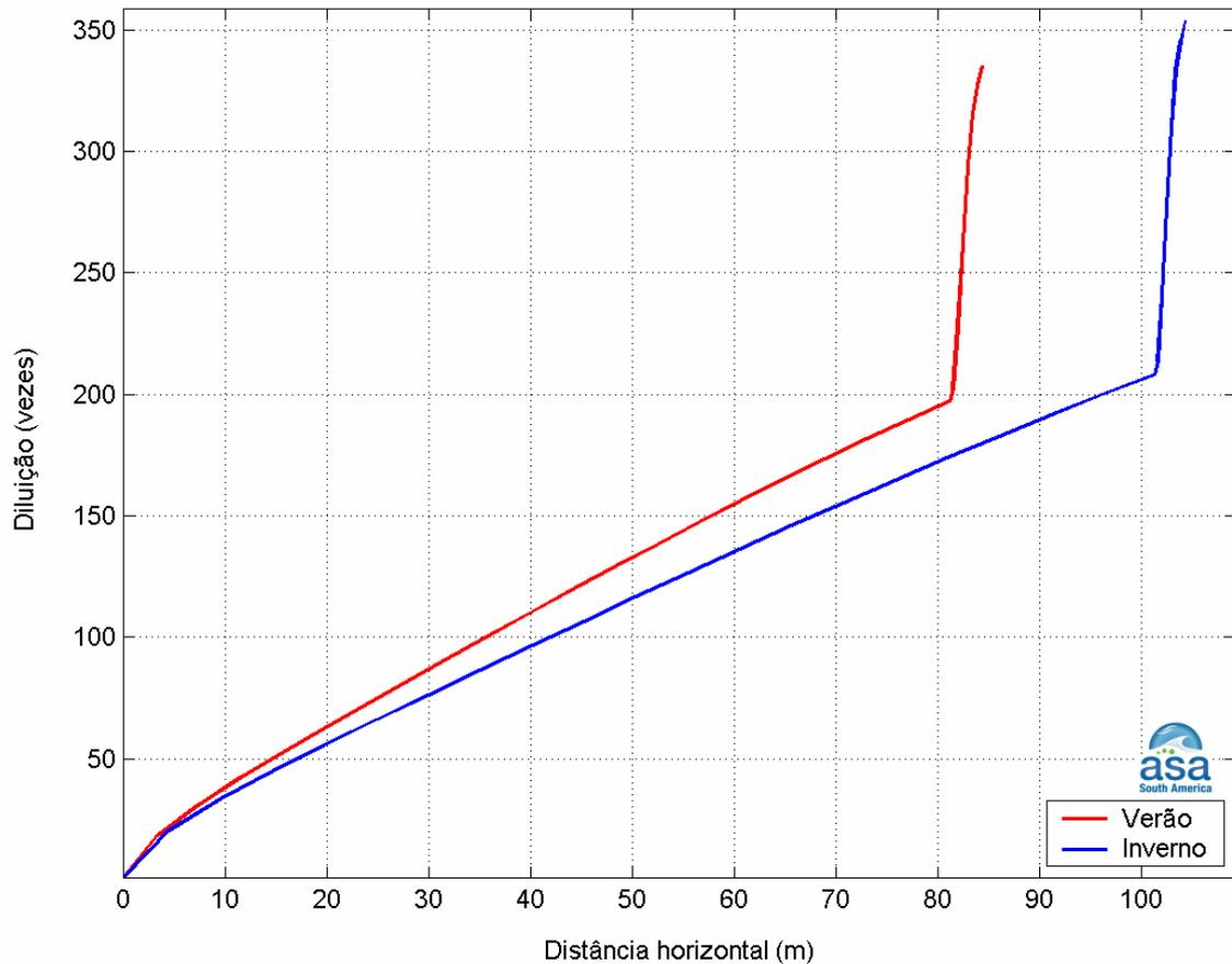
**Figura III-4** - Diluição em relação a distância do ponto de lançamento de Fluorene R2 a partir do desalagamento do Gasoduto Lula-NE-Cernambi, nos períodos de verão e inverno.
