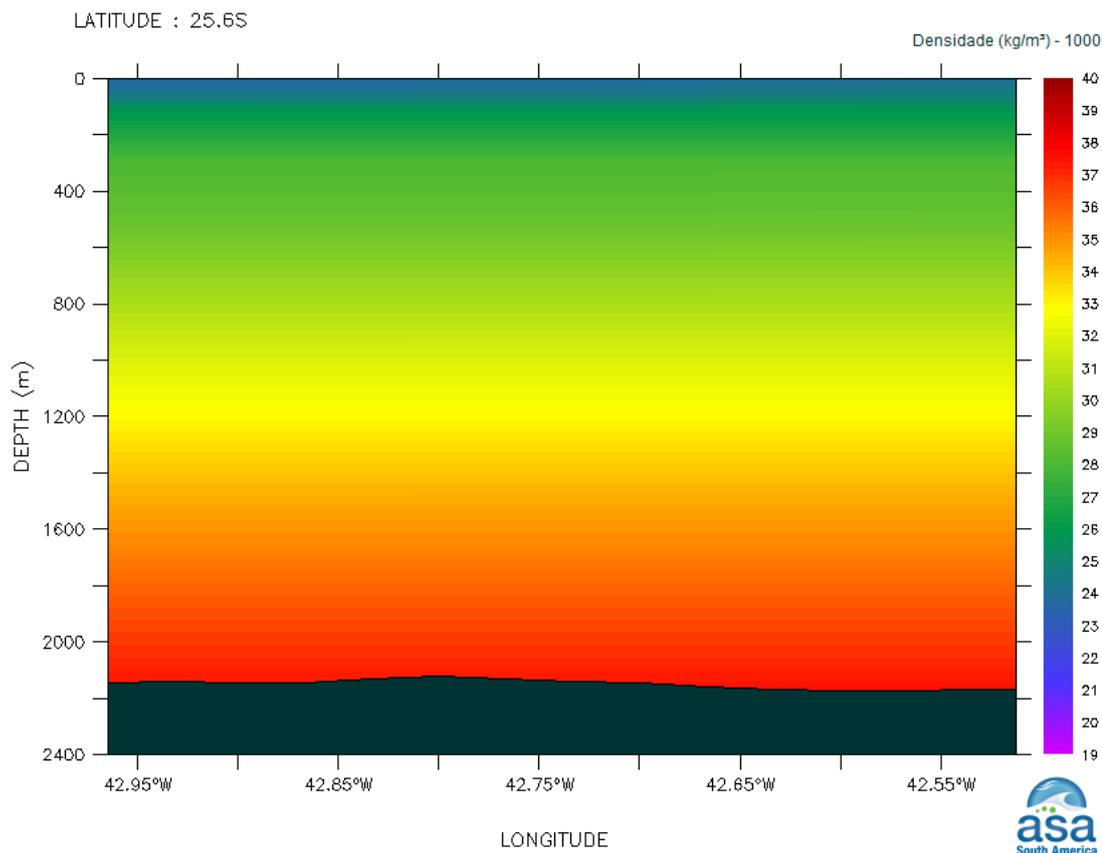
**Figura III-2** - Seção vertical de densidade (kg/m<sup>3</sup>) ao longo de 25,6°S para o período de janeiro a março (verão).
