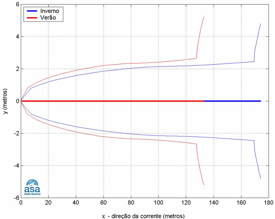
**Figura III-6** - Trajetória horizontal (visão superficial) da pluma de Fluorene R2 a partir do desalagamento do Gasoduto Tupi-NE-Tupi, nos períodos de verão e inverno.
