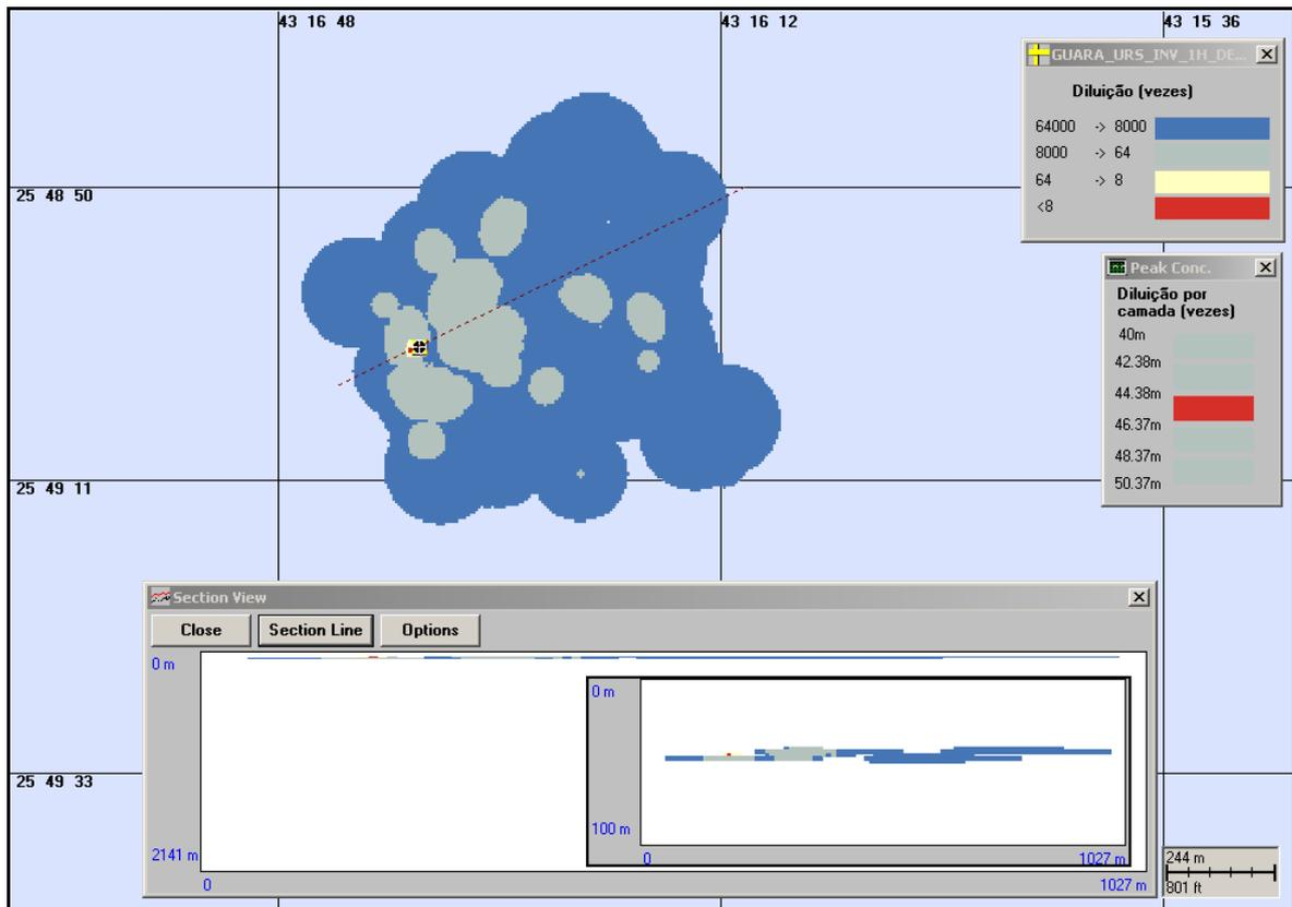
**Figura V-30** - Diluies calculadas para a pluma de efluente da URS do Piloto de Guar com a adio de biocida, simulada no perodo de inverno (menor diluio nas proximidades do ponto de descarte), aps 1 hora.
