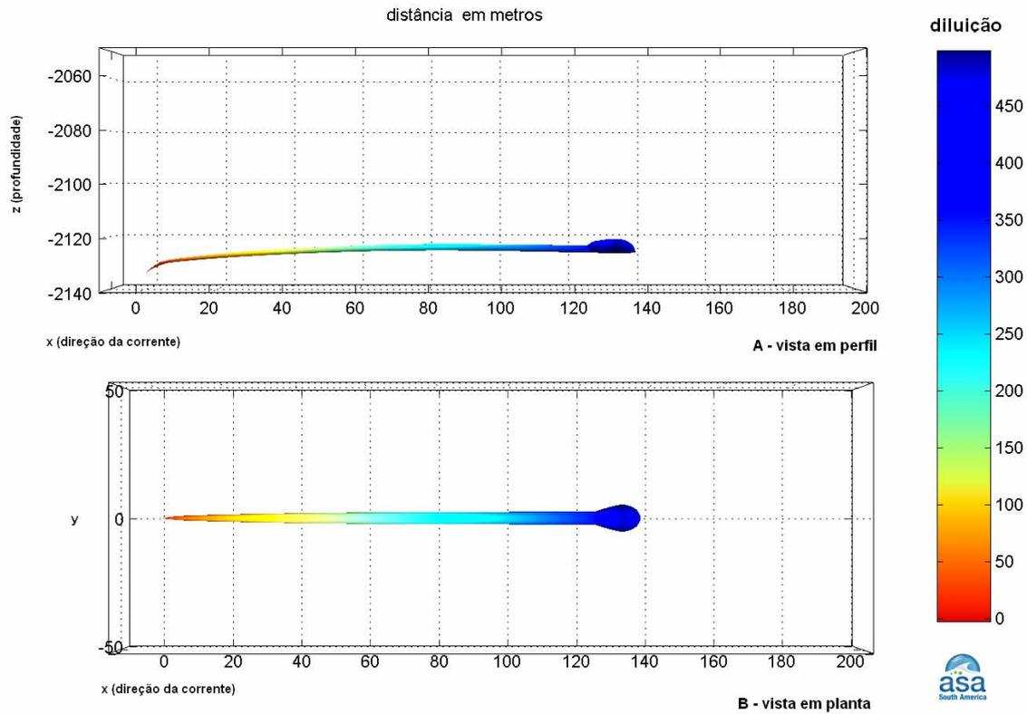
**Figura III-7** - Vista em perfil (A) e em planta (B) do campo próximo da pluma de Fluorene R2 a partir do desalagamento do Gasoduto Tupi-NE-Tupi, no período de verão.
