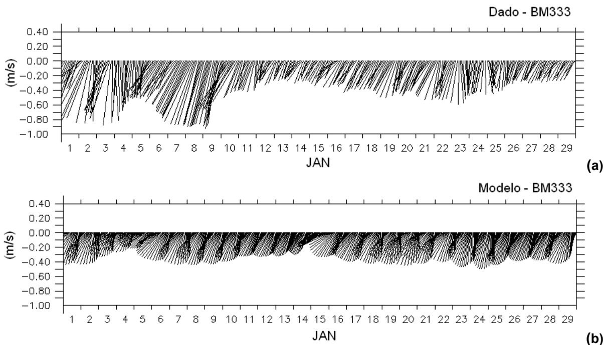
**Figura IV.2-6 -** Diagrama stick plot dos vetores de corrente medida no Ponto BM333 (a) e calculada pelo modelo (b) entre os dias 1<sup>o</sup> a 30 de janeiro de 1992.
