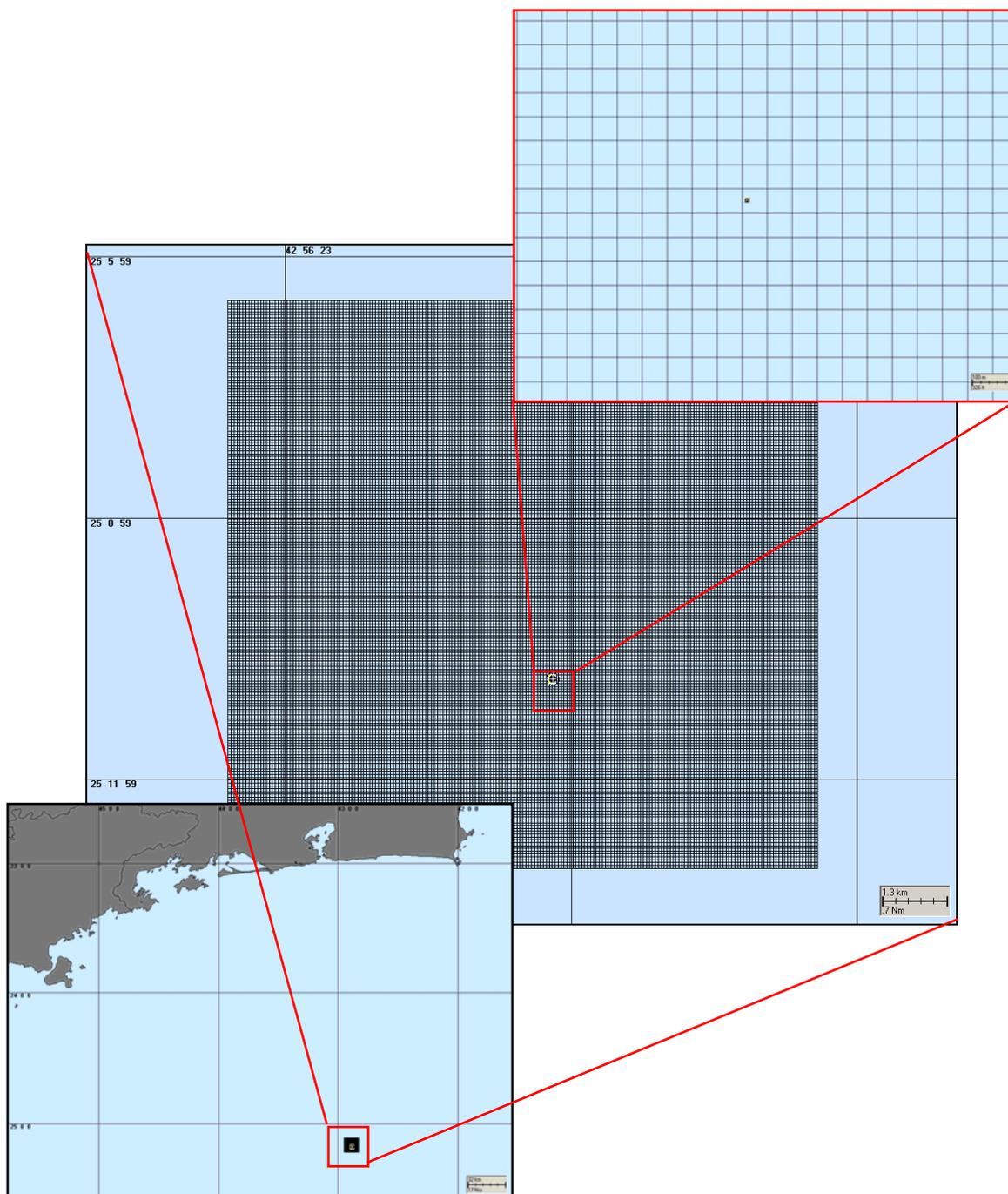
**Figura IV-2** - Grade habitat/depth utilizada nas simulações com o modelo CHEMMAP para o DP de Iracema. No detalhe inferior são apresentadas a localização do ponto, da grade e o continente como referência.
