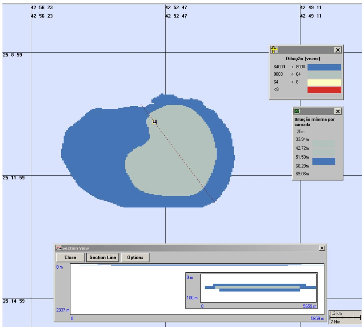
**Figura V-40** - Diluições calculadas para a pluma de efluente da URS do DP de Iracema sem a adição de biocida, simulada no período de inverno (maior distância a partir do ponto de descarte), após 24 horas.
