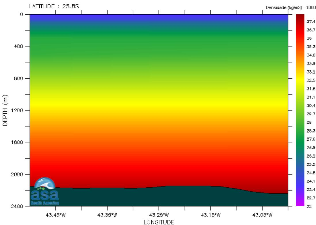
**Figura II.4-3** - Seção vertical de densidade (kg/m<sup>3</sup>) ao longo de 25,8°S para o período de janeiro a março (verão), Área do Pré-Sal.
