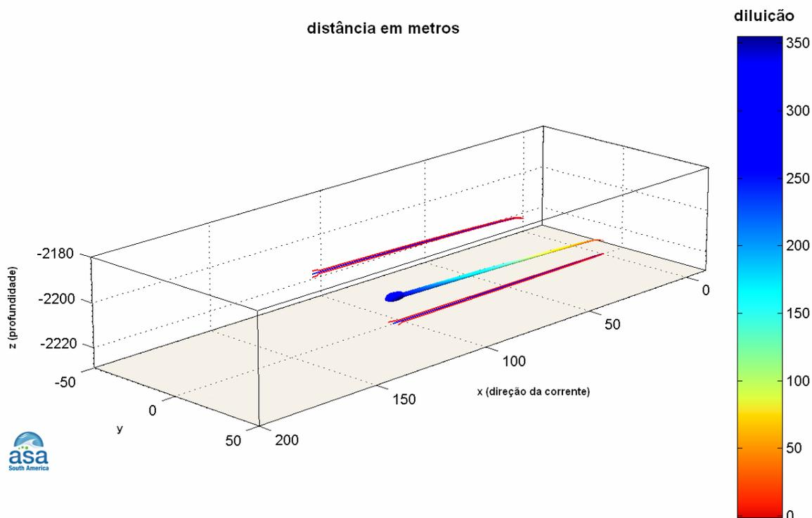
**Figura III-10** - Visualização tridimensional do campo próximo da pluma de Fluorene R2 a partir do desalagamento do Gasoduto Lula-NE-Cernambi, no período de inverno.
