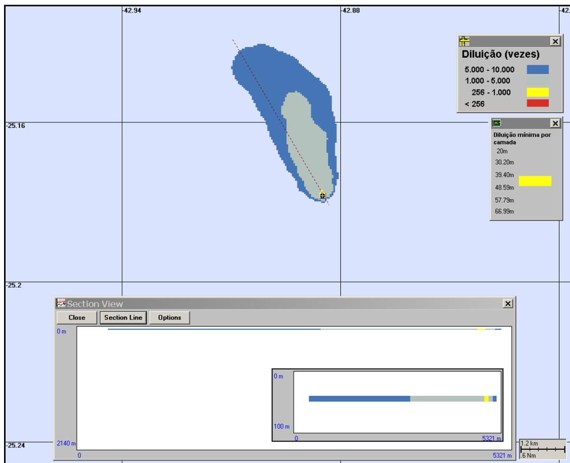
**Figura V-33** - Diluições calculadas para a pluma de água produzida descartada a partir do DP de Iracema, simulada no período de verão (menor diluição nas proximidades do ponto de descarte), após 24 horas.
