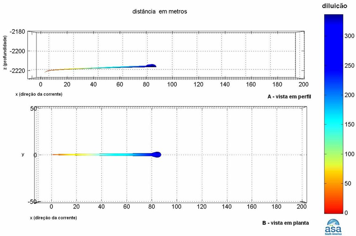
**Figura III-7** - Vista em perfil (A) e em planta (B) do campo próximo da pluma de Fluorene R2 a partir do desalagamento do Gasoduto Lula-NE-Cernambi, no período de verão.
