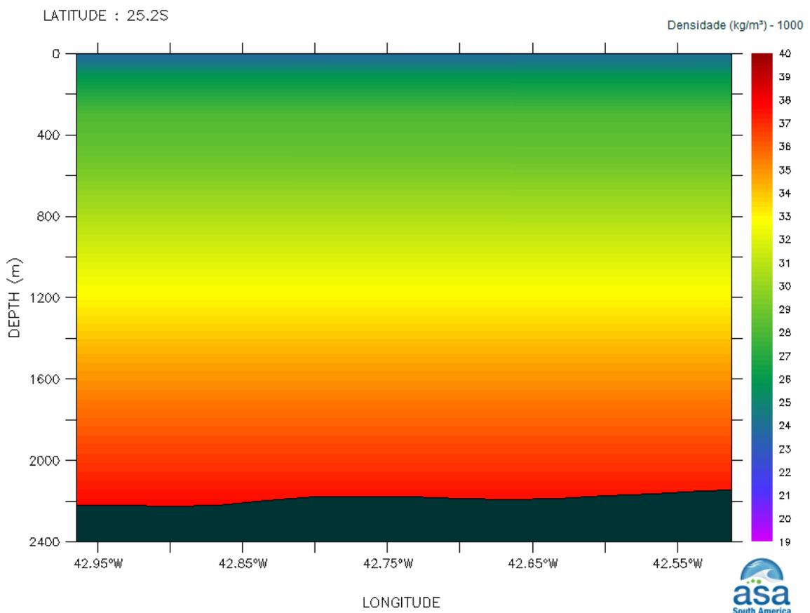
**Figura III-2** - Seção vertical de densidade (kg/m<sup>3</sup>) ao longo de 25,2°S para o período de janeiro a março (verão).
