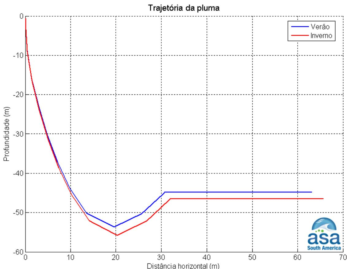
**Figura V-6** - Profundidades em relao  distncia do ponto de lanamento da pluma de gua produzida descartada a partir do DP de Iracema nos perodos de vero e inverno.
