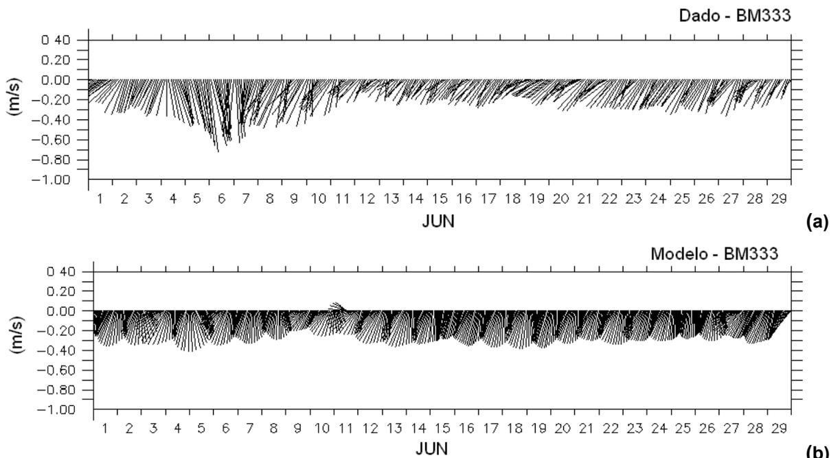
**Figura IV.2-8 - Diagrama stick plot dos vetores de corrente medida no Ponto BM333 (a) e calculada pelo modelo (b) entre os dias 1<sup>o</sup> e 30 de junho de 1992.**
