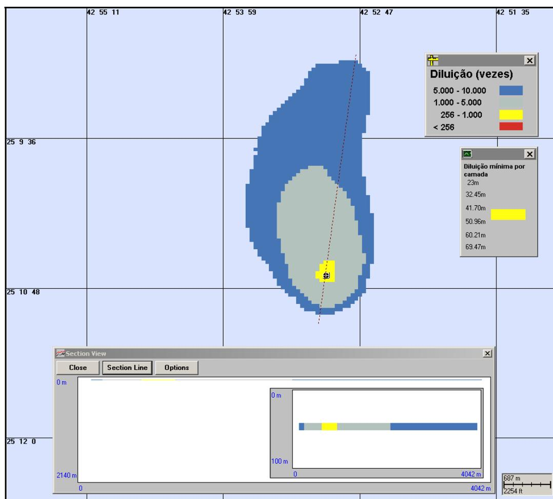
**Figura V-34** - Diluições calculadas para a pluma de água produzida descartada a partir do DP de Iracema, simulada no período de inverno (menor diluição nas proximidades do ponto de descarte), após 24 horas.
