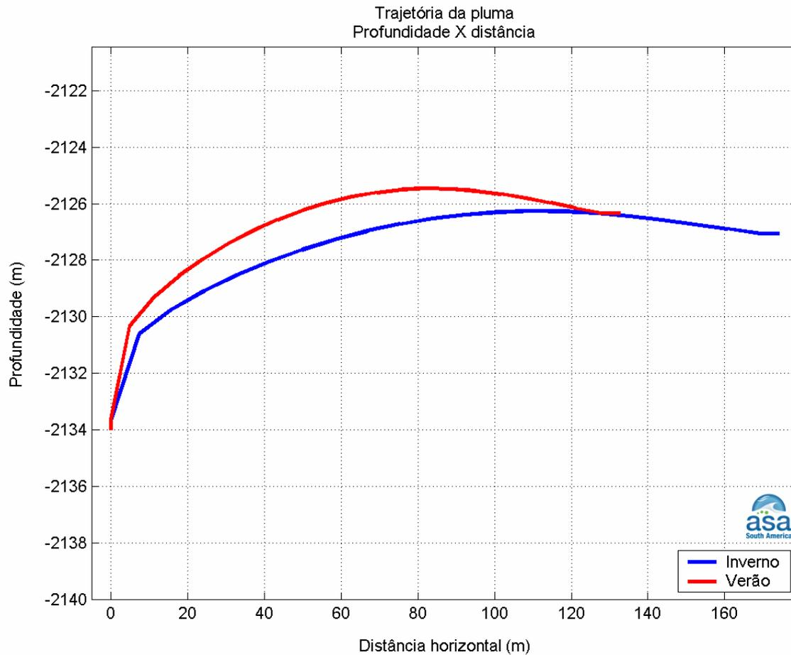
**Figura III-5** - Profundidades em relação a distância do ponto de lançamento de Fluorene R2 a partir do Gasoduto Tupi-NE-Tupi, nos períodos de verão e inverno.
