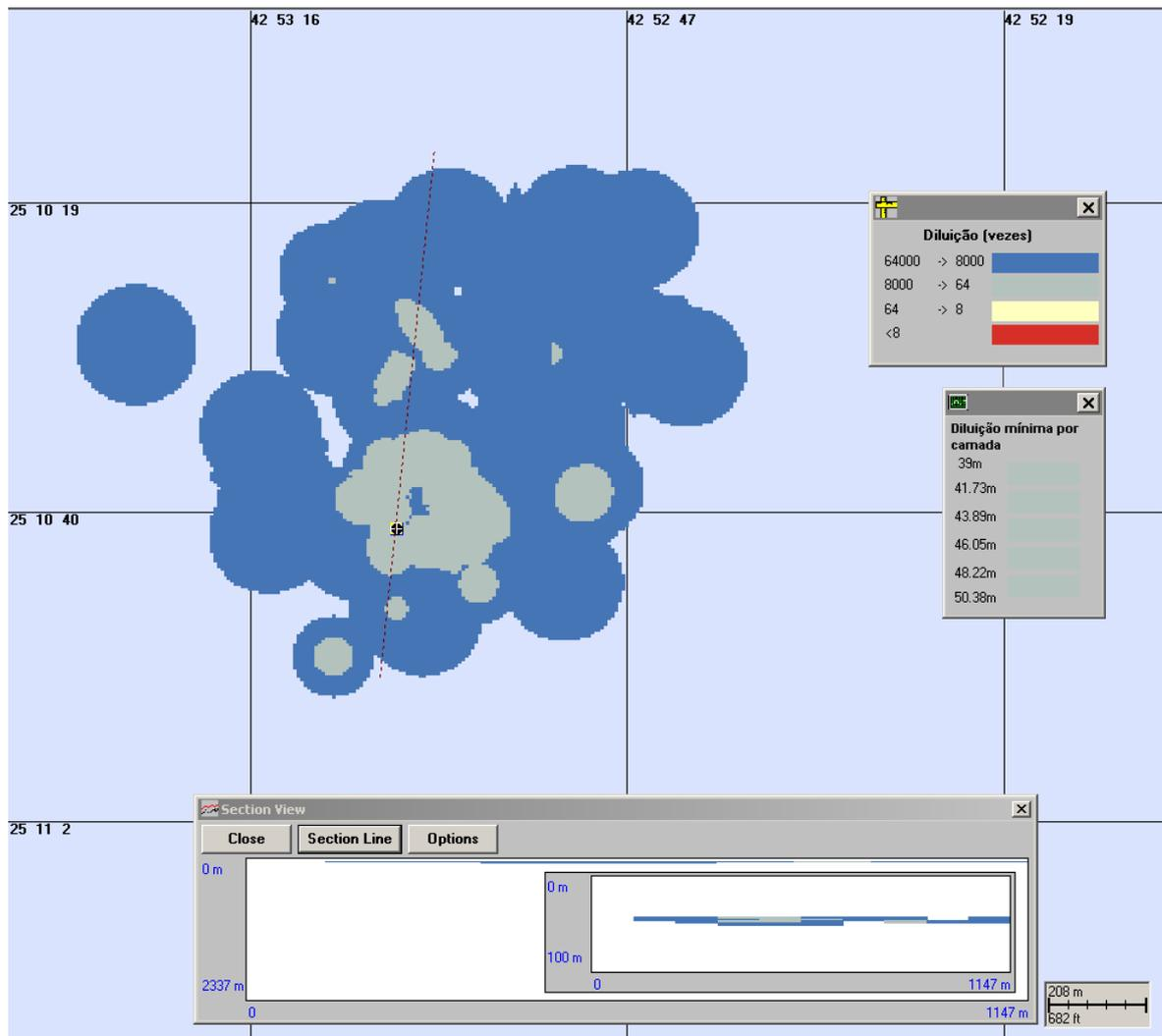
**Figura V-41** - Diluies calculadas para a pluma de efluente da URS do DP de Iracema com a adio de biocida, simulada no perodo de vero (menor diluio nas proximidades do ponto de descarte), aps 1 hora.
