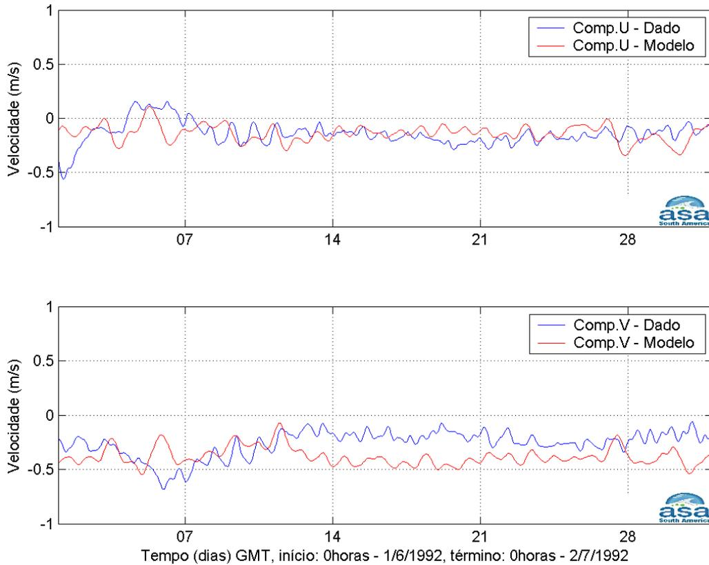
**Figura IV.2-7 - Série temporal medida das componentes  $u$  e  $v$  da velocidade medida (azul) e a calculada pelo modelo (vermelho) entre os dias 1<sup>o</sup> de junho e 2 de julho de 1992 para o Ponto BM333.**
