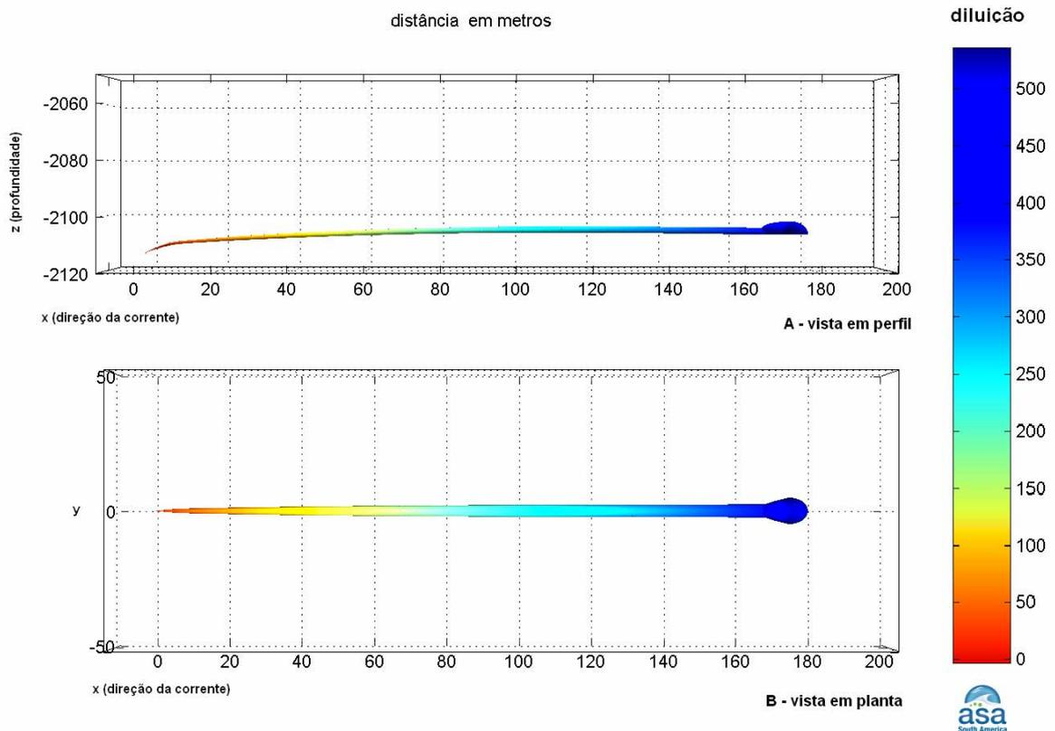
**Figura III-8** - Vista em perfil (A) e em planta (B) do campo próximo da pluma de Fluorene R2 a partir do desalagamento do Gasoduto Guará-Tupi, no período de inverno.
