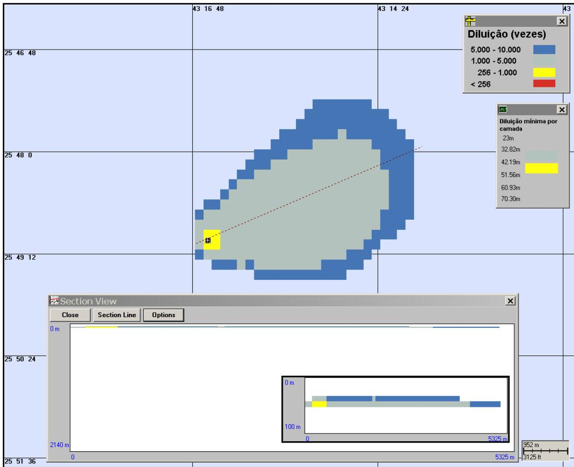
**Figura V-22** - Diluições calculadas para a pluma de água produzida descartada a partir do Piloto de Guará, simulada no período de inverno (menor diluição nas proximidades do ponto de descarte), após 24 horas.
