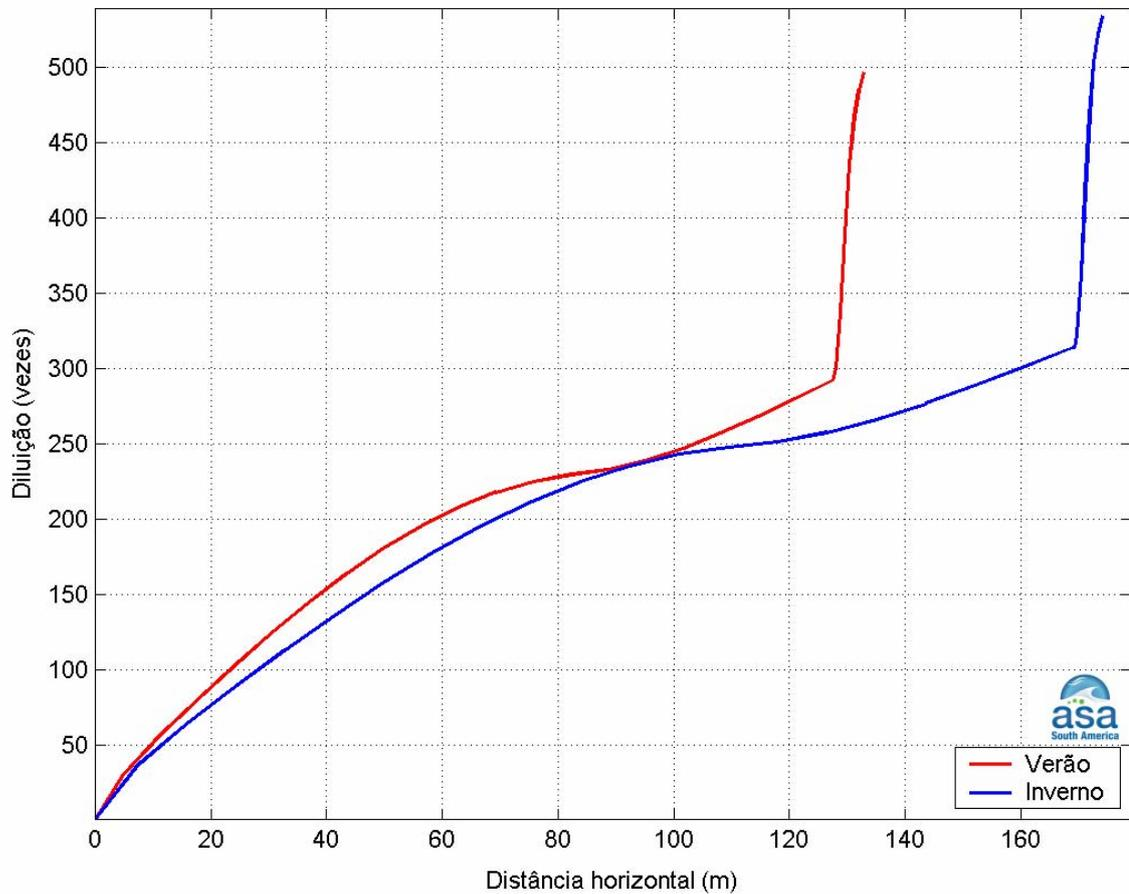
**Figura III-4** - Diluição em relação a distância do ponto de lançamento de Fluorene R2 a partir do desalagamento do Gasoduto Guará-Tupi, nos períodos de verão e inverno.
