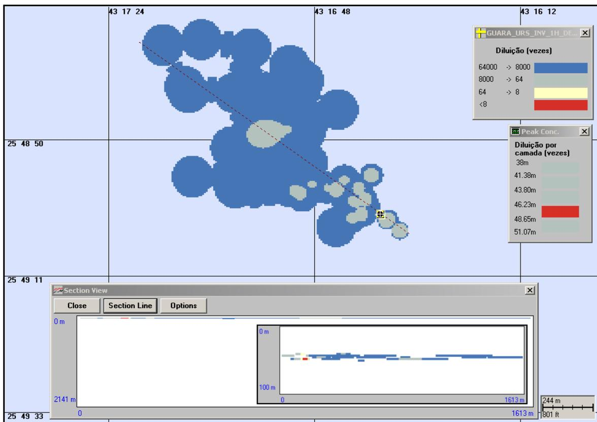
**Figura V-32** - Diluies calculadas para a pluma de efluente da URS do Piloto de Guar com a adio de biocida, simulada no perodo de inverno (maior distncia a partir do ponto de descarte), aps 1 hora.
