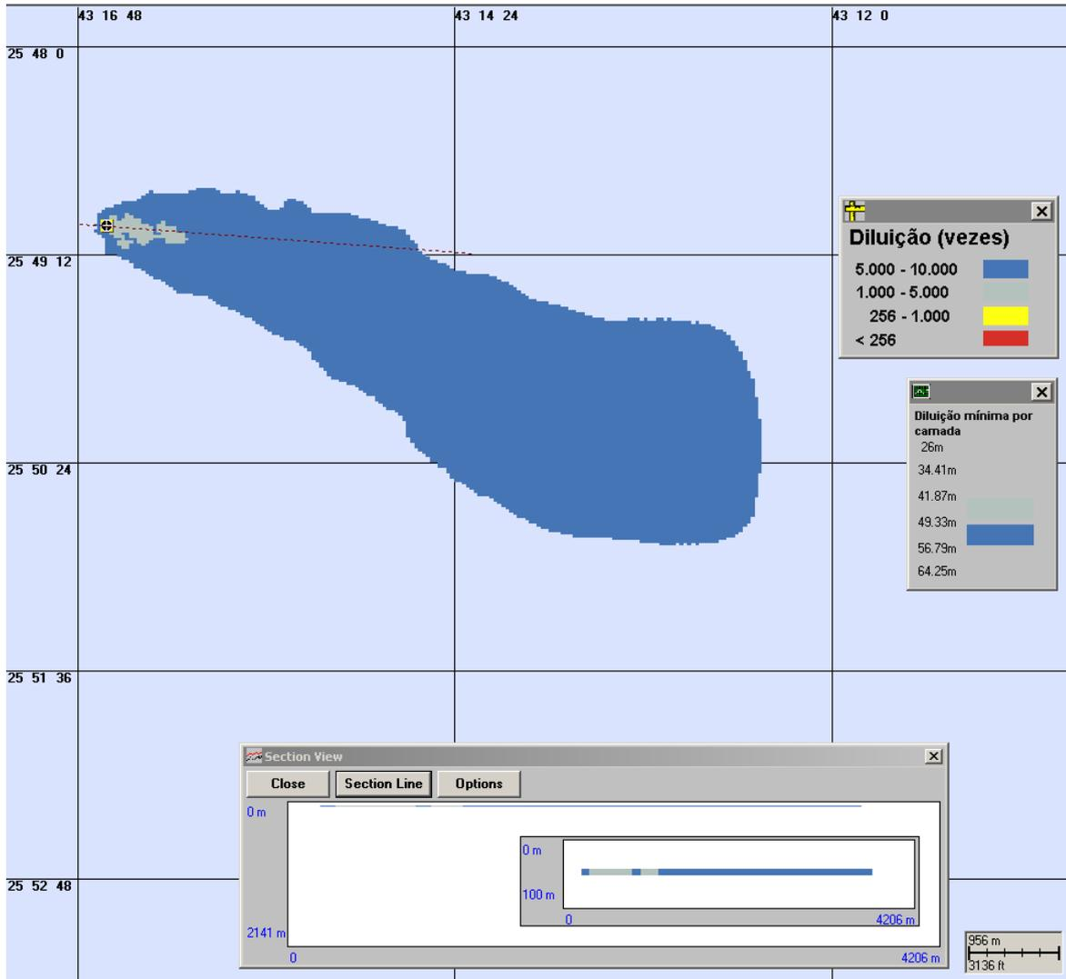
**Figura V-25** - Diluições calculadas para a pluma de efluente da URS do Piloto de Guará sem a adição de biocida, simulada no período de verão (menor diluição nas proximidades do ponto de descarte), após 24 horas.
