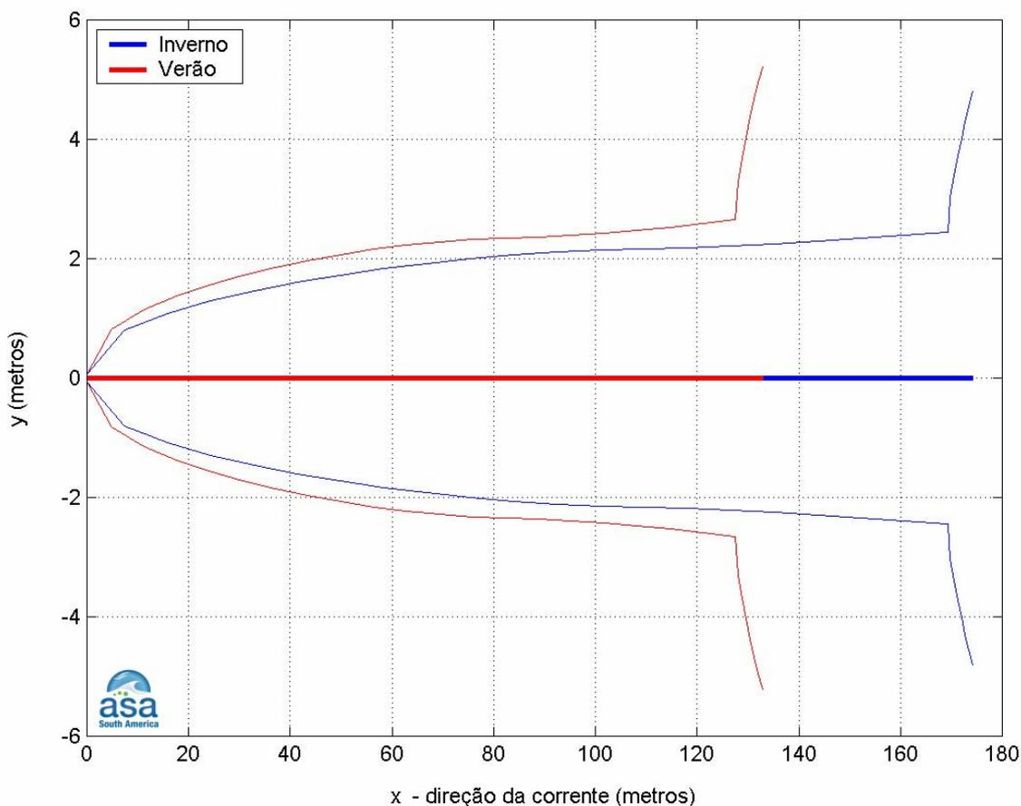
**Figura III-6** - Trajetória horizontal (visão superficial) da pluma de Fluorene R2 a partir do desalagamento do Gasoduto Guará-Tupi, nos períodos de verão e inverno.
