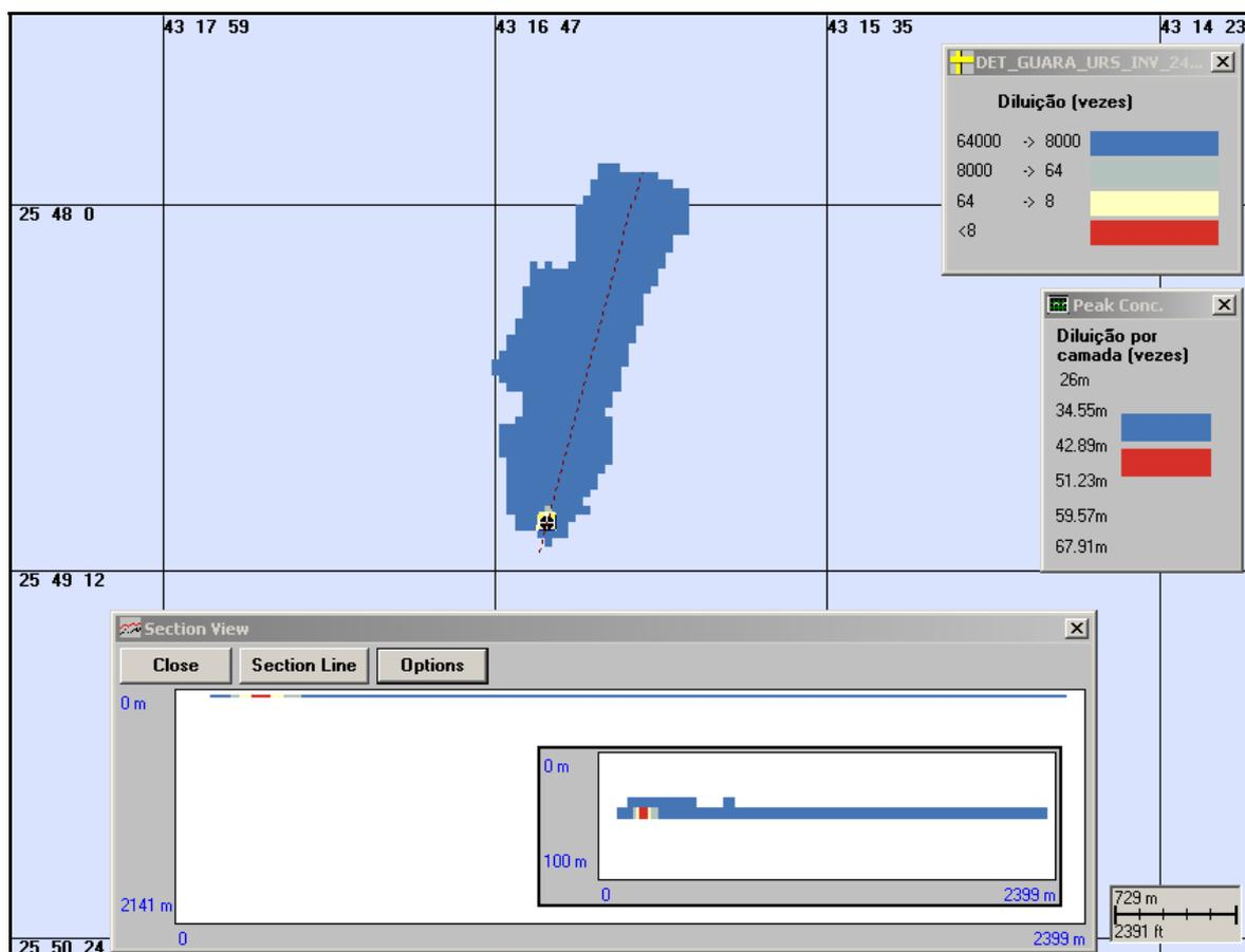
**Figura V-28** - Diluies calculadas para a pluma de efluente da URS do Piloto de Guar sem a adio de biocida, simulada no perodo de inverno (maior distncia a partir do ponto de descarte), aps 24 horas.
