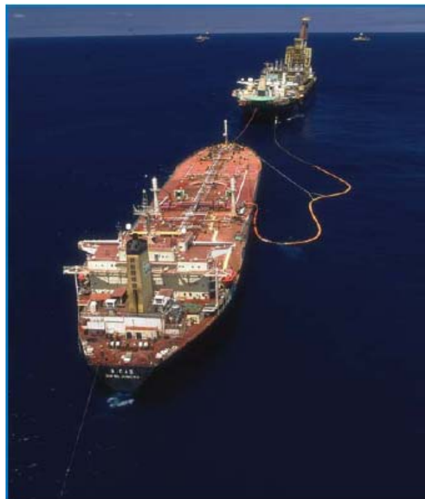
Figura 15 – Exemplo de operação de transferência de óleo de um navio-plataforma para o navio aliviador.
