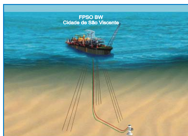
Figura 12 – FPSO BW Cidade de São Vicente, Ancoragem, Linhas de Produção e Árvore de Natal.
