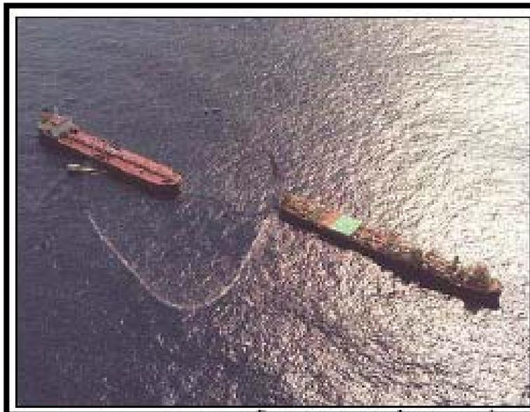
**Figura II.2.4.C-4** - Exemplo de operação de transferência de óleo *in tandem*.
