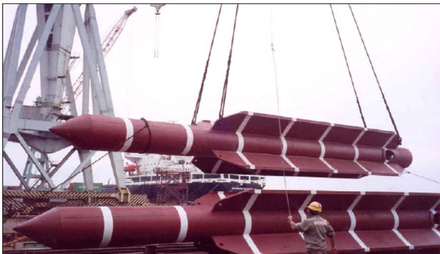
**Figura II.2.4.L-1** – Estaca do tipo torpedo a ser utilizada na ancoragem
