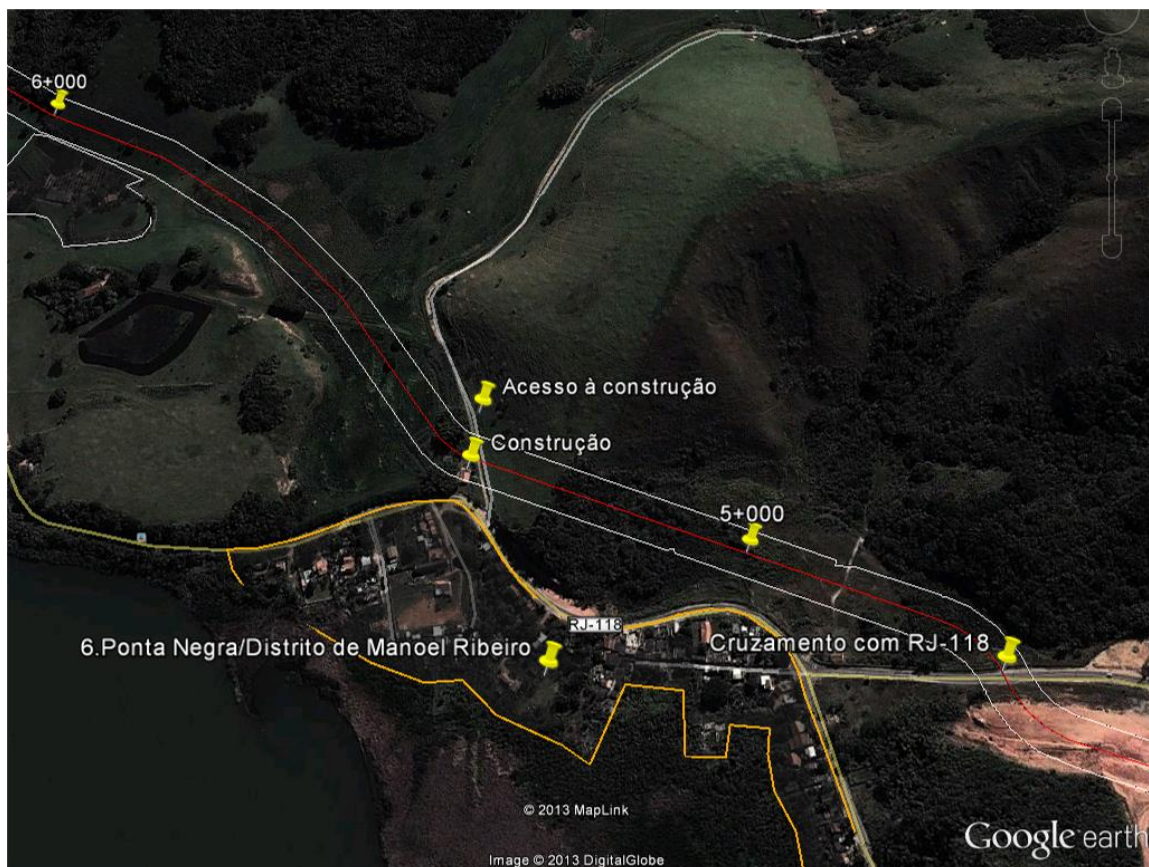
Figura 6.3.2.5-20 - Cruzamento do Gasoduto Rota 3 com acesso e com uma construção identificada na faixa de servidão.
