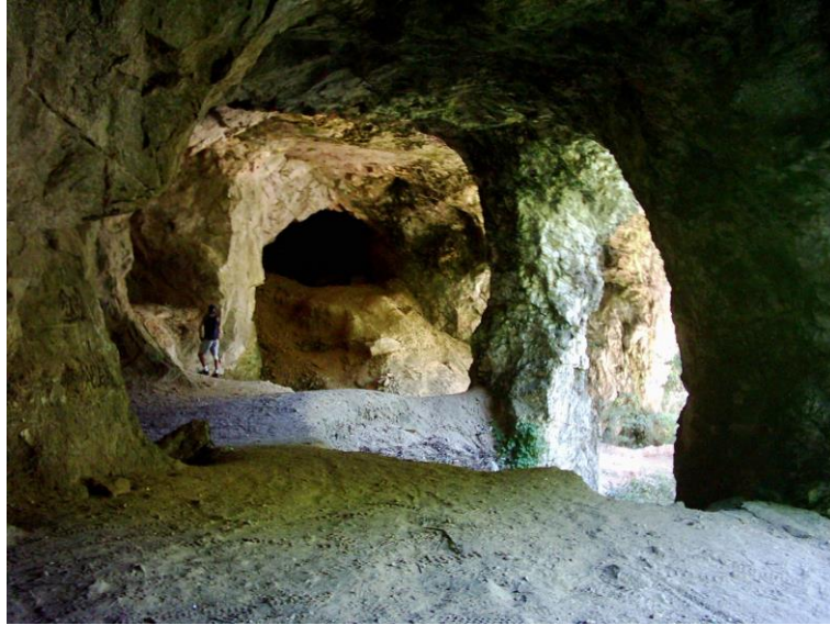
Figura 6.1.7-1 – Gruta SPAR, situada na localidade denominada Inoã, em Maricá, fora da AER do empreendimento, que são cavidades artificiais com pilares rochosos formadas pela extração de feldspato, que atualmente está paralisada.
