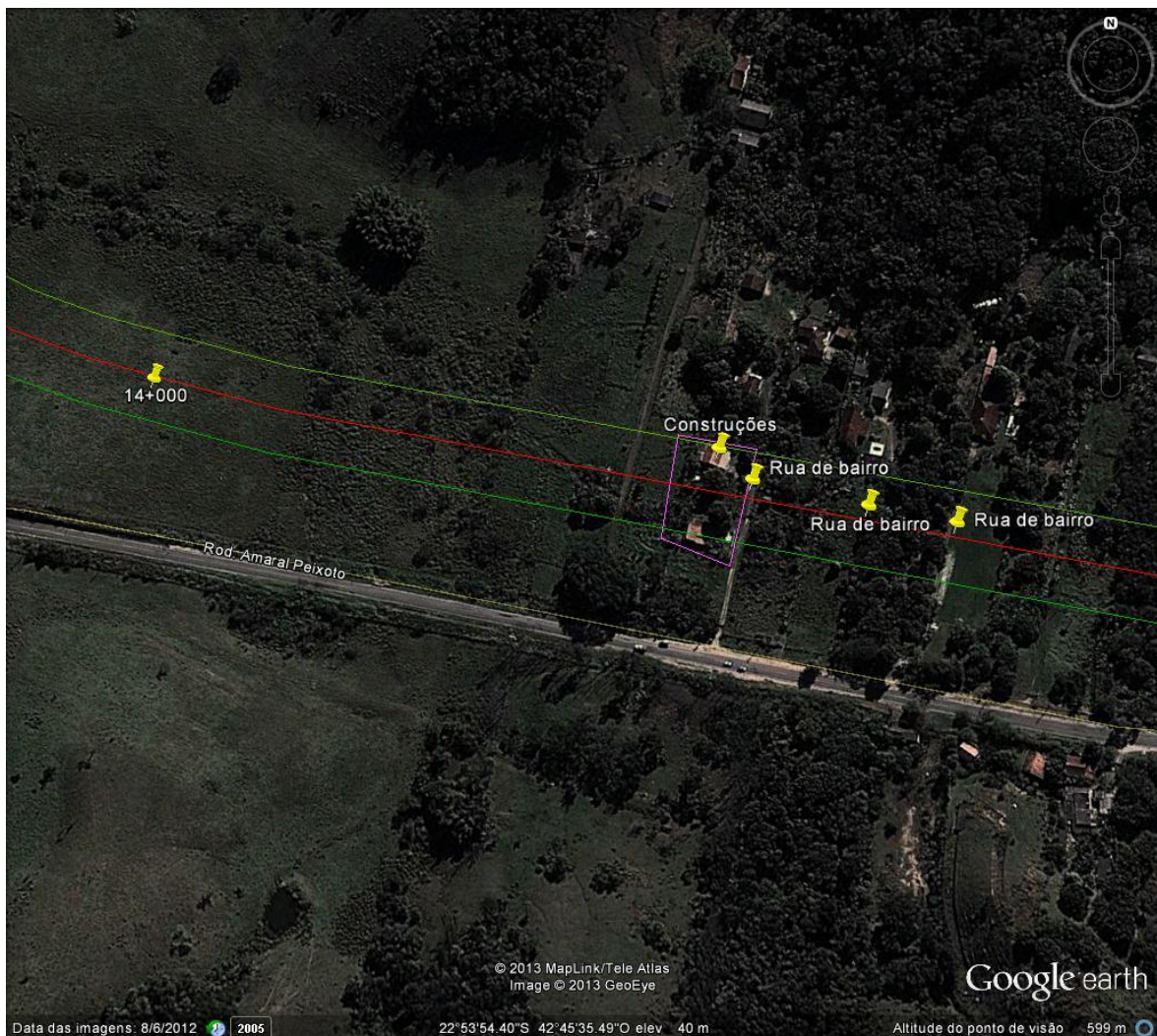
Figura 6.3.2.5-43 - Ruas de bairro e duas construções sendo interceptadas pelo Gasoduto Rota 3. Fonte: Google Earth, 2013.
