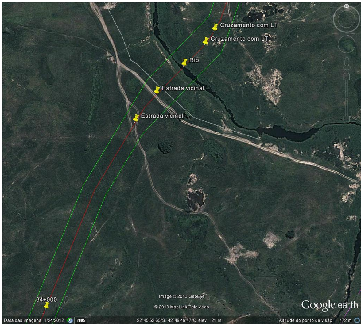
Figura 6.3.2.5-73 - Estradas vicinais (km 34,3), um Rio e duas linhas de transmissão (km 34,5 e 34,6) cruzando o Gasoduto Rota 3. Fonte: Google Earth, 2013.
