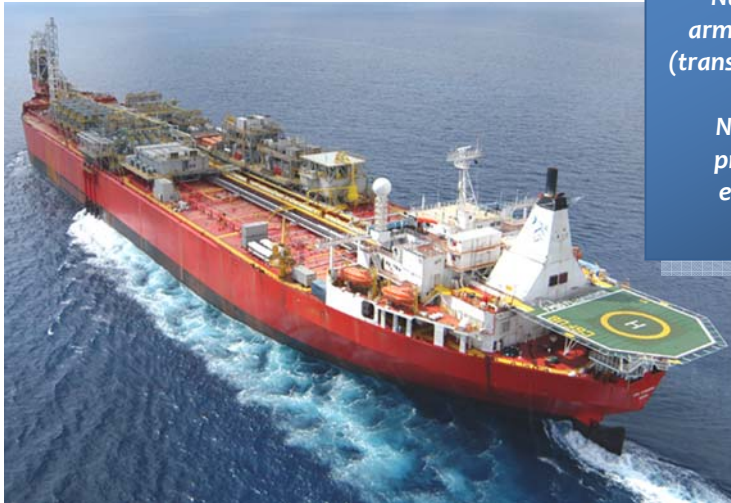
Figura 2 - Exemplo de navio-plataforma do tipo FPSO.
