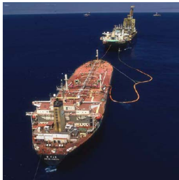
Figura 3 - Exemplo de operação de transferência de óleo de um navio-plataforma para um navio-aliviador.
