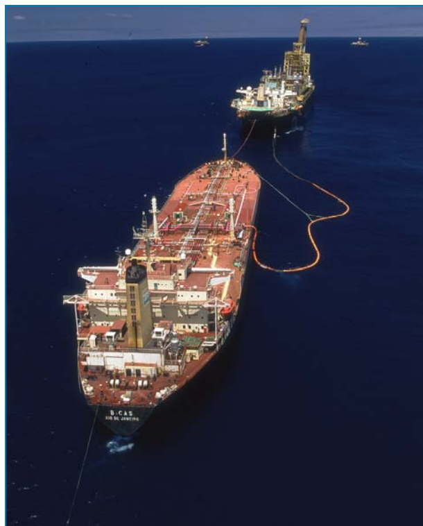
Figura II.2.4-4 - Exemplo de operação de transferência de óleo in tandem .
