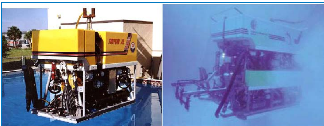
Figura II.2.4-15 - Foto ilustrativa de veículo de operação remota (ROV) antes de lançamento (à esquerda) e em operação (à direita).
