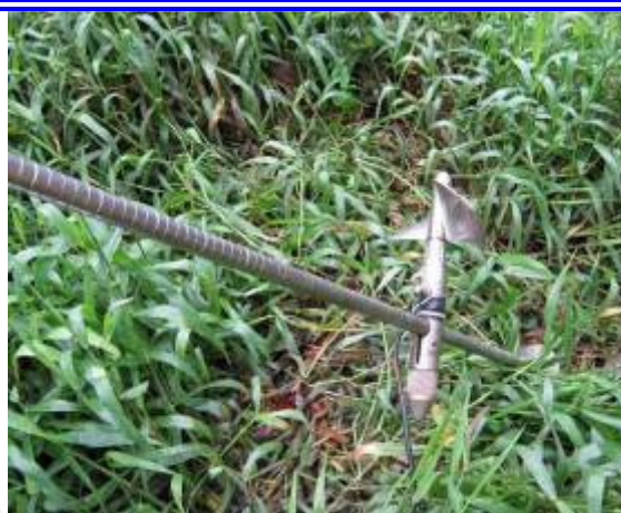
Foto II.3-1 - Molinete fluviométrico preso à haste para medição a vazão
