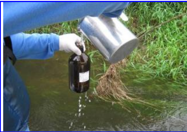
Foto II.2.1-1 - Coletor de aço inox utilizado para coleta de amostras de água superficial
