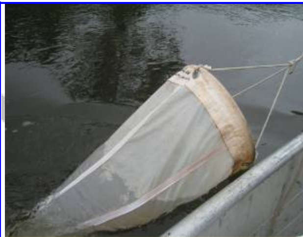
Foto II.2.1-2- Rede para coleta de fitoplâncton de 20 µm.
