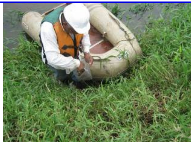
Foto II.3- 3 - Coleta de material da margem para ensaio de granulometria
