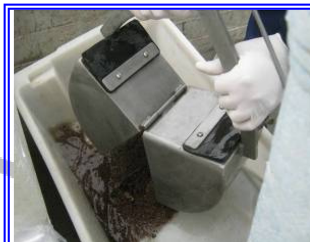
Foto II.2.2-1 – Draga do tipo Van Veen utilizada para coleta de amostras de sedimento e bentos.
