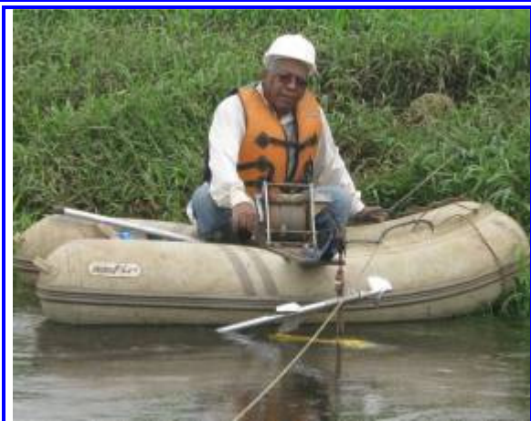
Foto II.3-2 - Medição de descarga líquida - barco preso ao cabo de aço medalhado, molinete e contador.
