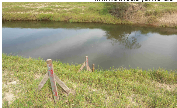
Figura III.24 Conjunto de réguas linimétricas junto ao Rio Camburu.
