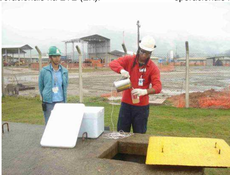
Figura III.7 Monitoramento efluentes da ETE ponto de entrada da ETE – equipe do laboratório contratado (EK)
