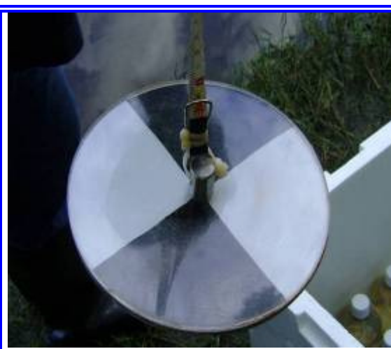
Foto II.2. 2-2 - Disco de Secchi
