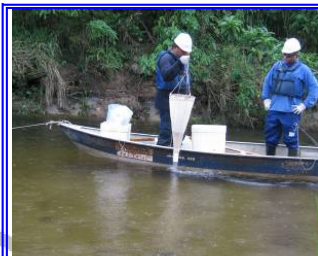
Foto II.2. 2-1 - Rede para coleta de fitoplâncton de 20 \mu m.
