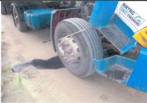
Foto 01 – Vazamento do caminhão
