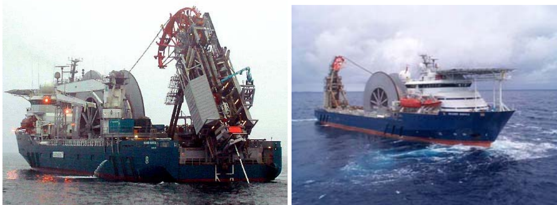
Figura II.2.4.2-23 - Embarcação a ser empregada nas atividades de instalação dos dutos – Skandi navica . Fonte: Petrobrás.
