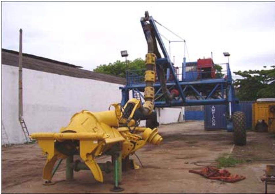
Figura II.2.4.2-35 - Máquina tipo PTM COMBO acoplada ao veículo anfíbio Tipo RACK. Fonte: Petrobrás.
