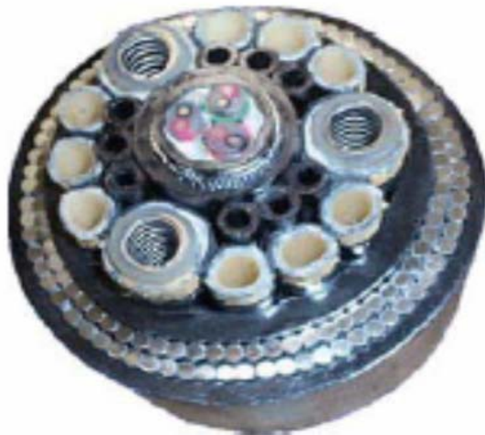
Figura II.2.4.2-14 - Foto representativa de um umbilical flexível.
