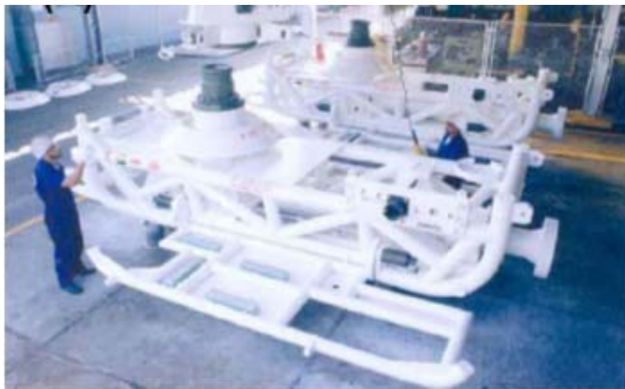
Figura II.2.4.2-15 - Foto ilustrativa de um elemento de interligação- PLE. Fonte: Petrobras.
