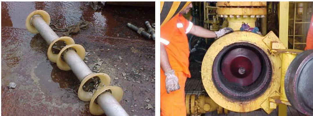
Figura II.2.4.2-20 - Ilustrações de raspadores e lançador/recebedor de pig utilizados em operações de limpeza. Fonte: Petrobrás.
