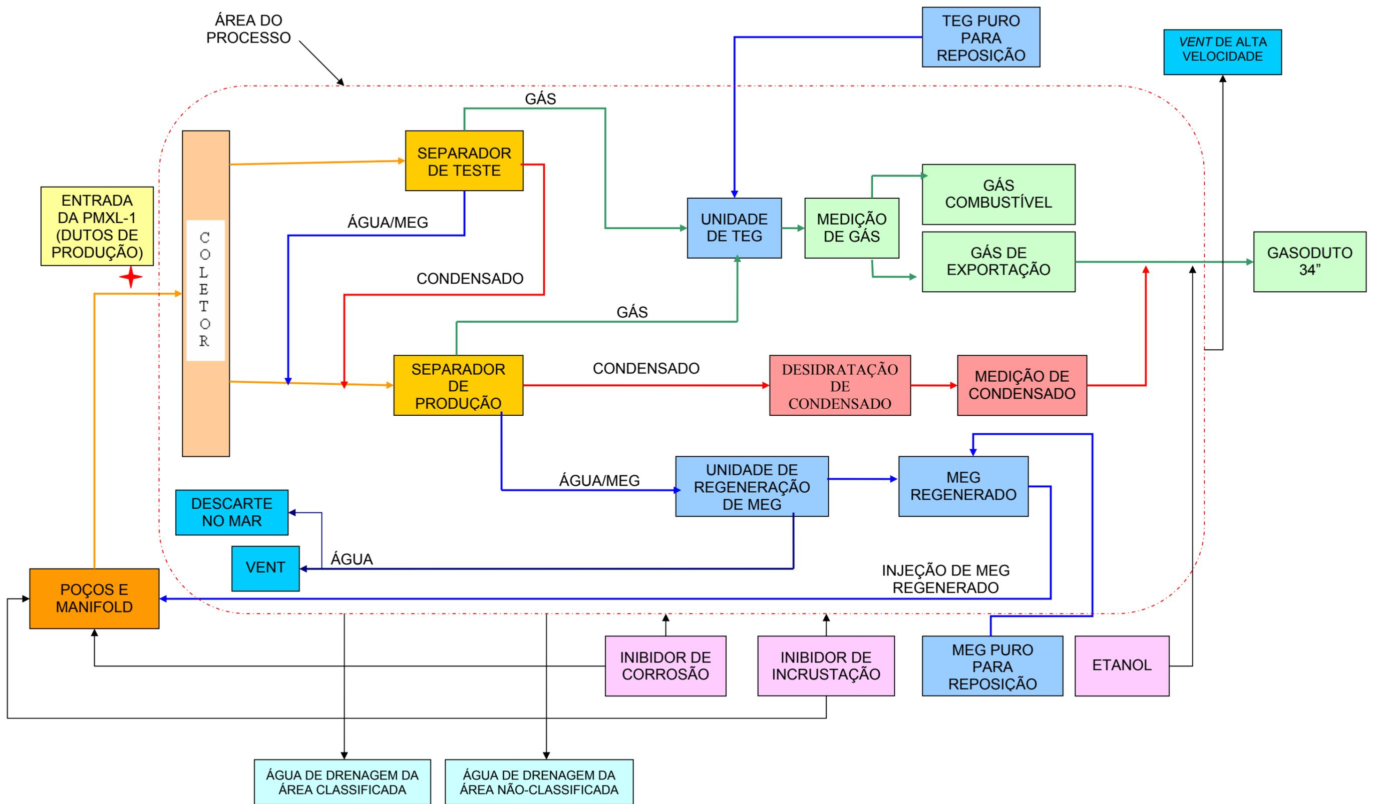
Figura II.2.4.2-3 - Fluxograma simplificado de processos da PMXL-1
