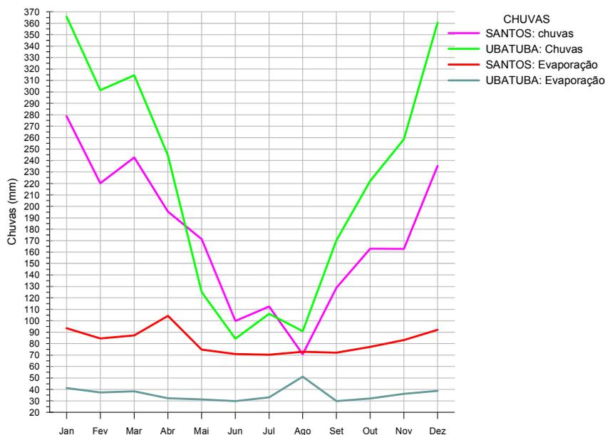
**Figura II.5.1.1-5** – Precipitações normais e taxas de evaporação nas áreas de influência direta e indireta da plataforma PXML-1. Estações meteorológicas de Santos e Ubatuba, período de 1961/1990.
