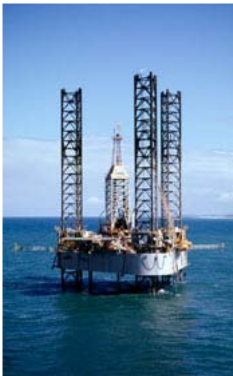
Figura II.3.1.1-2 - Ilustração de uma plataforma auto-elevável. Fonte: Petrobras
