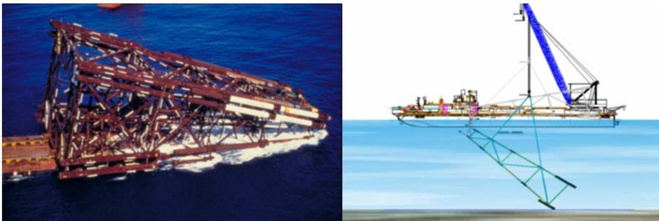
**Figura II.2.4.2-27 - Instalação da jaqueta metálica**
