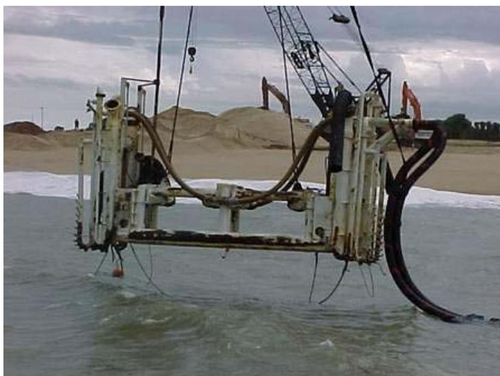
**Figura II.2.4.2-37 - Modelo de equipamento utilizado para jateamento hidráulico.**
