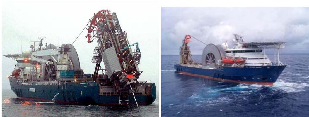
**Figura II.2.4.2-23 - Embarcação a ser empregada nas atividades de instalação dos dutos – Skandi navica.** Fonte: Petrobras
