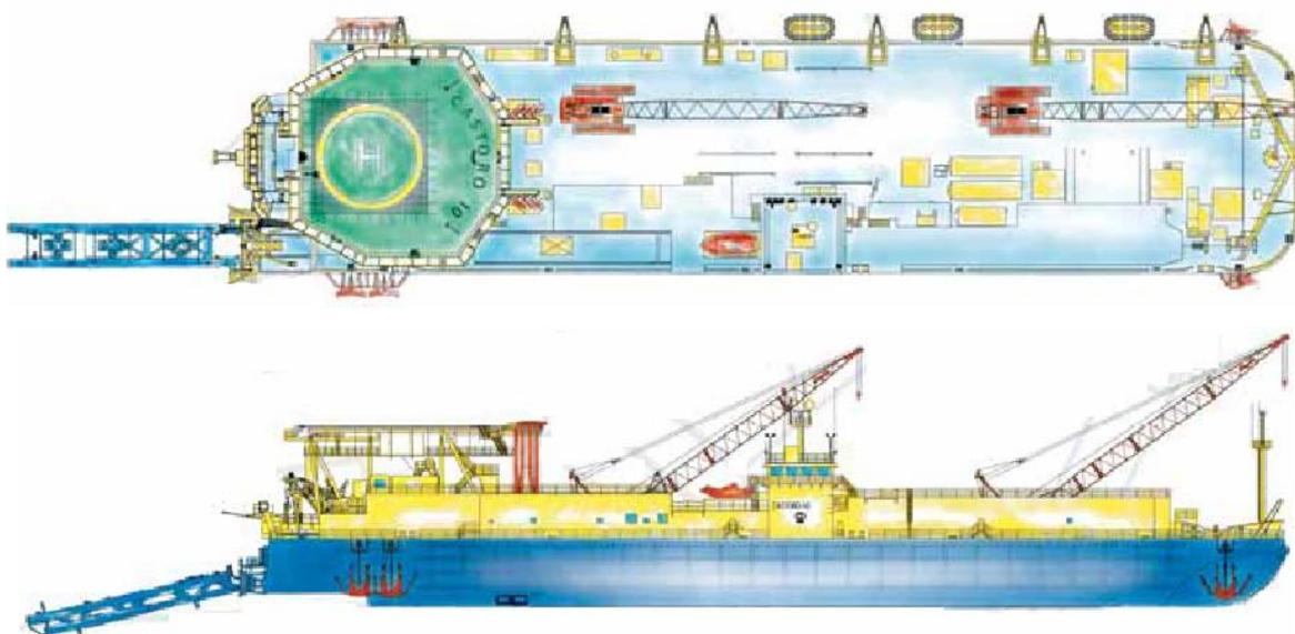
**Figura II.2.4.2-30** - Vista superior e lateral da embarcação de lançamento Castoro 10
