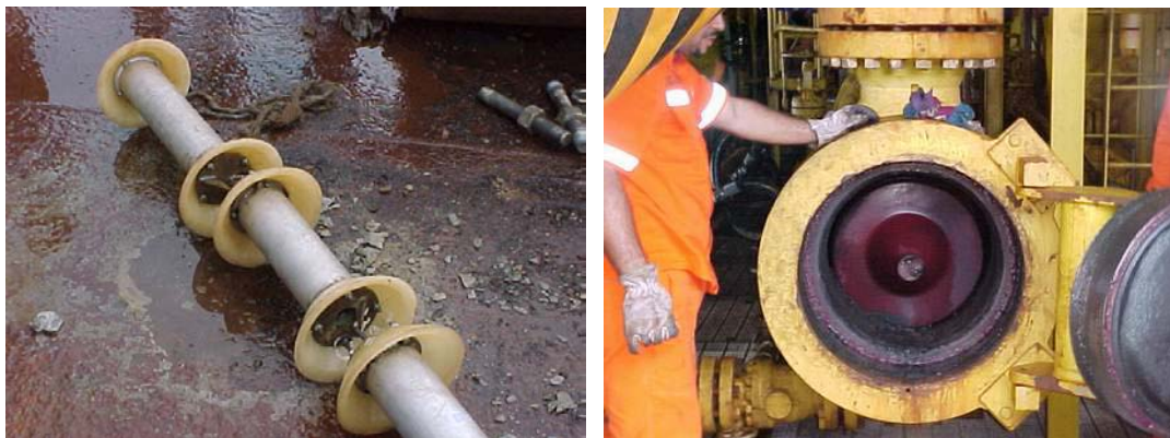
Figura II.2.4.2-20 - Ilustrações de raspadores e lançador/recebedor de pig utilizados em operações de limpeza. Fonte: Petrobras
