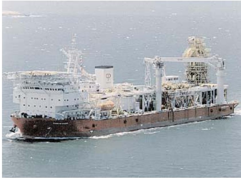
Figura II.2.4.2-4 - Foto do Sunrise 2000, para ilustrar o tipo de embarcação que pode ser utilizado na instalação das linhas de fluxo em Mexilhão e adjacências.
