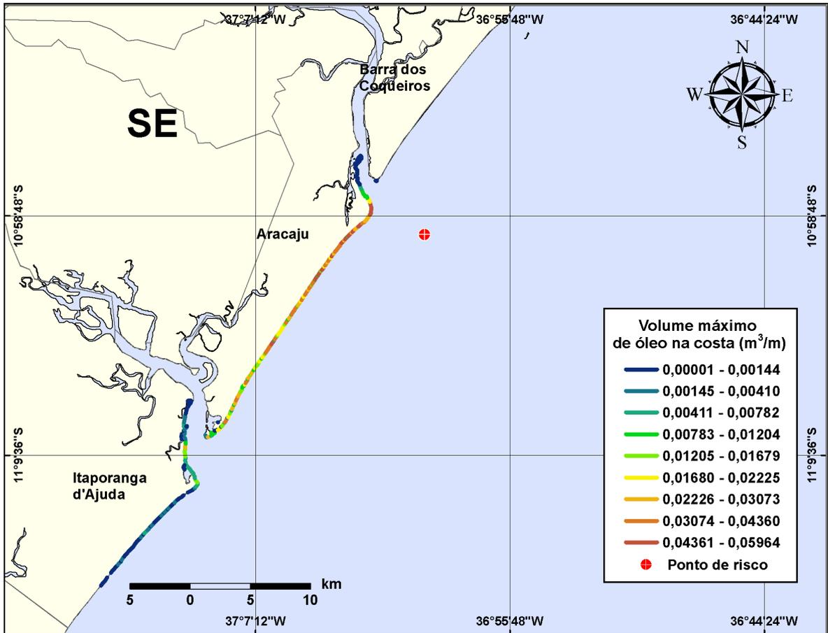
**Figura III-24** - Cenário PCM1\_VER\_207\_30D. (Fase: produção). Linhas de volume máximo de óleo na costa para um acidente com óleo tipo CAMORIM, ocorrendo no Ponto-PCM1, do Campo Camorim, durante os meses de verão (janeiro a março), com derrame de 207 m³ (instantâneo), após 30 dias de simulação.
