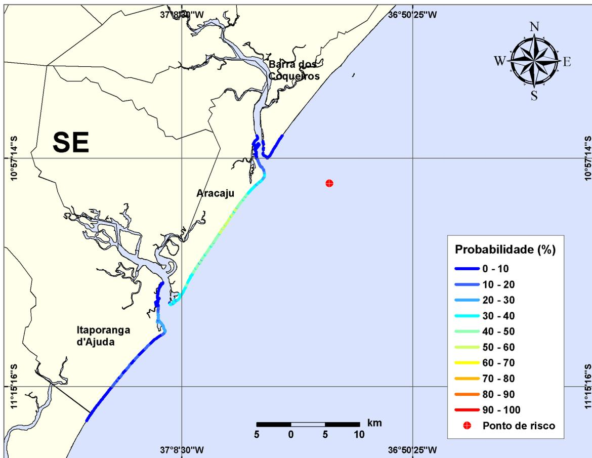
**Figura III-35** - Cenário PCM9\_VER\_200\_30D. (Fase: instalação). Linhas de probabilidade de óleo na costa para um acidente com óleo tipo CAMORIM, ocorrendo no Ponto-PCM9, do Campo Camorim, durante os meses de verão (janeiro a março), com derrame de 200 m<sup>3</sup> (instantâneo), após 30 dias de simulação.
