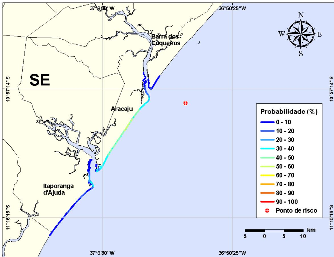
**Figura III-31** - Cenário PCM9\_VER\_8\_30D. (Fase: instalação/produção). Linhas de probabilidade de óleo na costa para um acidente com óleo tipo CAMORIM, ocorrendo no Ponto-PCM9, do Campo Camorim, durante os meses de verão (janeiro a março), com derrame de 8 m<sup>3</sup> (instantâneo), após 30 dias de simulação.
