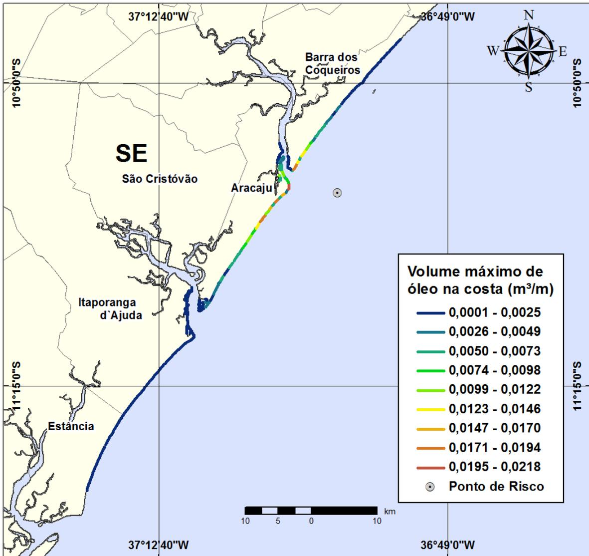
**Figura III-88** - Cenário CM10\_INV\_420\_60D. (Fase: produção). Linhas de volume máximo de óleo na costa para um acidente com óleo tipo CAMORIM, ocorrendo no Ponto-CM10, do Campo Camorim, durante os meses de inverno (junho a agosto), com derrame de 420 m<sup>3</sup> (ao longo de 30 dias), após 60 dias de simulação.
