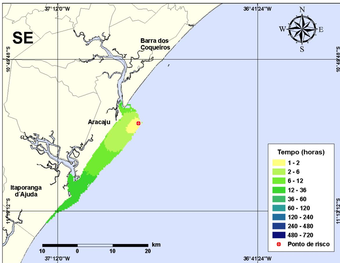
**Figura III-14** - Cenário PCM1\_VER\_8\_30D. (Fase: produção). Contornos de deslocamento de óleo na água para um acidente com óleo tipo CAMORIM, ocorrendo no Ponto-PCM1, do Campo Camorim, durante os meses de verão (janeiro a março), com derrame de 8 m<sup>3</sup> (instantâneo), após 30 dias de simulação.
