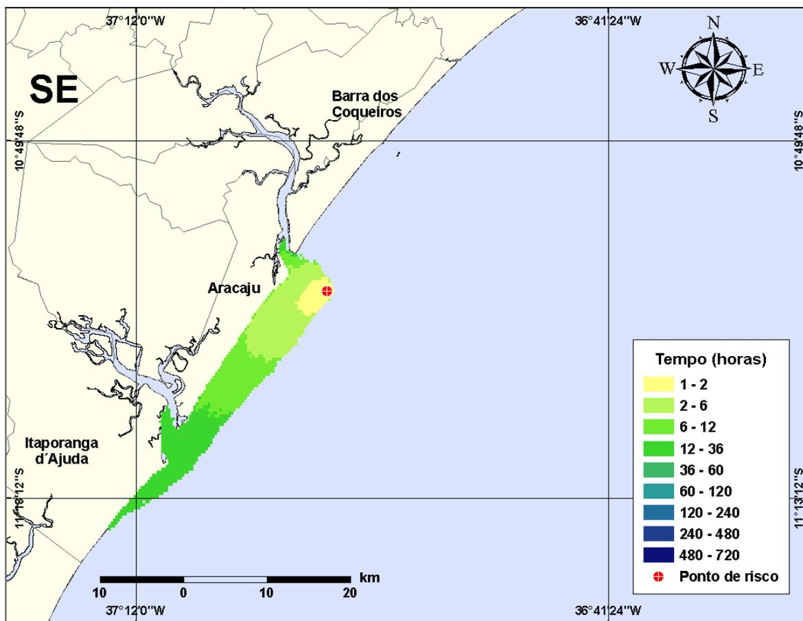
**Figura III-22** - Cenário PCM1\_VER\_207\_30D. (Fase: produção). Contornos de deslocamento de óleo na água para um acidente com óleo tipo CAMORIM, ocorrendo no Ponto-PCM1, do Campo Camorim, durante os meses de verão (janeiro a março), com derrame de 207 m<sup>3</sup> (instantâneo), após 30 dias de simulação.
