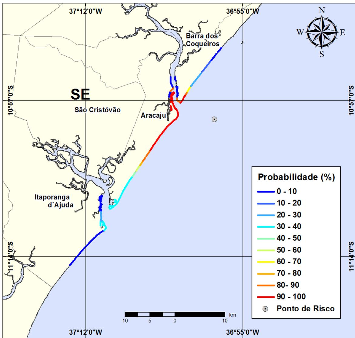
**Figura III-43** - Cenário CM10\_VER\_420\_60D. (Fase: produção). Linhas de probabilidade de óleo na costa para um acidente com óleo tipo CAMORIM, ocorrendo no Ponto-CM10, do Campo Camorim, durante os meses de verão (janeiro a março), com derrame de 420 m<sup>3</sup> (ao longo de 30 dias), após 60 dias de simulação.
