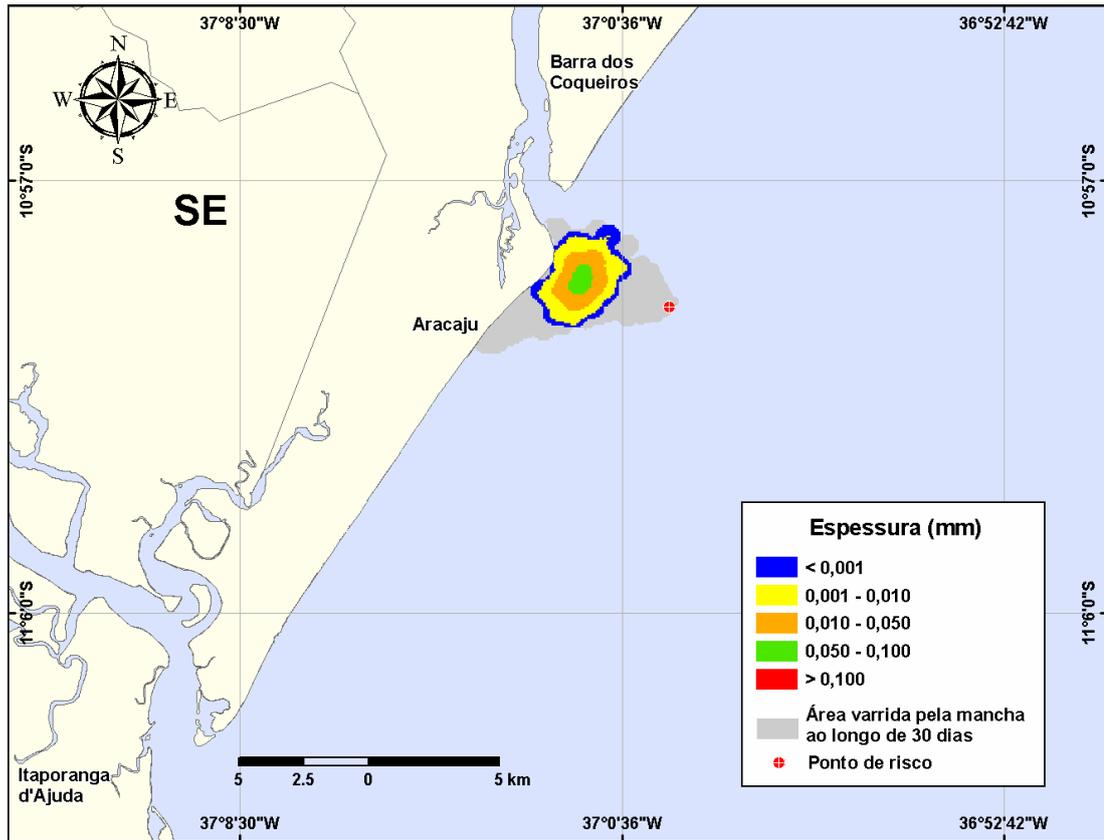
**Figura III-98** - DET\_PCM1\_200\_INV\_30D. Cenário determinístico crítico para um derrame ocorrido durante o inverno com óleo cru, a partir do Ponto-PCM1 no Campo Camorim.
