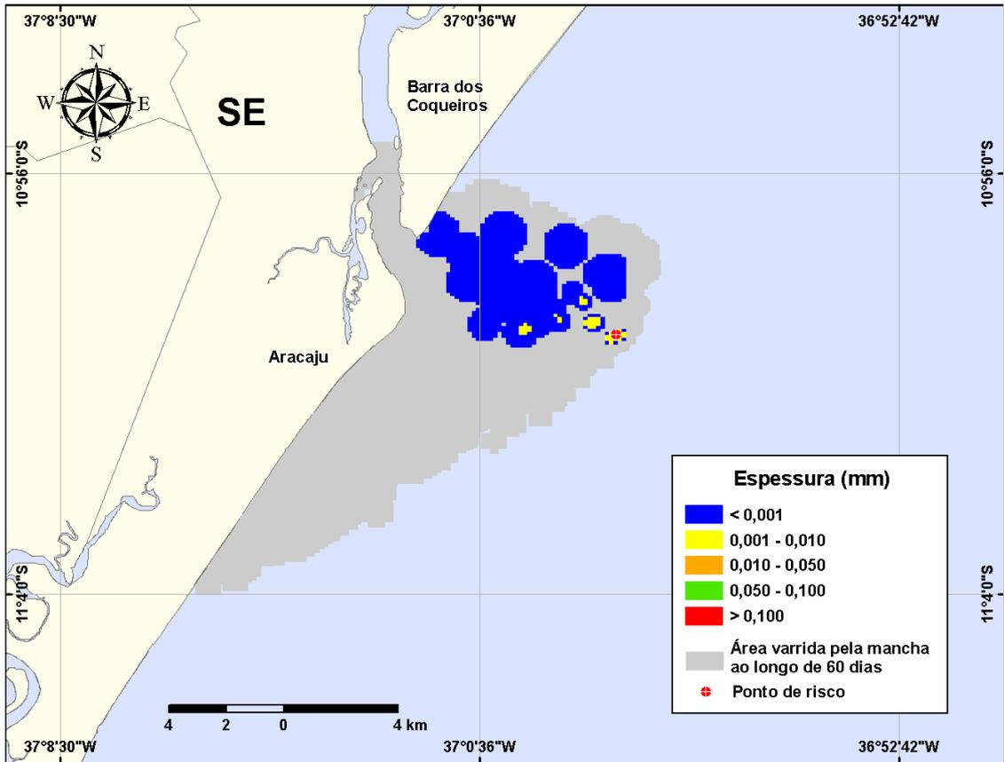
**Figura III-103** - DET\_FREQ\_CM10\_VER\_420\_60D. Cenário determinístico para a condição mais frequente, para um derrame ocorrido durante o verão com óleo cru a partir do Ponto-CM10 no Campo Camorim.
