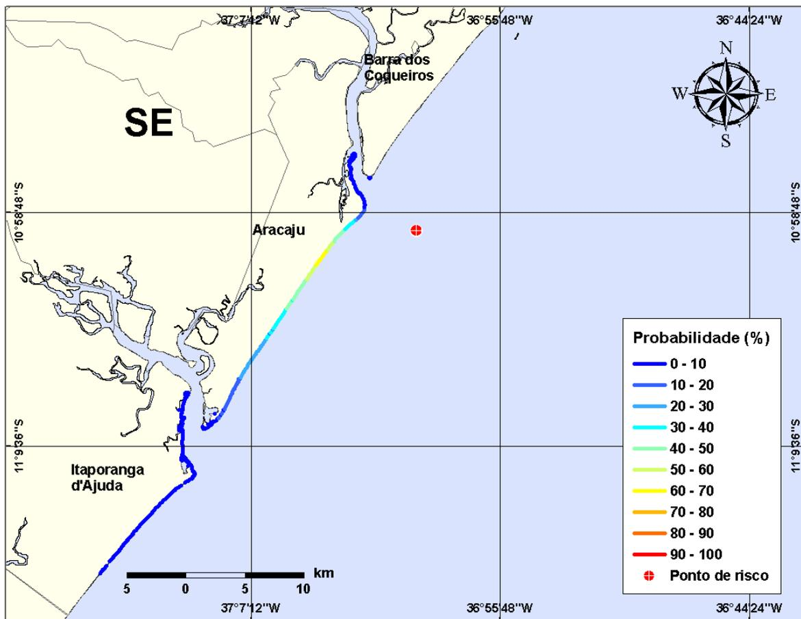
**Figura III-23** - Cenário PCM1\_VER\_207\_30D. (Fase: produção). Linhas de probabilidade de óleo na costa para um acidente com óleo tipo CAMORIM, ocorrendo no Ponto-PCM1, do Campo Camorim, durante os meses de verão (janeiro a março), com derrame de 207 m<sup>3</sup> (instantâneo), após 30 dias de simulação.
