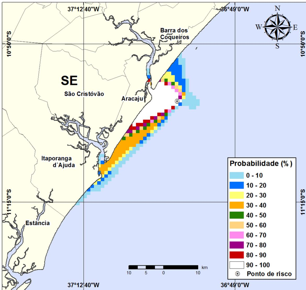
**Figura III-41** - Cenário CM10\_VER\_420\_60D. (Fase: produção). Contornos de probabilidade de óleo na água para um acidente com óleo tipo CAMORIM, ocorrendo no Ponto-CM10, do Campo Camorim, durante os meses de verão (janeiro a março), com derrame de 420 m<sup>3</sup> (ao longo de 30 dias), após 60 dias de simulação.
