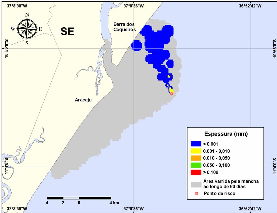
**Figura III-105** - DET\_FREQ\_CM10\_INV\_420\_60D. Cenário determinístico para a condição mais frequente, para um derrame ocorrido durante o inverno com óleo cru, a partir do Ponto-CM10 no Campo Camorim.
