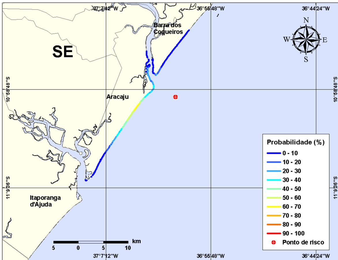
**Figura III-67** - Cenário PCM1\_INV\_207\_30D. (Fase: produção). Linhas de probabilidade de óleo na costa para um acidente com óleo tipo CAMORIM, ocorrendo no Ponto-PCM1, do Campo Camorim, durante os meses de inverno (junho a agosto), com derrame de 207 m<sup>3</sup> (instantâneo), após 30 dias de simulação.
