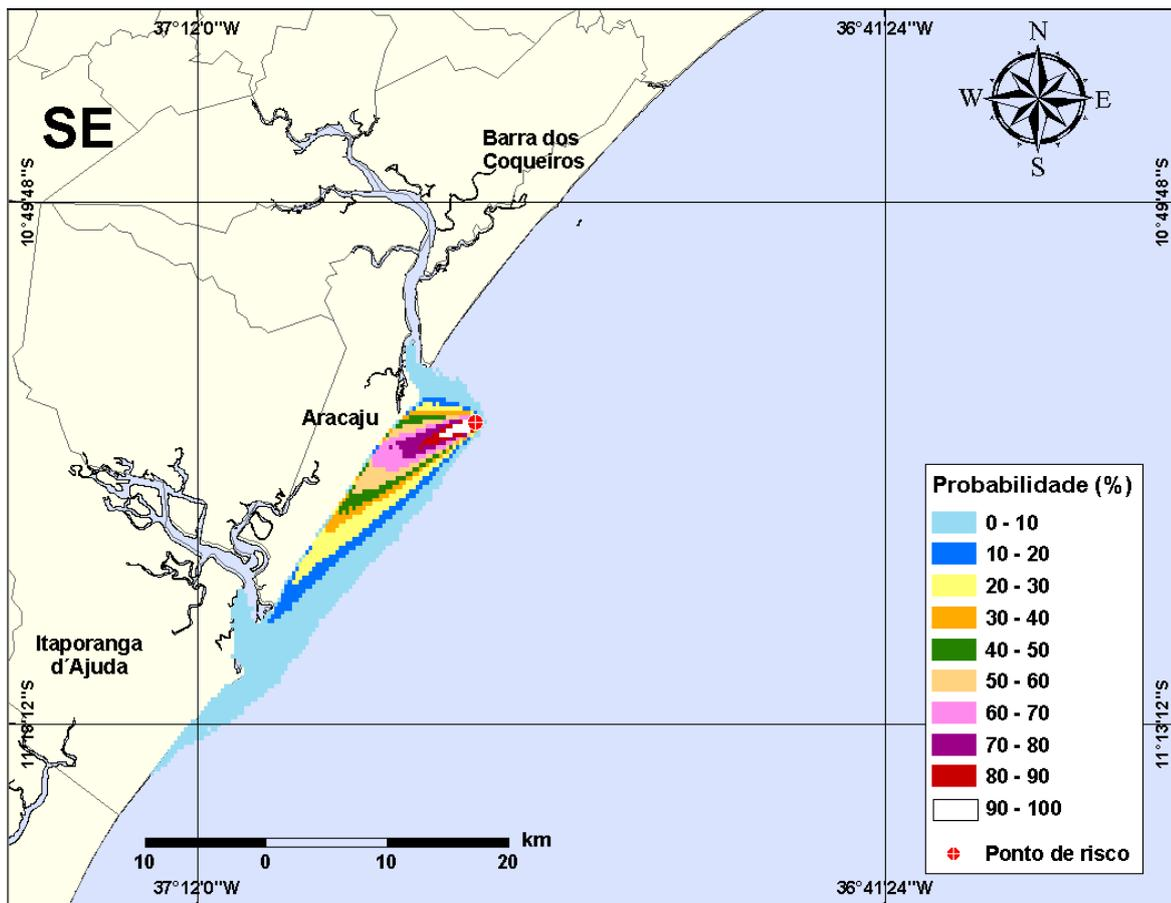
**Figura III-21** - Cenário PCM1\_VER\_207\_30D. (Fase: produção). Contornos de probabilidade de óleo na água para um acidente com óleo tipo CAMORIM, ocorrendo no Ponto-PCM1, do Campo Camorim, durante os meses de verão (janeiro a março), com derrame de 207 m<sup>3</sup> (instantâneo), após 30 dias de simulação.
