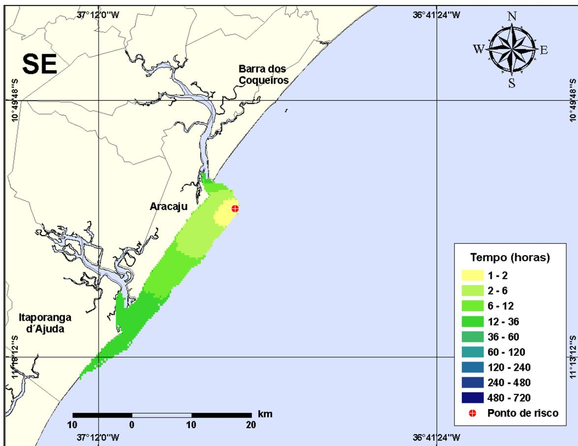
**Figura III-18** - Cenário PCM1\_VER\_200\_30D. (Fase: produção). Contornos de deslocamento de óleo na água para um acidente com óleo tipo CAMORIM, ocorrendo no Ponto-PCM1, do Campo Camorim, durante os meses de verão (janeiro a março), com derrame de 200 m<sup>3</sup> (instantâneo), após 30 dias de simulação.
