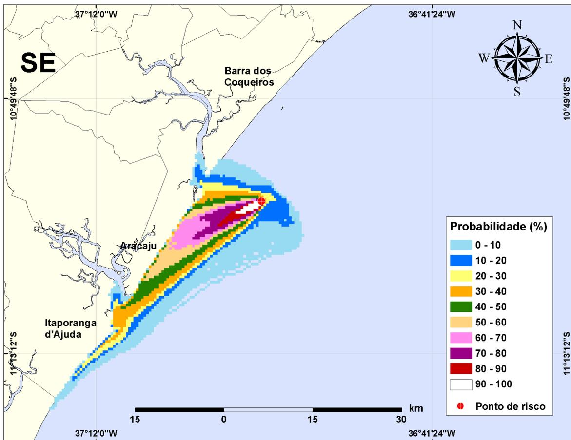
**Figura III-37** - Cenário PCM9\_VER\_248\_30D. (Fase: produção). Contornos de probabilidade de óleo na água para um acidente com óleo tipo CAMORIM, ocorrendo no Ponto-PCM9, do Campo Camorim, durante os meses de verão (janeiro a março), com derrame de 248 m<sup>3</sup> (instantâneo), após 30 dias de simulação.
