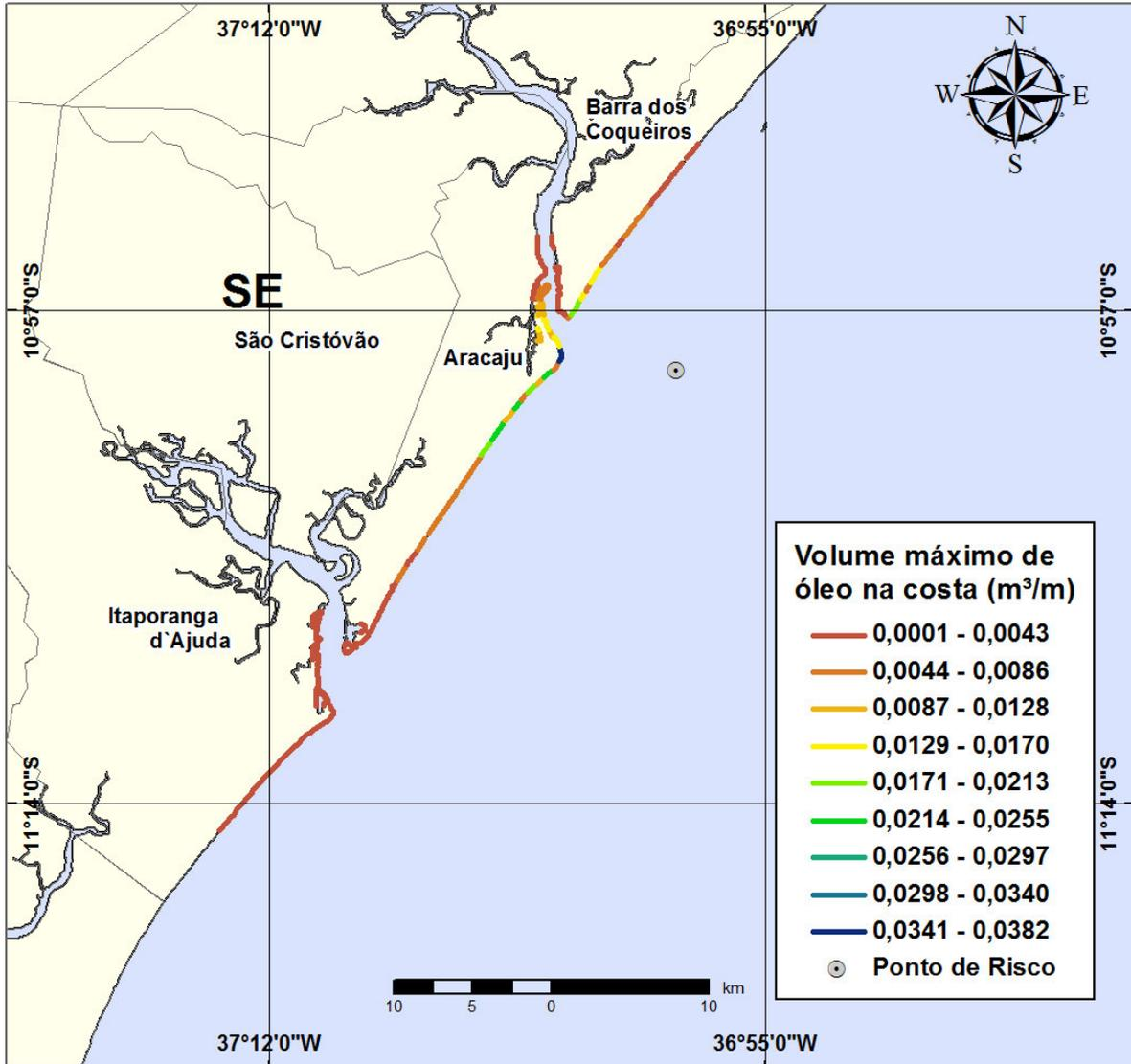
**Figura III-44** - Cenário CM10\_VER\_420\_60D. (Fase: produção). Linhas de volume máximo de óleo na costa para um acidente com óleo tipo CAMORIM, ocorrendo no Ponto-CM10, do Campo Camorim, durante os meses de verão (janeiro a março), com derrame de 420 m<sup>3</sup> (ao longo de 30 dias), após 60 dias de simulação.
