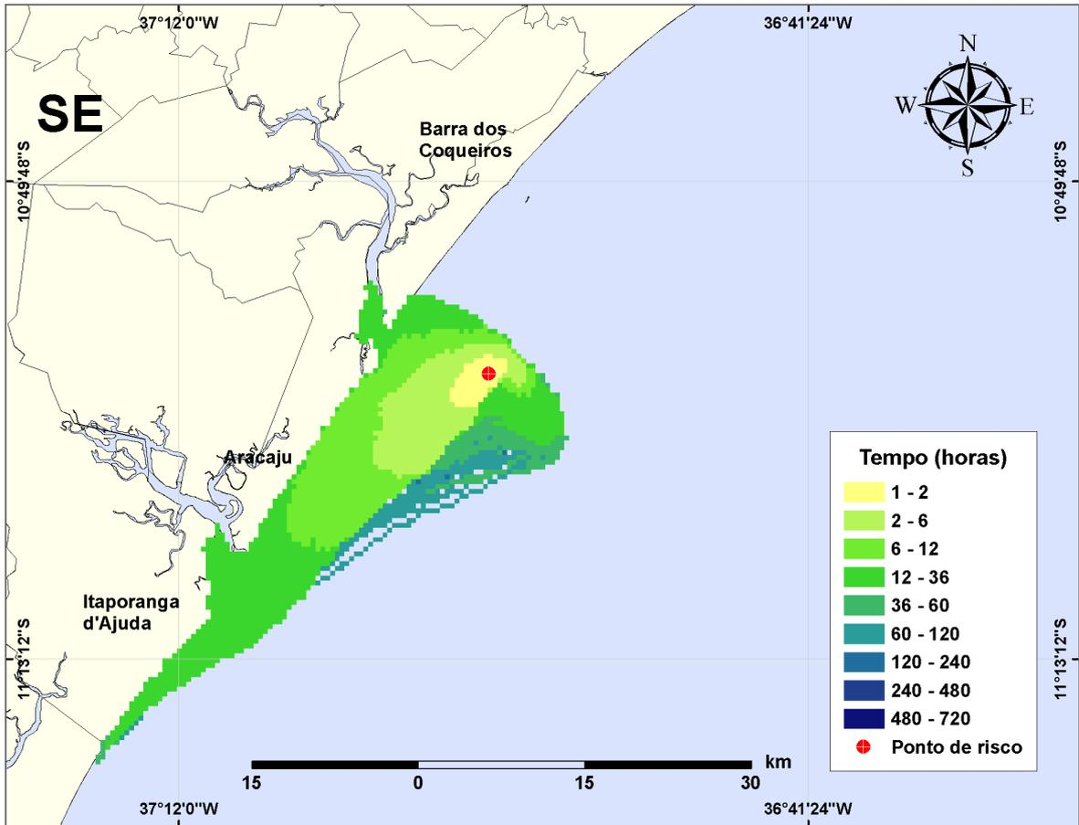
**Figura III-38** - Cenário PCM9\_VER\_248\_30D. (Fase: produção). Contornos de deslocamento de óleo na água para um acidente com óleo tipo CAMORIM, ocorrendo no Ponto-PCM9, do Campo Camorim, durante os meses de verão (janeiro a março), com derrame de 248 m<sup>3</sup> (instantâneo), após 30 dias de simulação.
