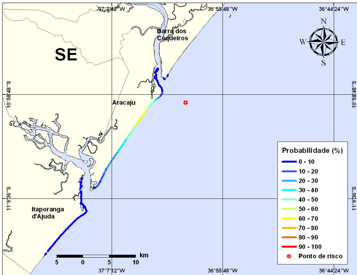
**Figura III-15** - Cenário PCM1\_VER\_8\_30D. (Fase: produção). Linhas de probabilidade de óleo na costa para um acidente com óleo tipo CAMORIM, ocorrendo no Ponto-PCM1, do Campo Camorim, durante os meses de verão (janeiro a março), com derrame de 8 m<sup>3</sup> (instantâneo), após 30 dias de simulação.
