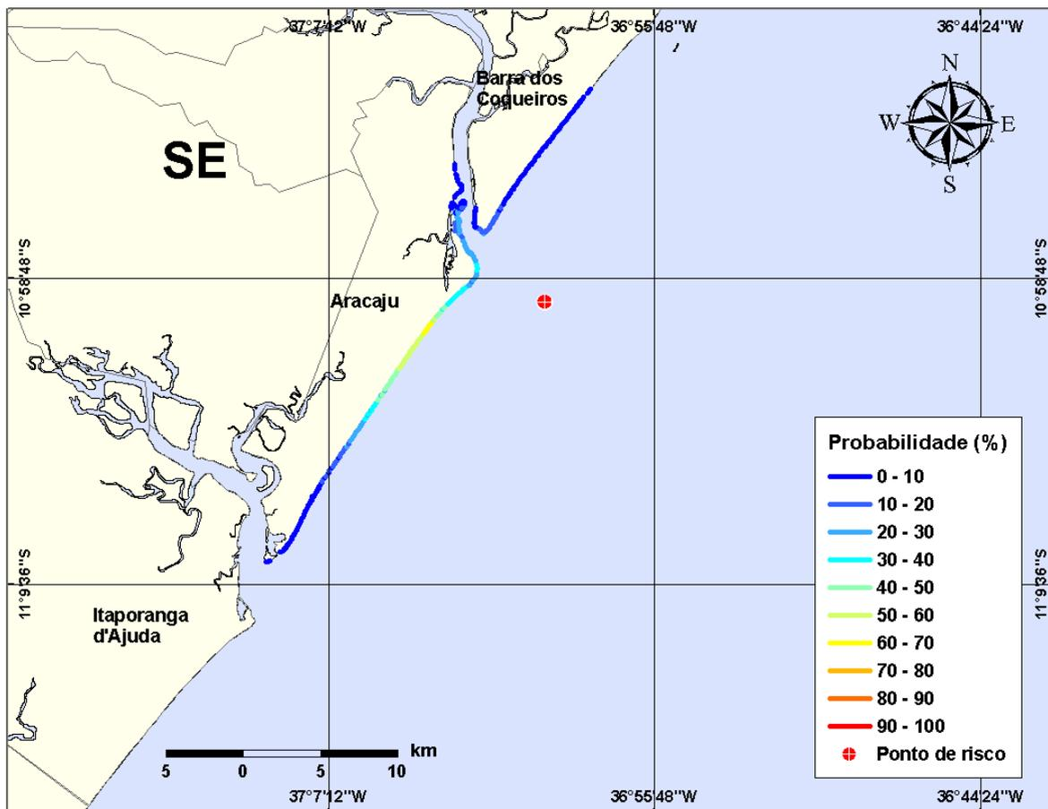
**Figura III-63** - Cenário PCM1\_INV\_200\_30D. (Fase: produção). Linhas de probabilidade de óleo na costa para um acidente com óleo tipo CAMORIM, ocorrendo no Ponto-PCM1, do Campo Camorim, durante os meses de inverno (junho a agosto), com derrame de 200 m<sup>3</sup> (instantâneo), após 30 dias de simulação.
