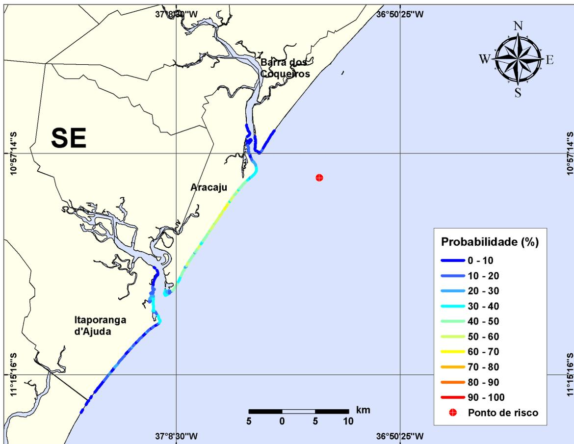
**Figura III-39** - Cenário PCM9\_VER\_248\_30D. (Fase: produção). Linhas de probabilidade de óleo na costa para um acidente com óleo tipo CAMORIM, ocorrendo no Ponto-PCM9, do Campo Camorim, durante os meses de verão (janeiro a março), com derrame de 248 m<sup>3</sup> (instantâneo), após 30 dias de simulação.
