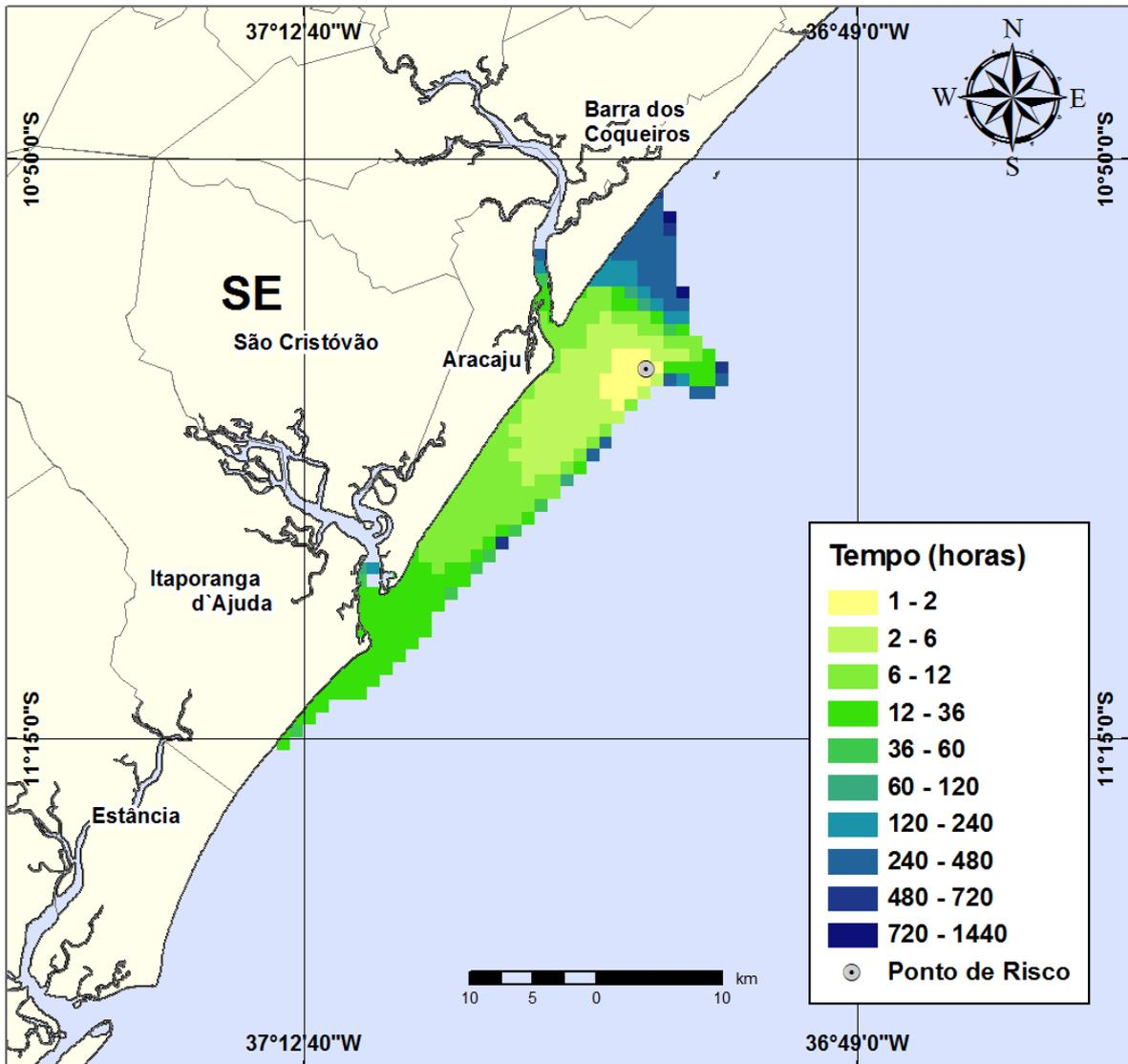
**Figura III-42** - Cenário CM10\_VER\_420\_30D. (Fase: produção). Contornos de deslocamento de óleo na água para um acidente com óleo tipo CAMORIM, ocorrendo no Ponto-CM10, do Campo Camorim, durante os meses de verão (janeiro a março), com derrame de 420 m<sup>3</sup> (ao longo de 30 dias), após 60 dias de simulação.
