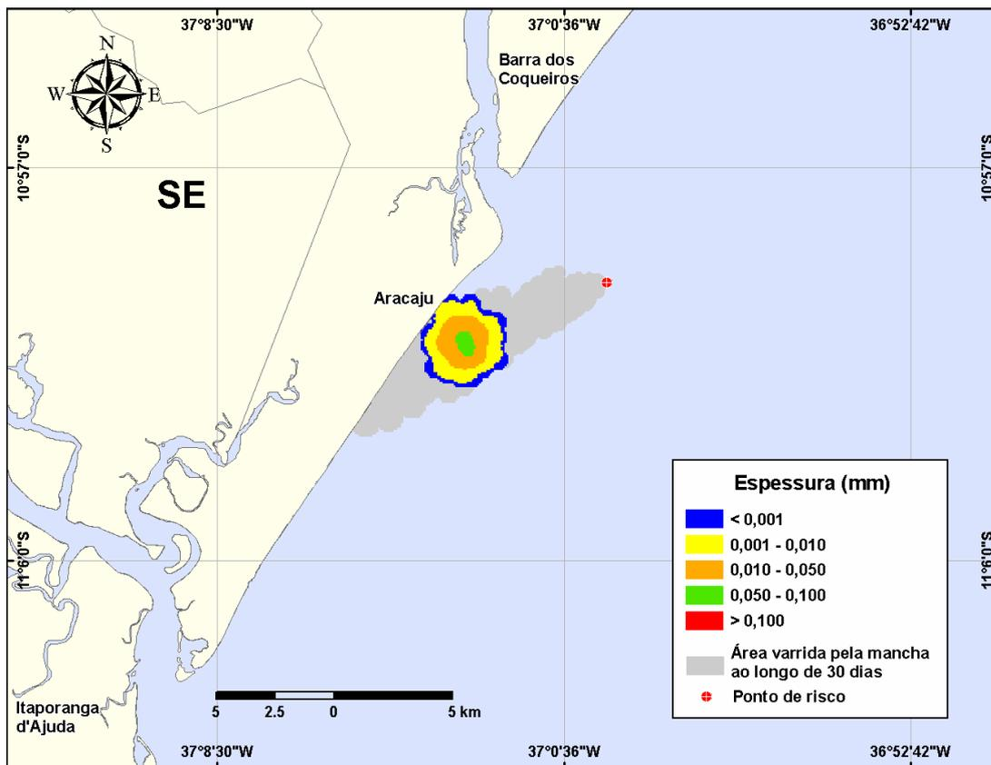
**Figura III-91** - DET\_PCM1\_200\_VER\_30D. Cenário determinístico crítico para um derrame ocorrido durante o verão com óleo cru, a partir do Ponto PCM1 no Campo Camorim.
