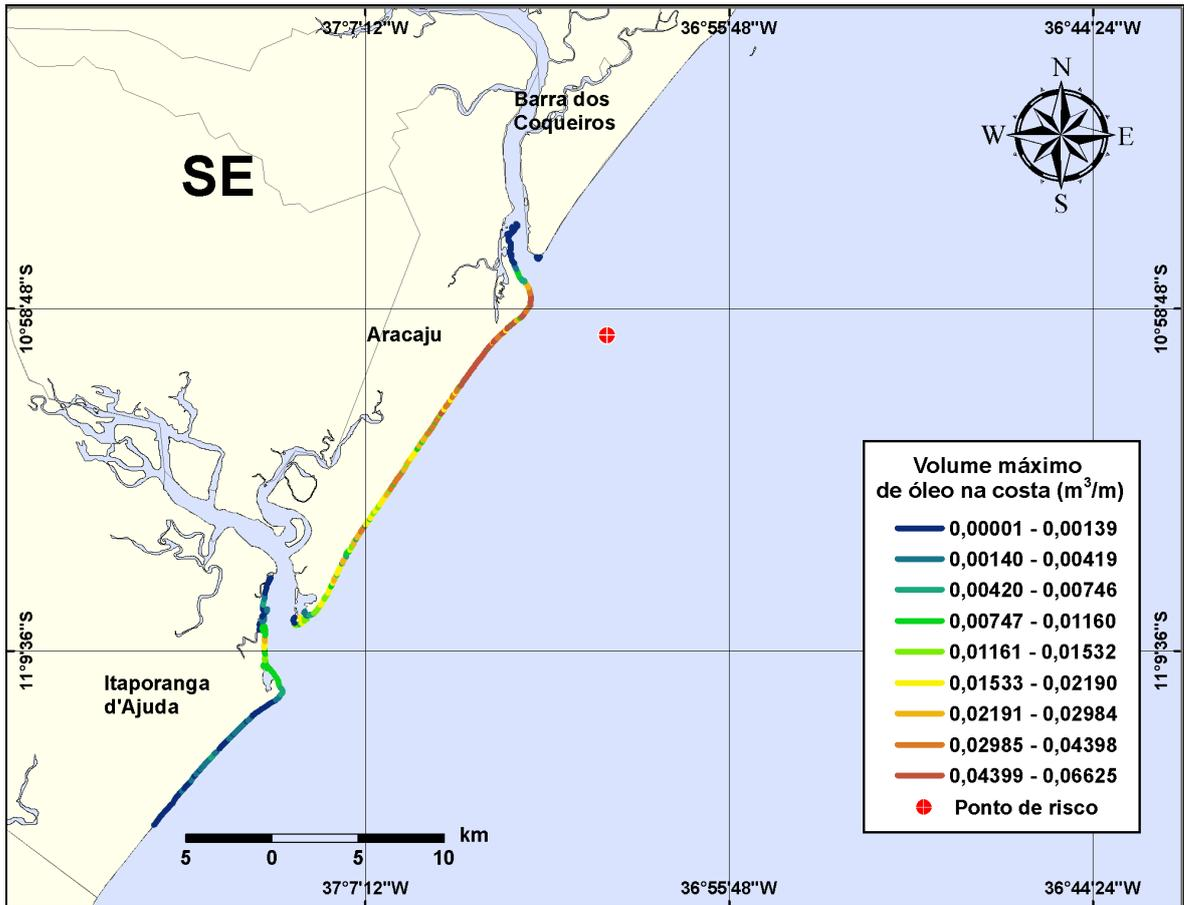
**Figura III-20** - Cenário PCM1\_VER\_200\_30D. (Fase: produção). Linhas de volume máximo de óleo na costa para um acidente com óleo tipo CAMORIM, ocorrendo no Ponto-PCM1, do Campo Camorim, durante os meses de verão (janeiro a março), com derrame de 200 m<sup>3</sup> (instantâneo), após 30 dias de simulação.
