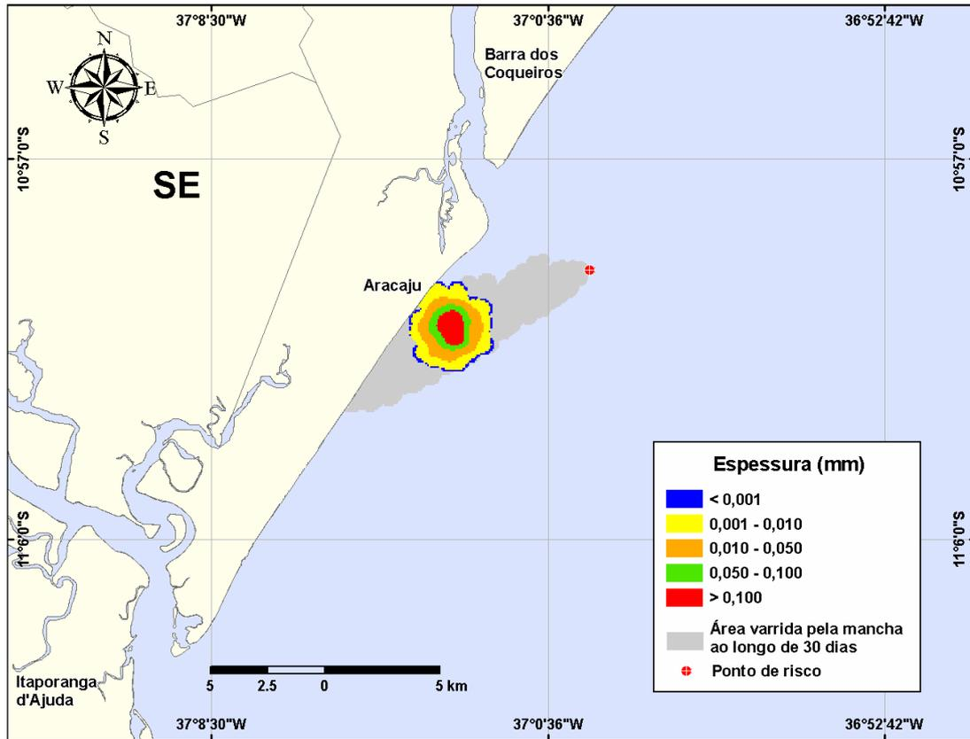
Figura III-89 - DET\_PCM1\_DIESEL\_VER\_500\_30D. Cenário determinístico crítico para um derrame ocorrido durante o verão com óleo DIESEL, a partir do Ponto PCM1 no Campo Camorim.
