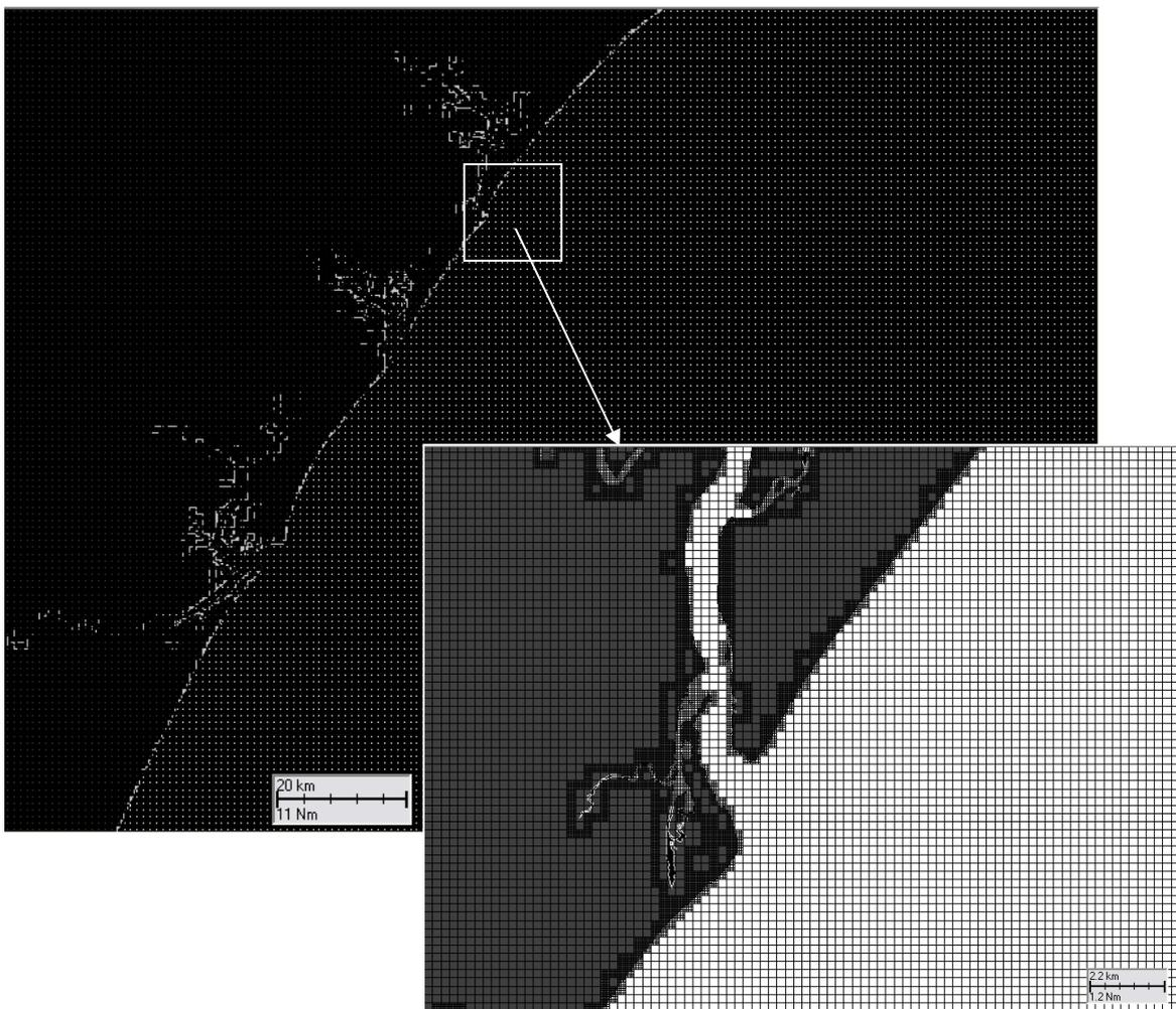
**Figura II-8** - Grade definindo os contornos de terra (grade land-water) para a modelagem de deriva de óleo no Campo Camorim.
