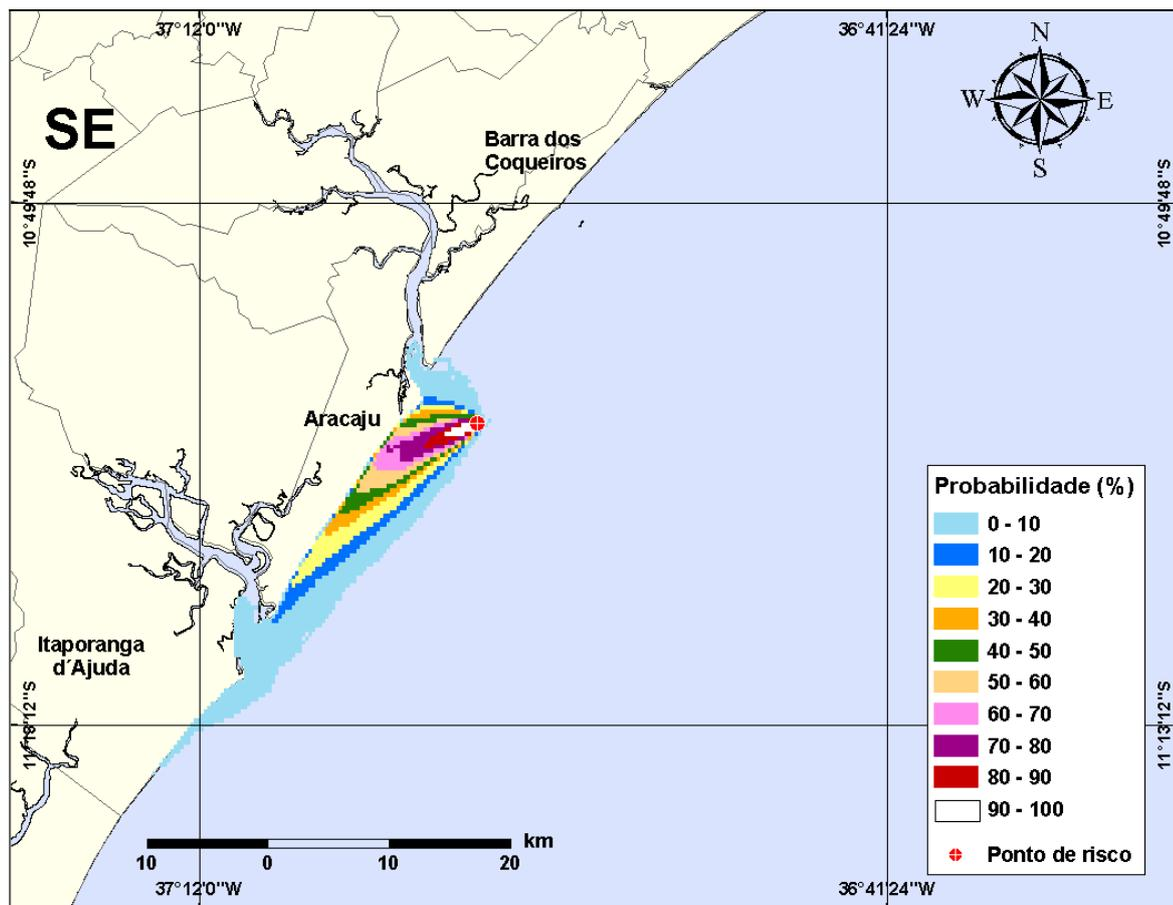
**Figura III-13** - Cenário PCM1\_VER\_8\_30D. (Fase: produção). Contornos de probabilidade de óleo na água para um acidente com óleo tipo CAMORIM, ocorrendo no Ponto-PCM1, do Campo Camorim, durante os meses de verão (janeiro a março), com derrame de 8 m<sup>3</sup> (instantâneo), após 30 dias de simulação.
