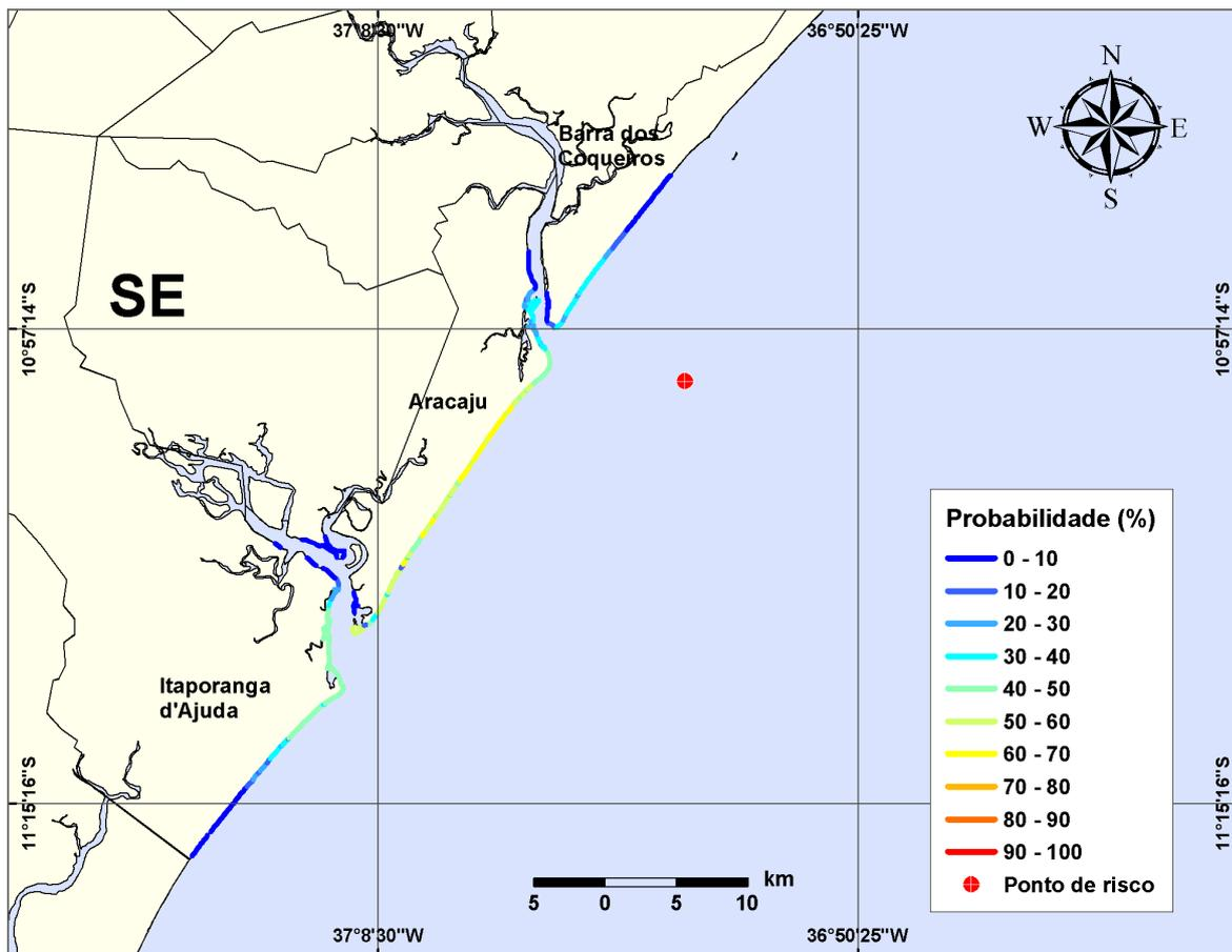
**Figura III-83** - Cenário PCM9\_INV\_248\_30D. (Fase: produção). Linhas de probabilidade de óleo na costa para um acidente com óleo tipo CAMORIM, ocorrendo no Ponto-PCM9, do Campo Camorim, durante os meses de inverno (junho a agosto), com derrame de 248 m<sup>3</sup> (instantâneo), após 30 dias de simulação.
