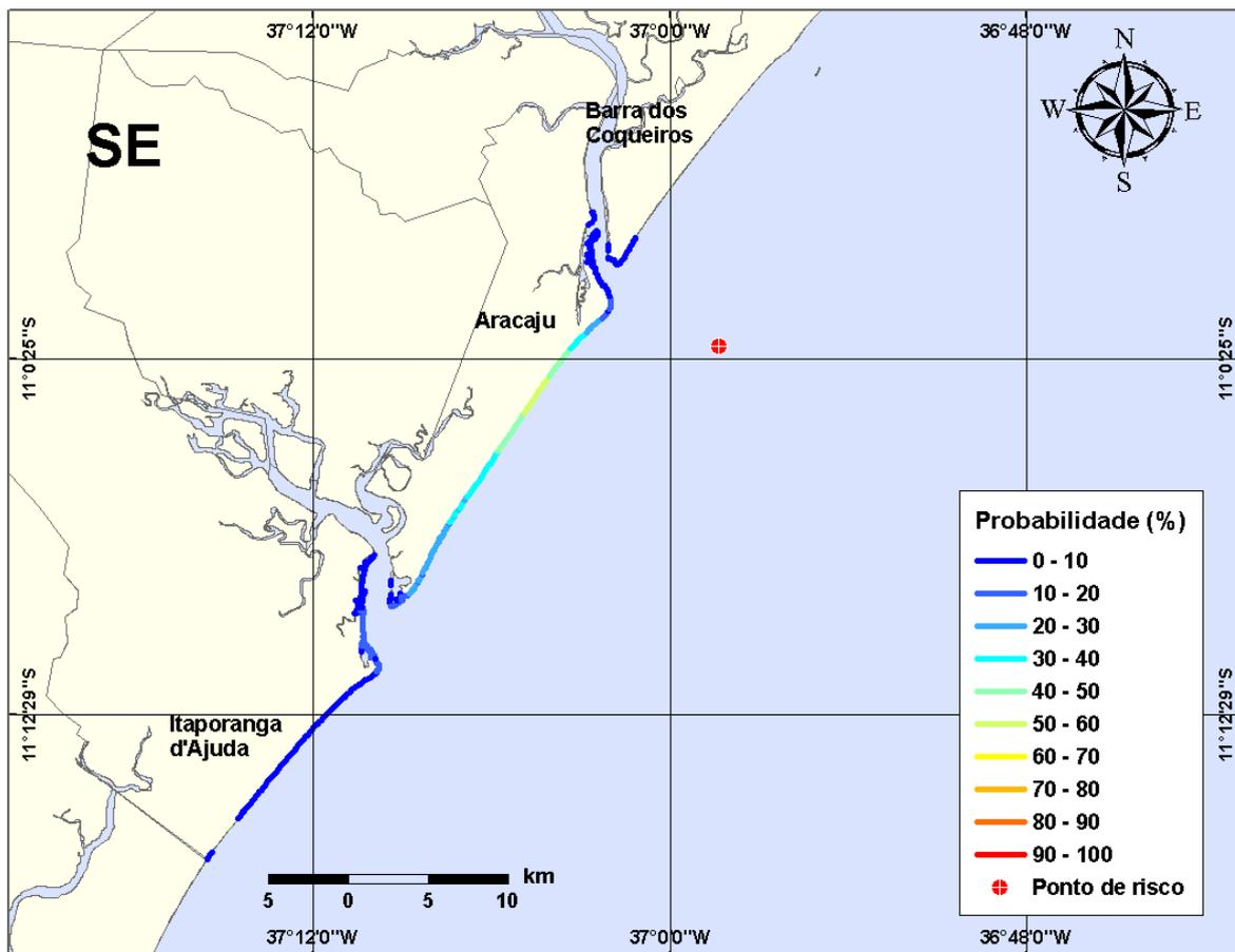
**Figura III-27** - Cenário PCM5\_VER\_200\_30D. (Fase: instalação). Linhas de probabilidade de óleo na costa para um acidente com óleo tipo CAMORIM, ocorrendo no Ponto-PCM5, do Campo Camorim, durante os meses de verão (janeiro a março), com derrame de 200 m<sup>3</sup> (instantâneo), após 30 dias de simulação.
