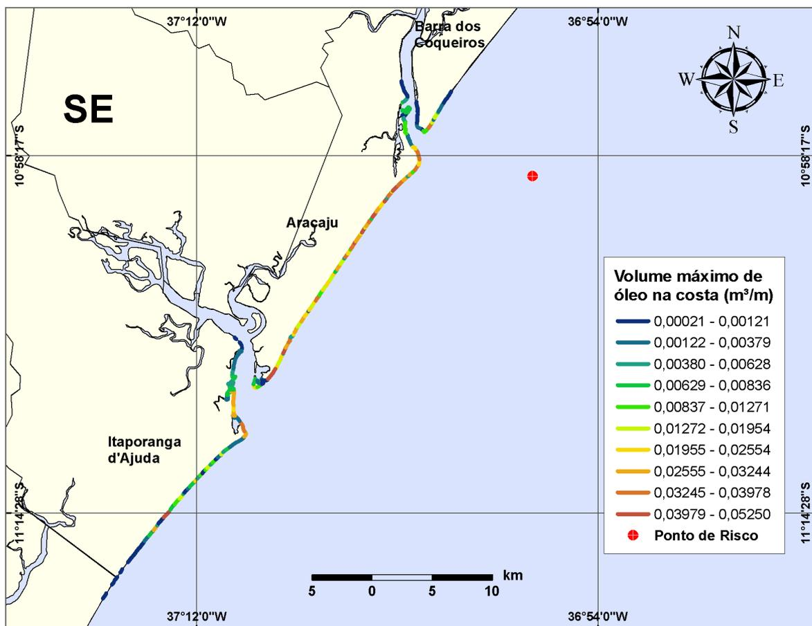
**Figura III-40** - Cenário PCM9\_VER\_248\_30D. (Fase: produção). Linhas de volume máximo de óleo na costa para um acidente com óleo tipo CAMORIM, ocorrendo no Ponto-PCM9, do Campo Camorim, durante os meses de verão (janeiro a março), com derrame de 248 m<sup>3</sup> (instantâneo), após 30 dias de simulação.
