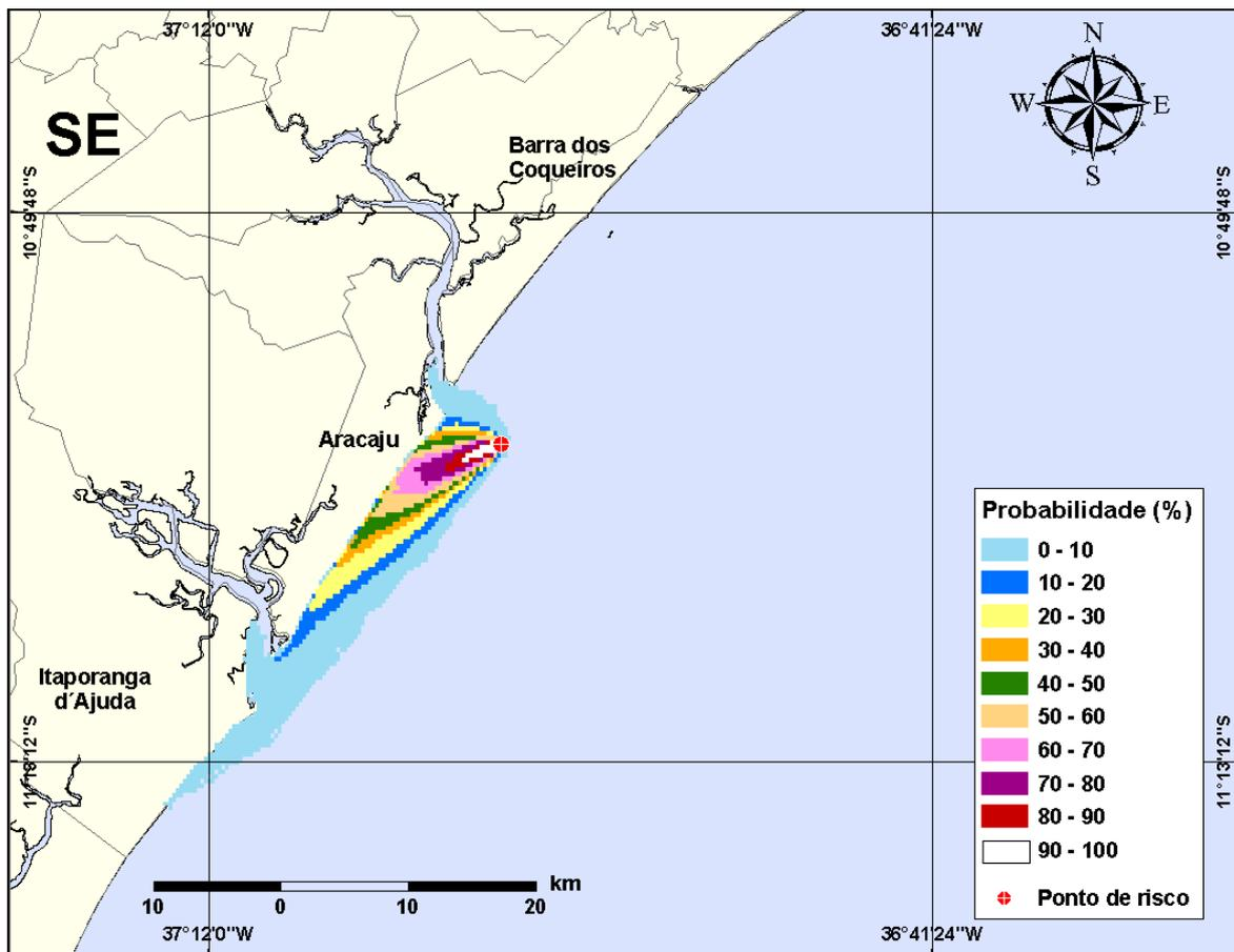
**Figura III-17** - Cenário PCM1\_VER\_200\_30D. (Fase: produção). Contornos de probabilidade de óleo na água para um acidente com óleo tipo CAMORIM, ocorrendo no Ponto-PCM1, do Campo Camorim, durante os meses de verão (janeiro a março), com derrame de 200 m<sup>3</sup> (instantâneo), após 30 dias de simulação.
