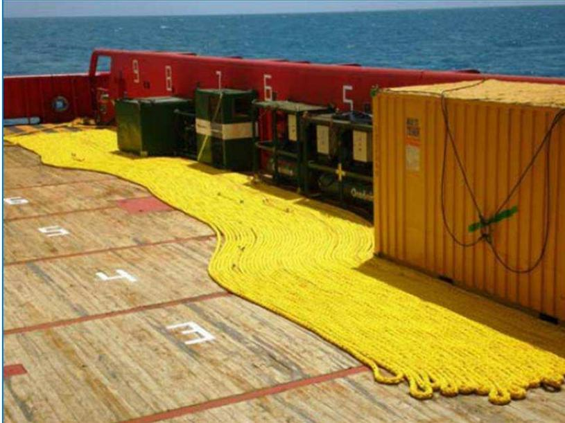
**Figura II.2.4-55** - Cabo flutuante de 2 ½" recolhido no rebocador
