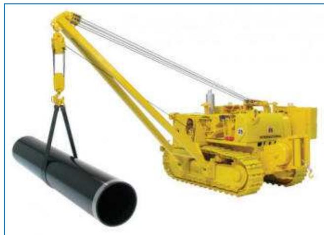
**Figura II.2.4-50** - Ilustração de máquina side boom, para movimentação de dutos.
