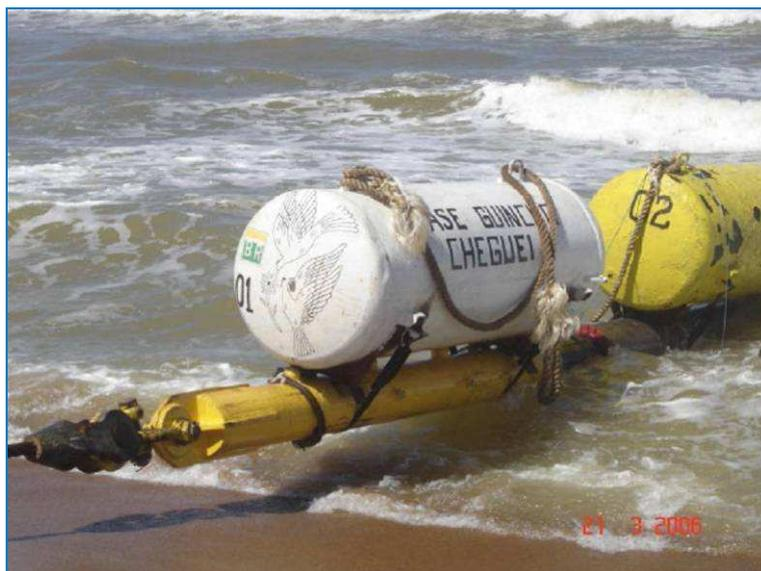
**Figura II.2.4-54** - Detalhe dos flutuadores metálicos.
