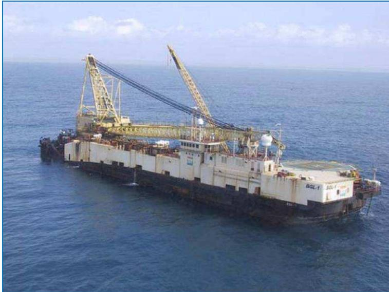
**Figura II.2.4-79 - Balsa Guindaste e Lançamento – 1 da
