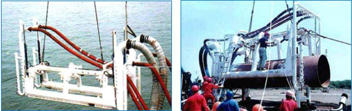
**Figura II.2.4-63** - Máquinas de enterramento do tipo hidrojateamento.
