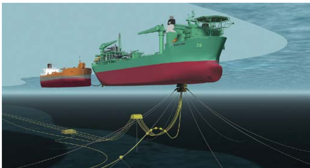
Figura 04-B Desenho esquemático dos poços produtores W-1, W-2 e W-3 produzindo para o FPSO OSX-1 — fase de Desenvolvimento da Produção. Fonte: OGX
