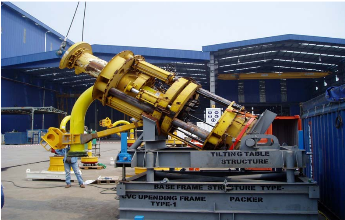
Figura 2.4-32. Ferramenta de instalação das linhas de fluxo. Fonte: Wellstream, 2010
