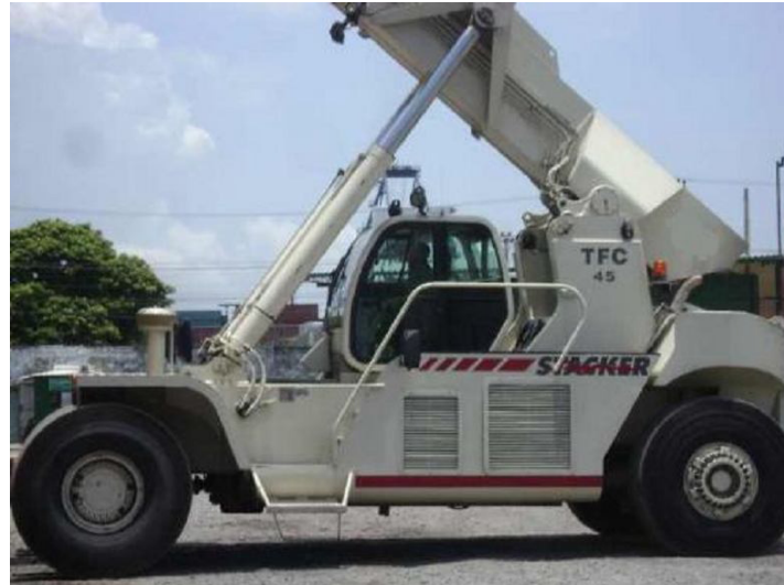
Figura 2.4-36. Guindaste do tipo Reach Stacker.
