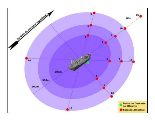
A malha amostral proposta procura identificar e dimensionar a presença da pluma do efluente da água produzida tanto horizontalmente quanto verticalmente, bem como verificar as possíveis alterações no compartimento água dentro dos 500 m do ponto de lançamento do efluente.
