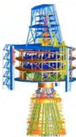
Figura I.1.1-4 - Vista isométrica típica da estrutura do Turret.
