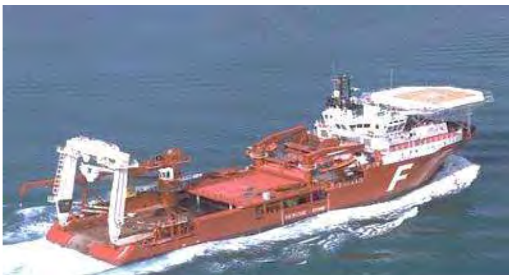
Figura II.2.4-81 - Embarcação de manuseio e instalação de âncoras.
