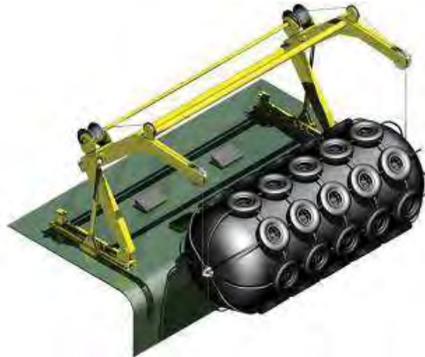
Figura II.2.4-51 - Dispositivo autônomo de manipulação de botes/balsas.
