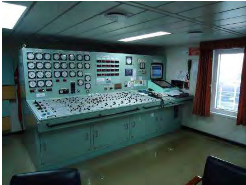
Figura II.2.4-36 - Centro de controle de carga.
