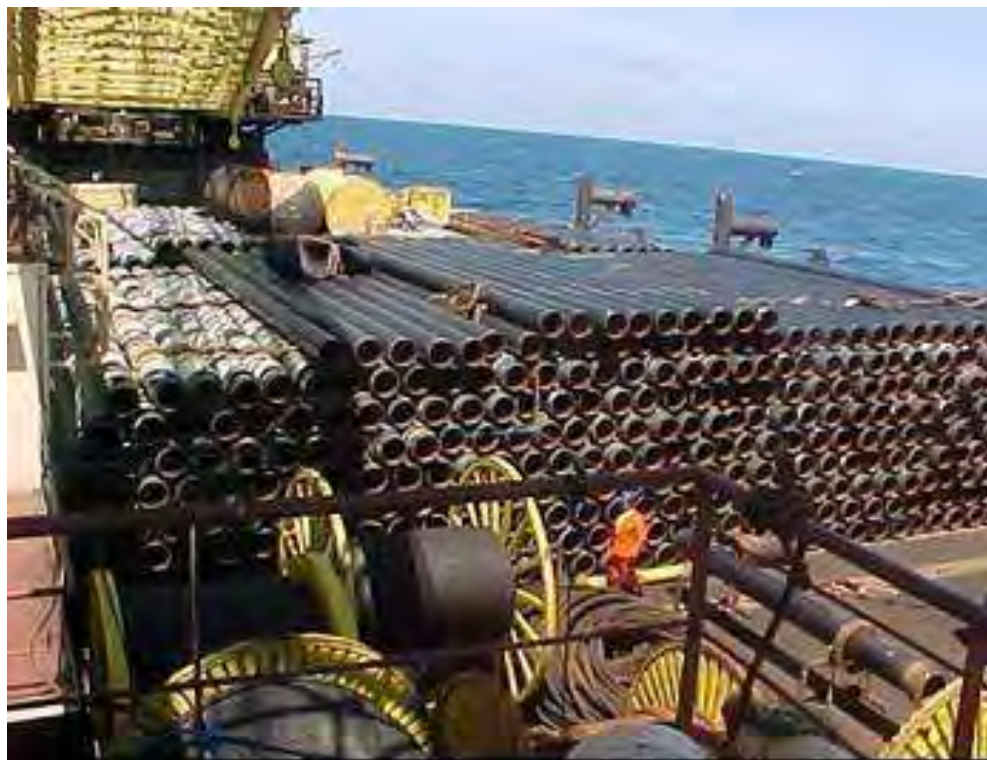
Figura II.2.4-70 - Tubos armazenados no convés de uma embarcação lançamento.
