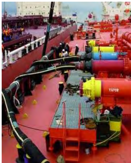
Figura II.2.4-24 - Ilustração das estações e mangotes de abastecimento.
