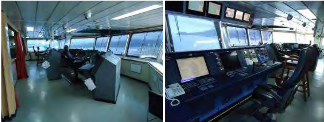
Figura II.2.4-38 - Centro de controle de manobras e de navegação. Fonte: Petrobras
