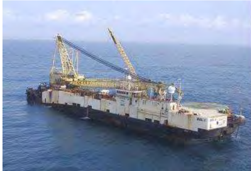
Figura II.2.4-79 - Balsa Guindaste e Lançamento – BGL-1.
