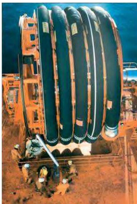
Figura II.2.4-15 - Ilustração mangote em carretel.
