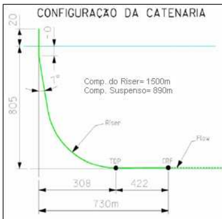
Figura II.8.1.3-1 - Configuração da catenária para a fase do TLD do poço 1-RJS-661.
