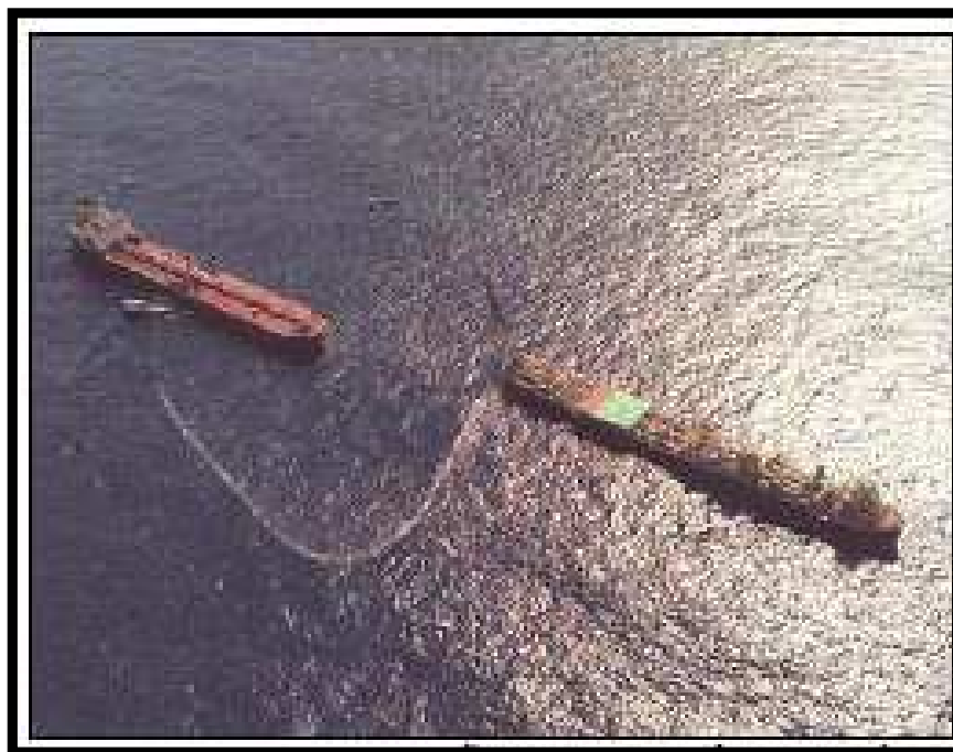
Figura II.8.1.2-4 - Exemplo de operação de transferência de óleo in tandem .
