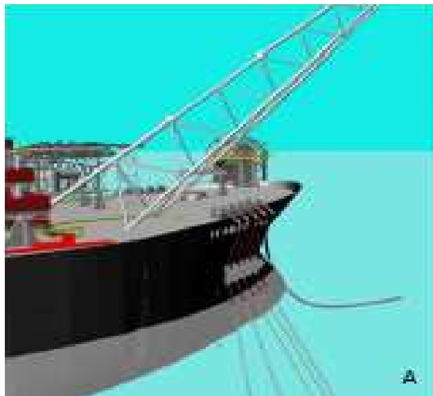
Figura II.8.1.2-5 - Ilustração do sistema de mangotes de offloading instalado na proa do FPSO.
