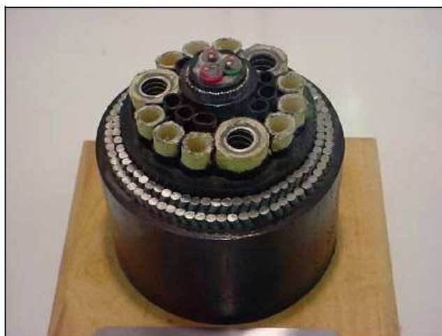
Figura II.8.1.3-3 - Vista da seção transversal de um Umbilical Eletro-Hidráulico. Fonte: PETROBRAS.
