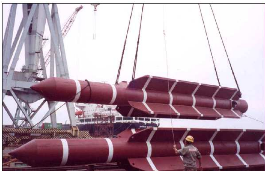
Figura II.8.1.6-1 - Estaca do tipo torpedo a ser utilizada na ancoragem do FPSO Petrojarl Cidade de Rio Das Ostras.
