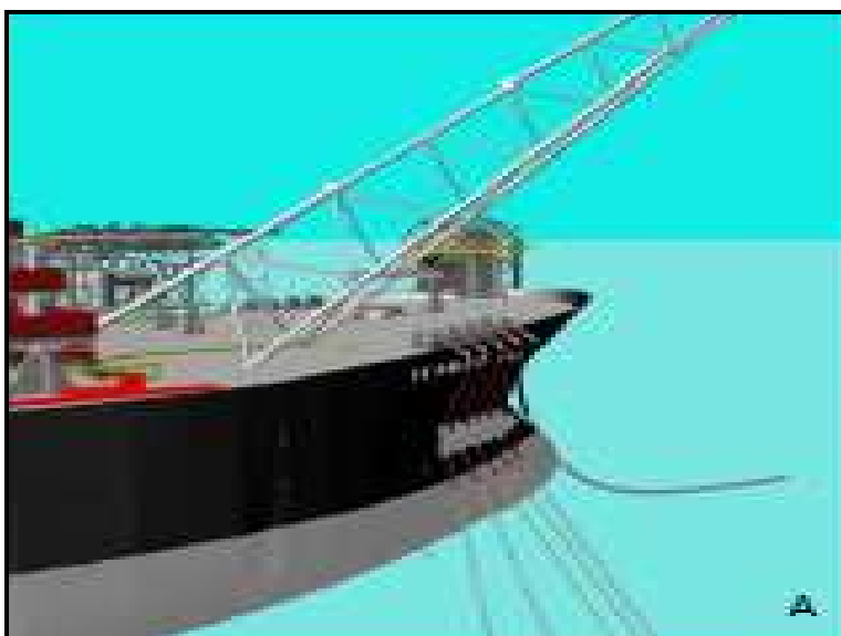
Figura II.8.1.5-4 - Ilustração do sistema de mangotes de offloading instalado na proa do FPSO.
