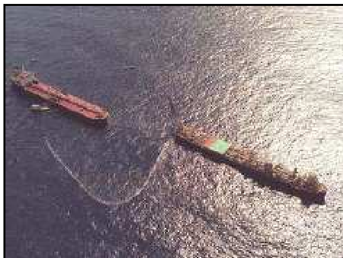
Figura II.8.1.5-3 - Exemplo de operação de Transferência de óleo in tandem.
