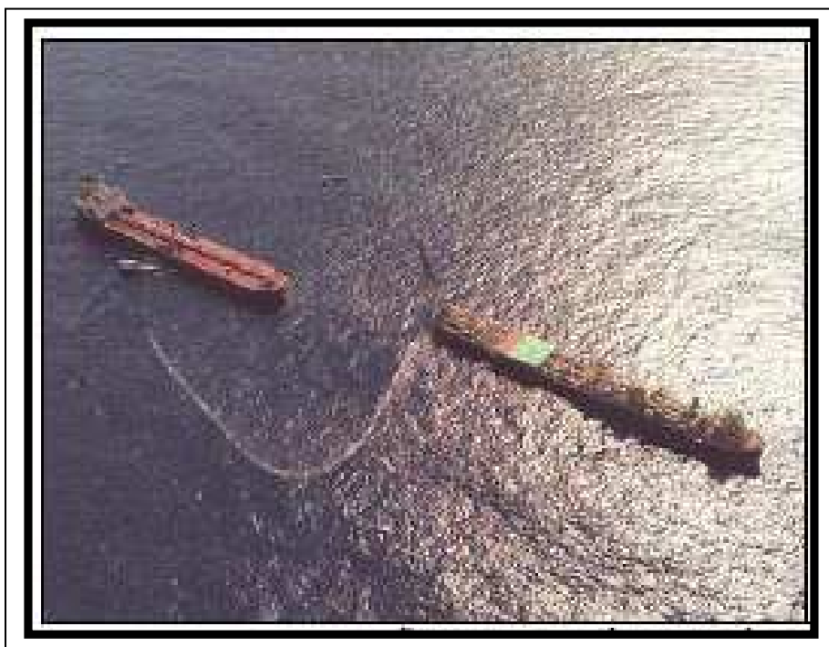
Figura II.2.4.2-5 - Exemplo de operação de transferência de óleo in tandem.
