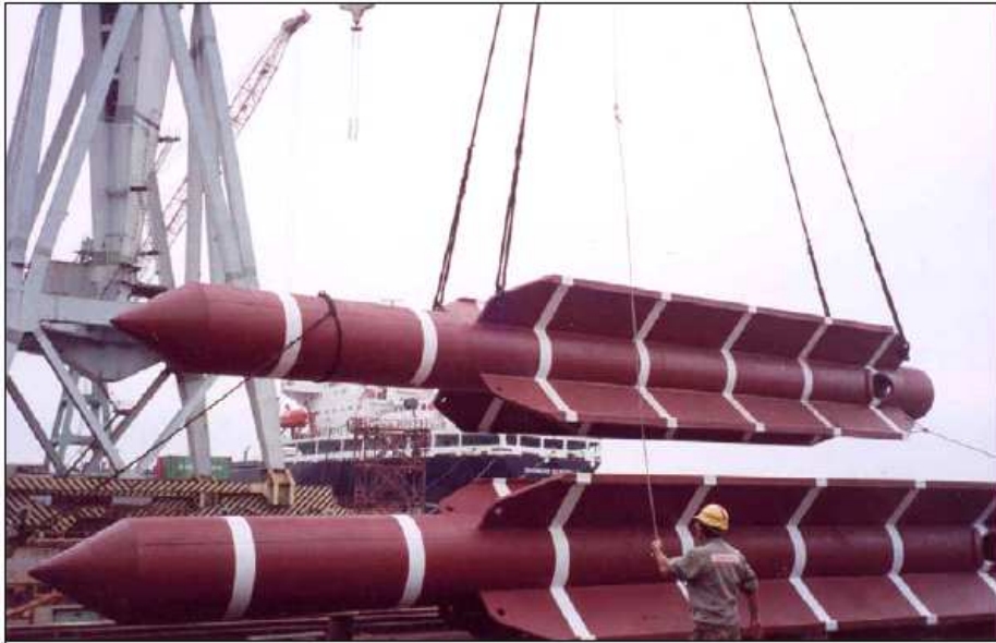
Figura II.2.4.3-1 - Estaca do tipo torpedo a ser utilizada na ancoragem do FPSO Petrojarl Cidade de Rio das Ostras
