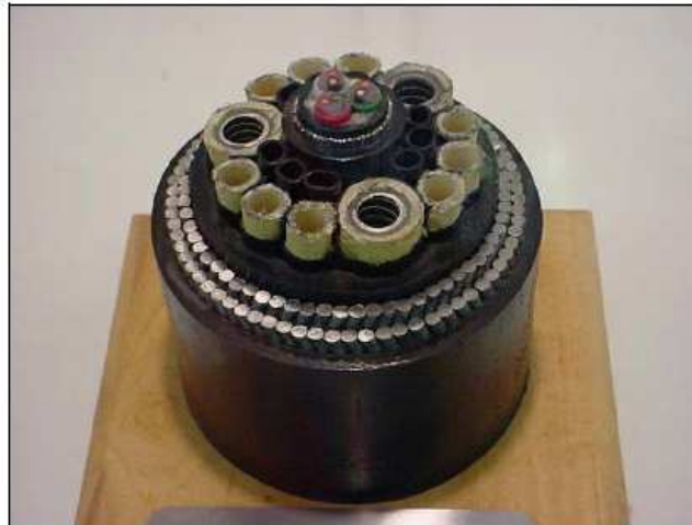
Figura II.2.4.6-3 - Vista da seção transversal de um Umbilical Eletro-Hidráulico. Fonte: PETROBRAS.
