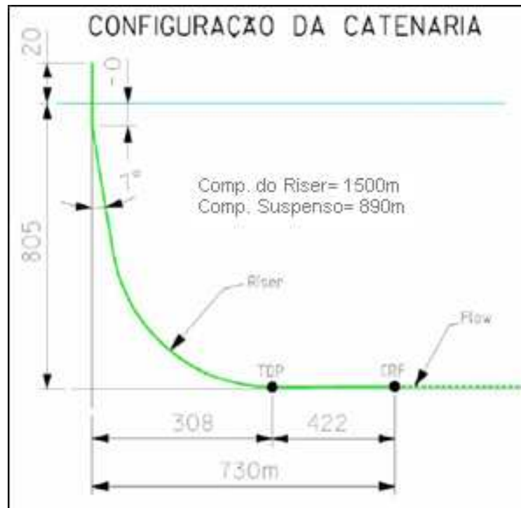
Figura II.2.4.6-1 - Configuração da catenária para a fase do TLD do poço 1-RJS-661.
