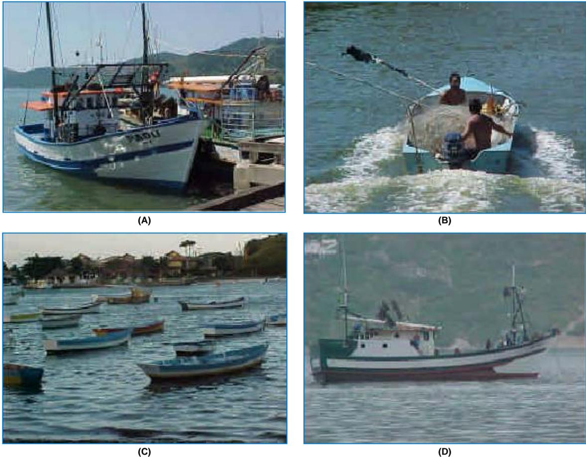
**Figura II.5.3-14** - Tipos de embarcações pesqueiras do estado do Rio de Janeiro: (a) Arrasteiro (b) Baleeira, (c) Canoas, (d) Barco de espinhel.
