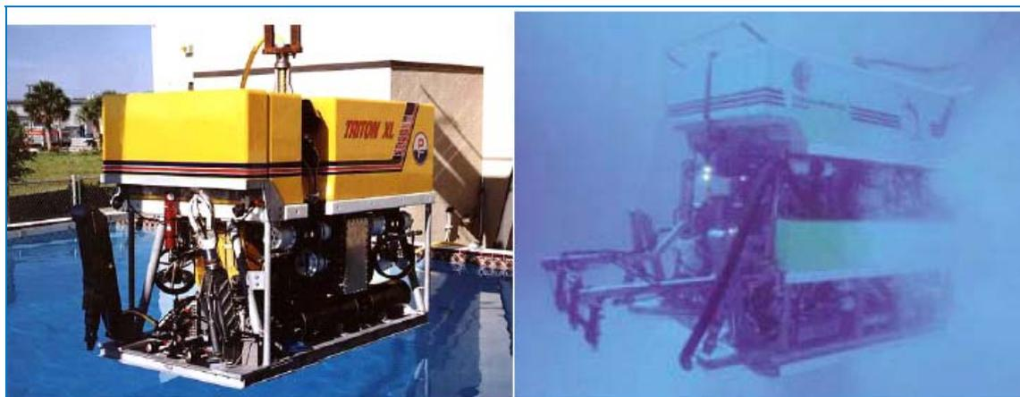
**Figura II.2-22** - Foto ilustrativa de veículo de operação remota (ROV) antes de lançamento (à esquerda) e em operação (à direita).
