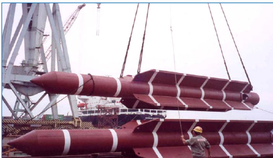
**Figura II.2-9 - Estaca do tipo torpedo**
