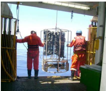
Foto 48 - Lançamento de equipamento para coleta de amostras de água do mar próximo a plataforma de Enchova – PCE-1 (Foto: Analytical Solutions S/A)
