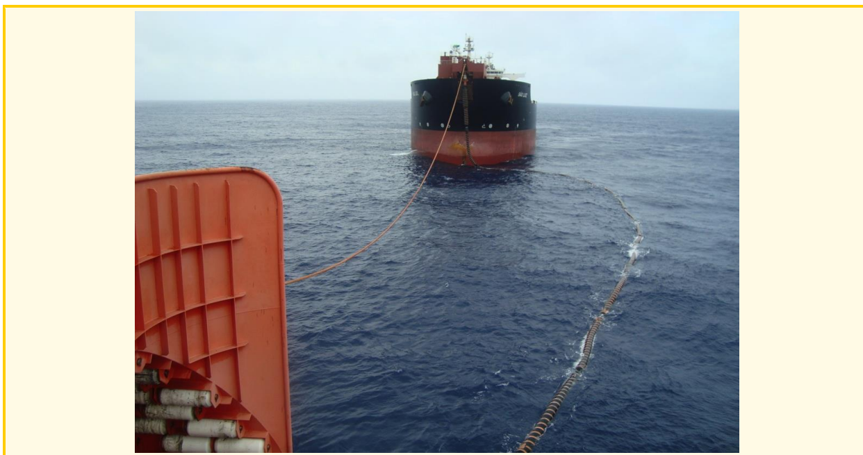
Figura 3 - Exemplo de operação de transferência de óleo ( offloading ).
