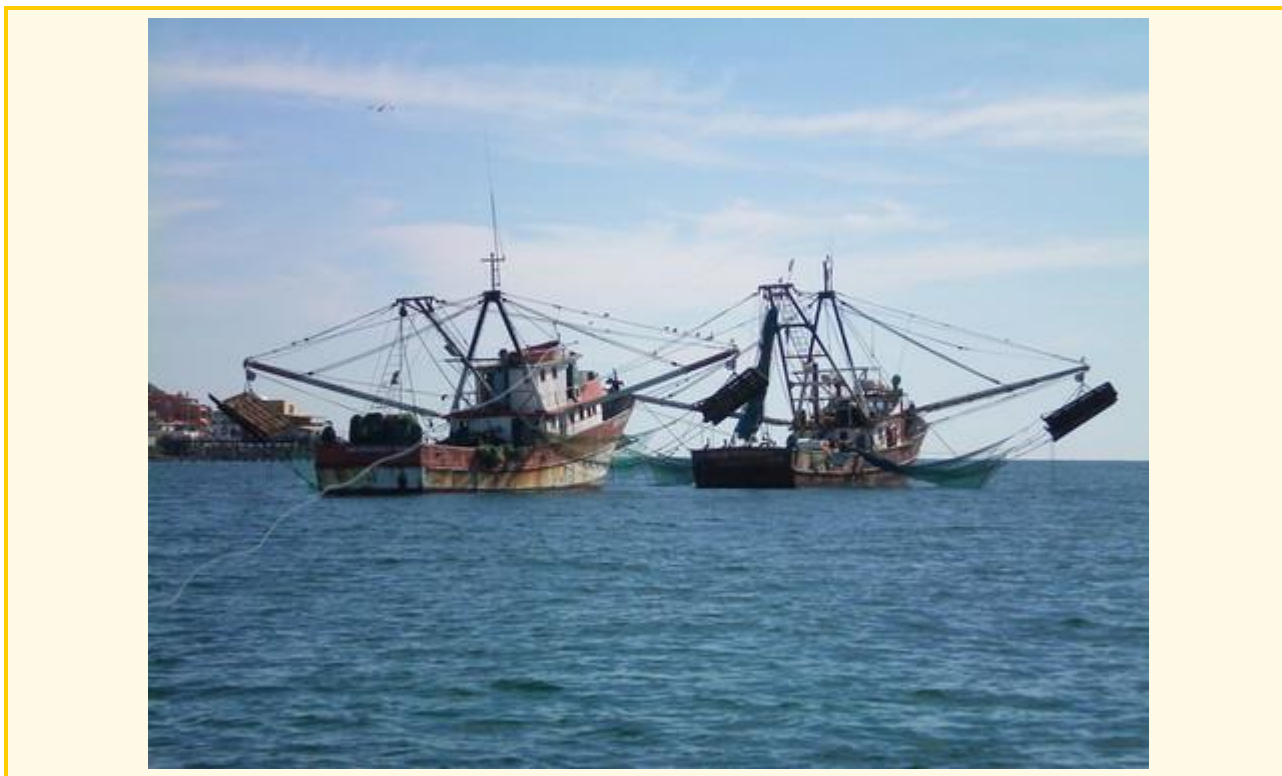
Figura 20 - Embarcações de frota permissionada para a captura de arrasto duplo, utilizado para a pesca do camarão-rosa.
