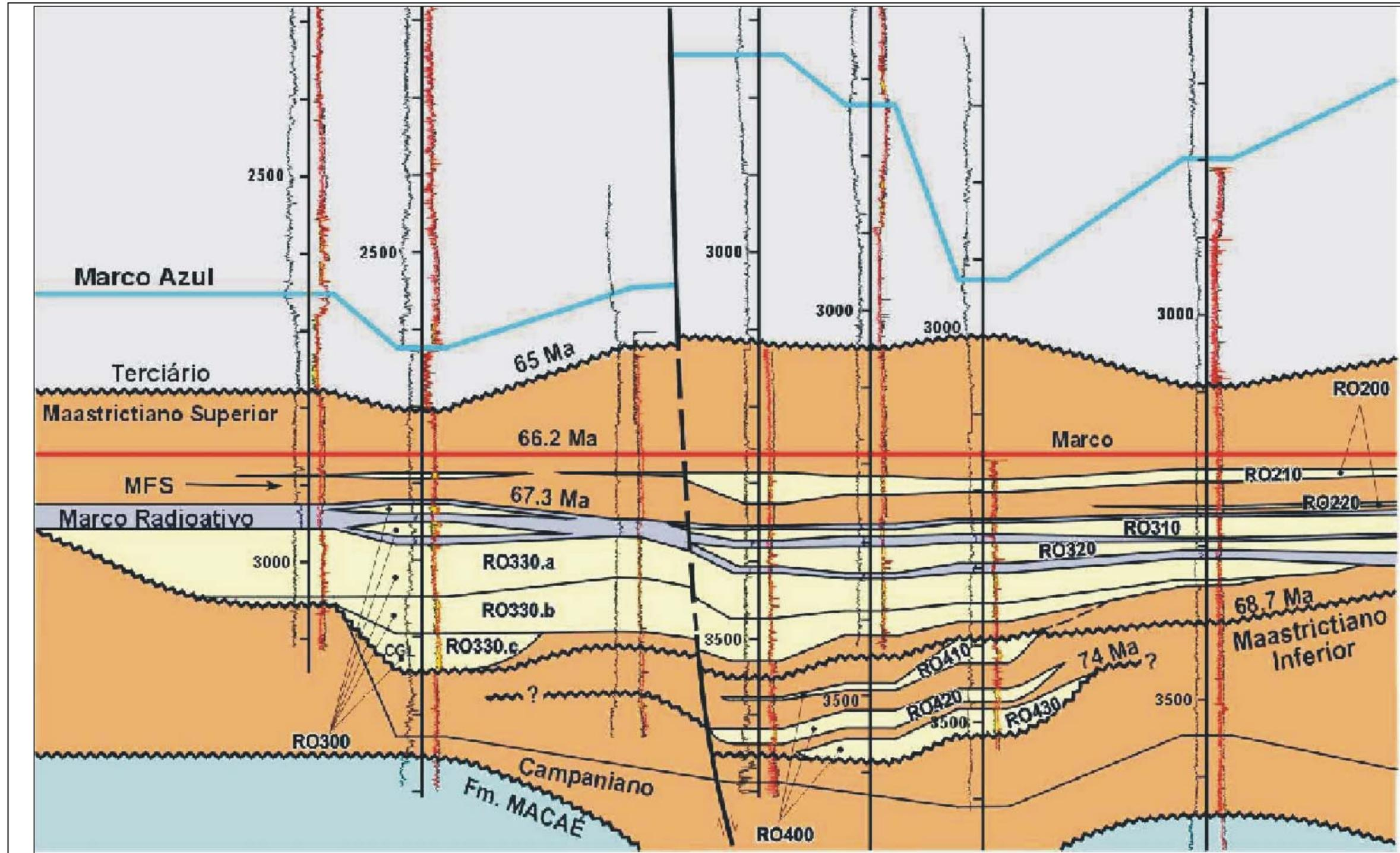
Figura 5.1.5.2-2. Seção Estratigráfica Esquemática do Campo de Roncador (PETROBRAS)
